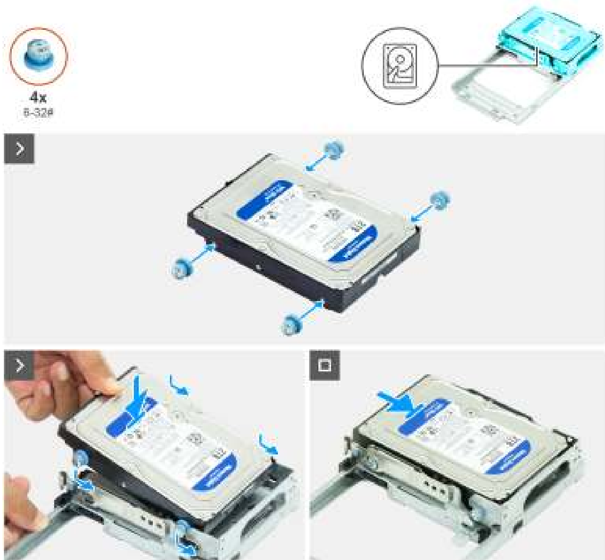
Afbeelding 30. De harde schijf plaatsen
