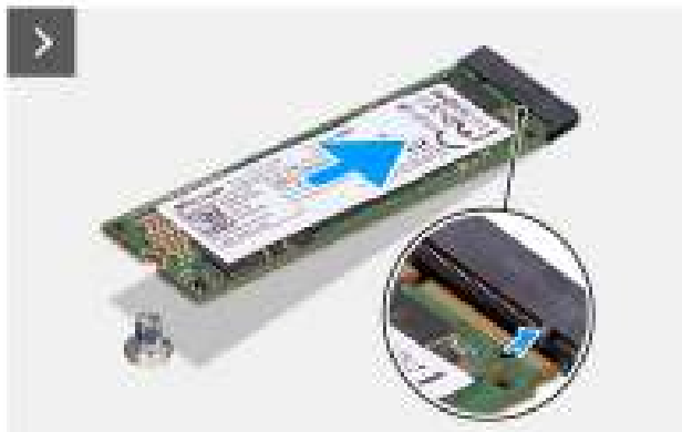
Afbeelding 38. De M.2 2280 SSD installeren
