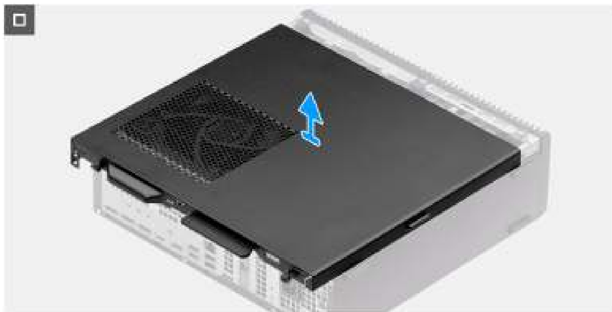
Afbeelding 10. De zijplaat verwijderen
