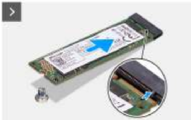
Afbeelding 36. De M.2 2280 SSD installeren
