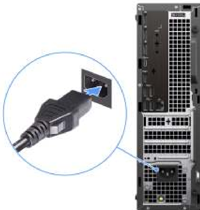
Afbeelding 6. De voedingskabel aansluiten
