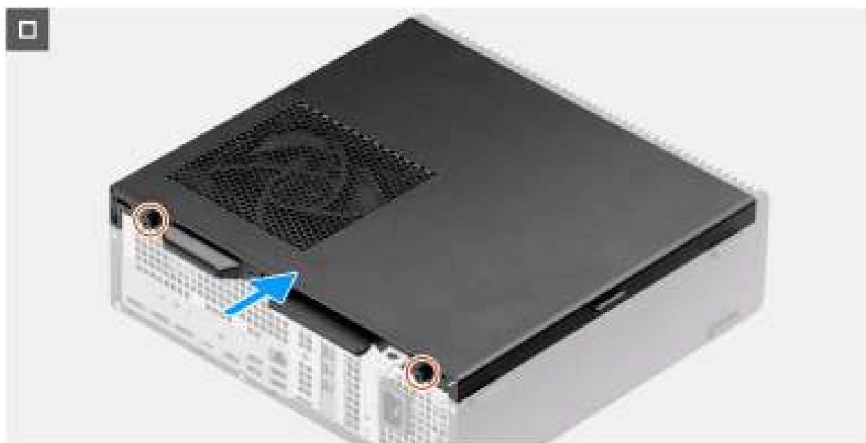
Afbeelding 12. De zijplaat plaatsen
