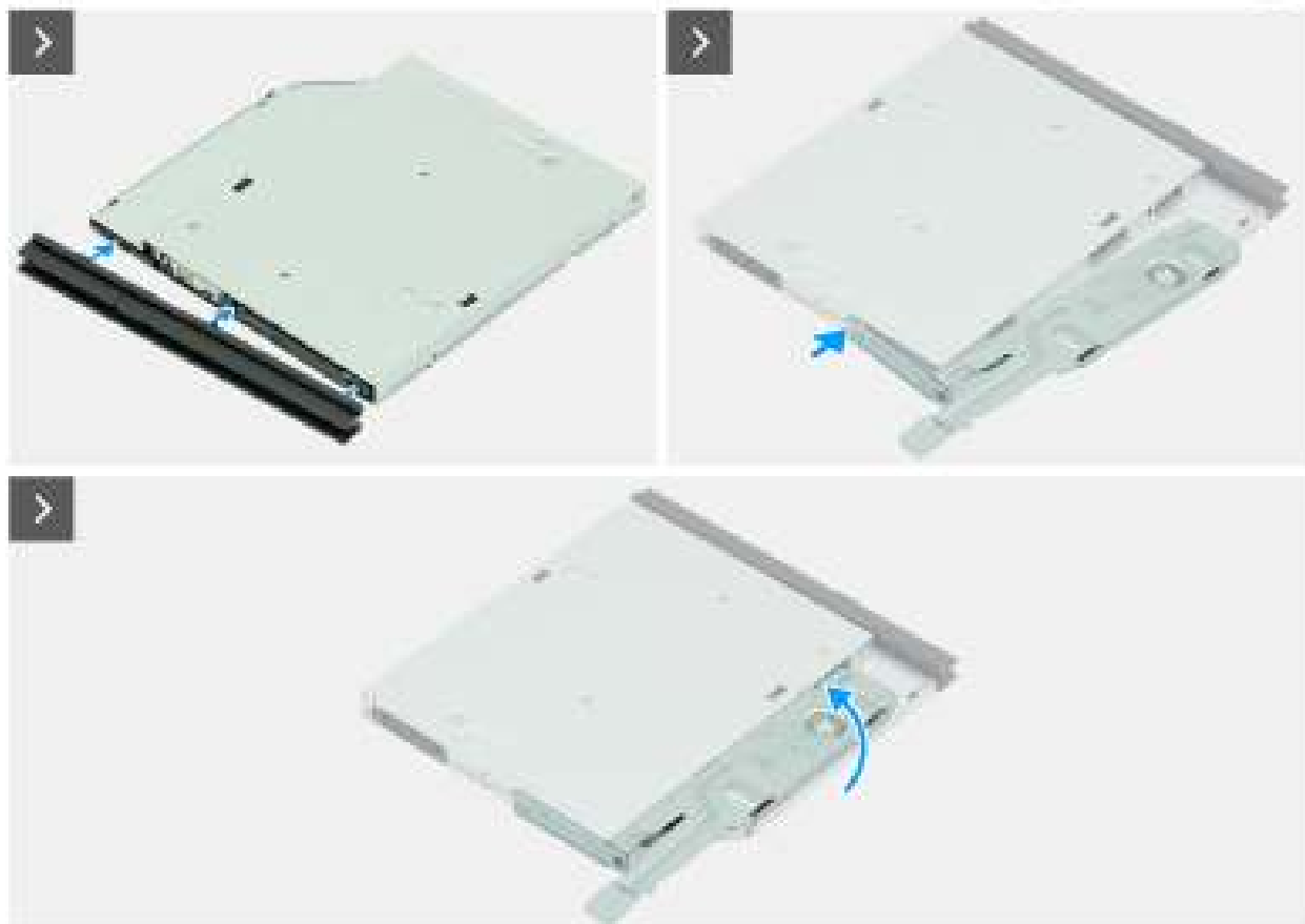
Afbeelding 19. Het optisch station plaatsen
