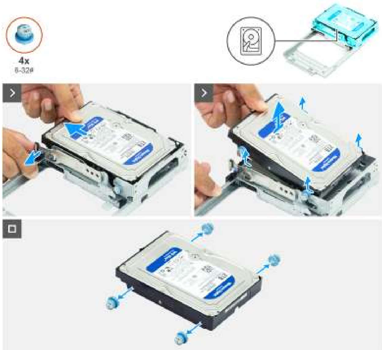
Afbeelding 29. De harde schijf verwijderen
