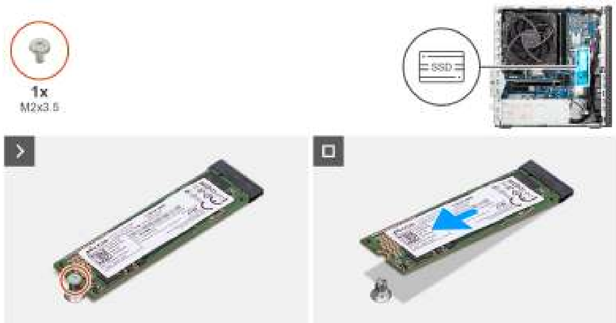
Afbeelding 37. De M.2 2280 SSD verwijderen
