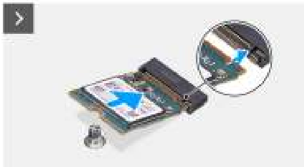
Afbeelding 34. De M.2 2230 SSD in slot 1 installeren
