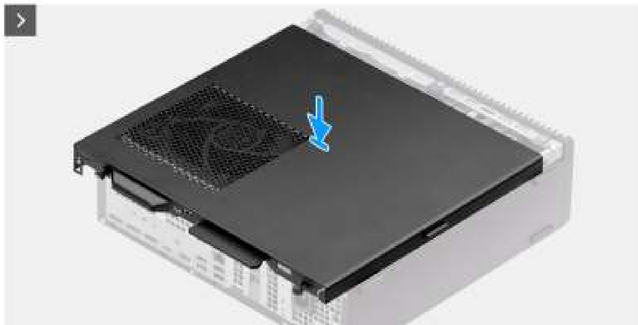
Afbeelding 11. De zijplaat plaatsen
