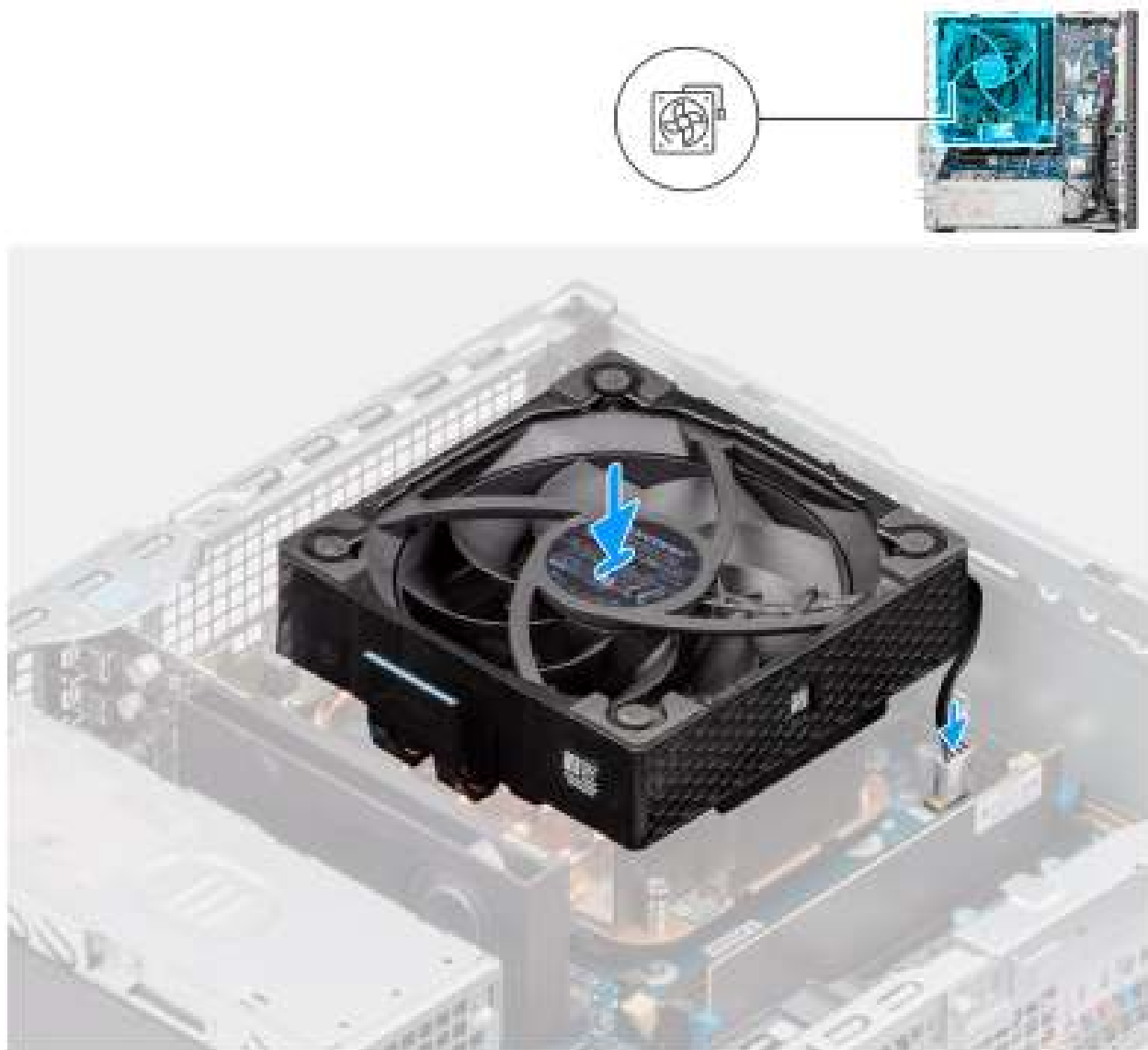
Afbeelding 52. De processorventilator installeren
