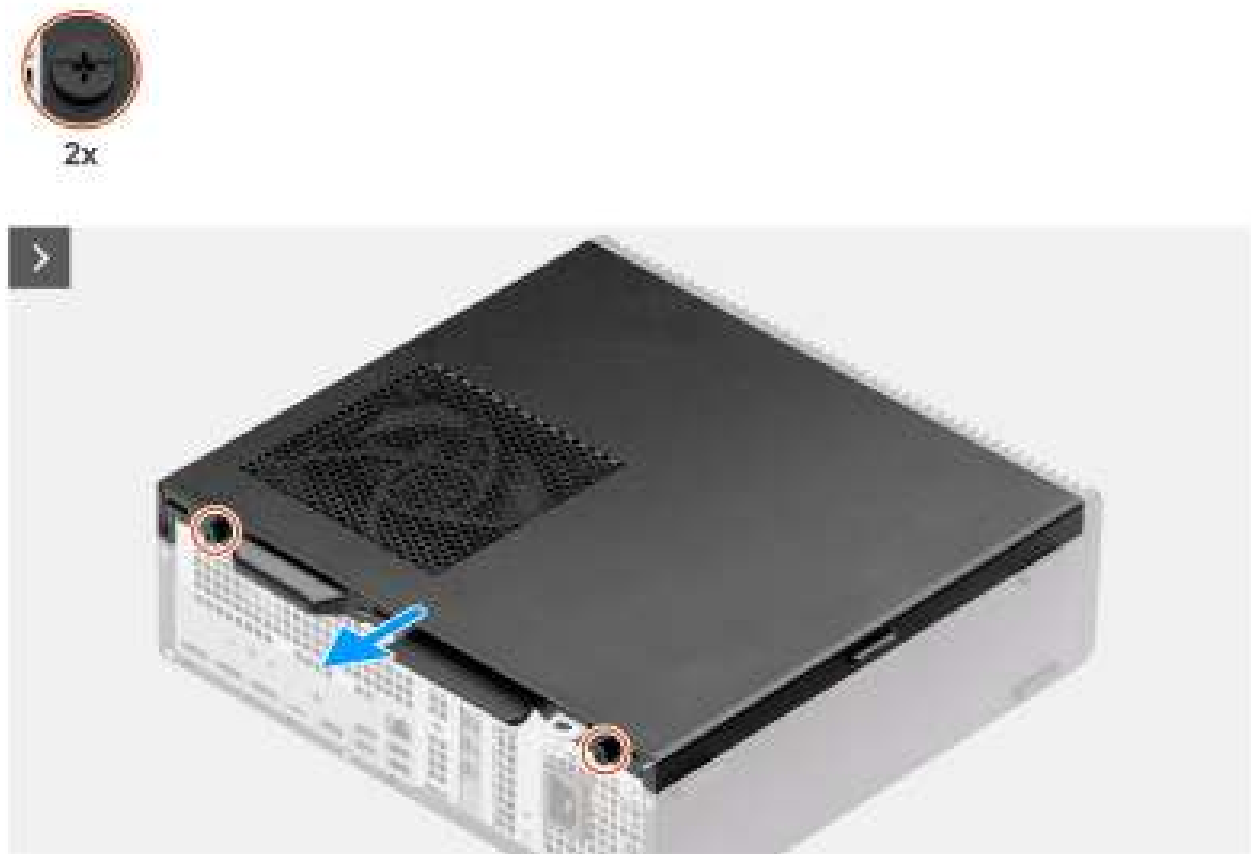
Afbeelding 9. De zijplaat verwijderen
