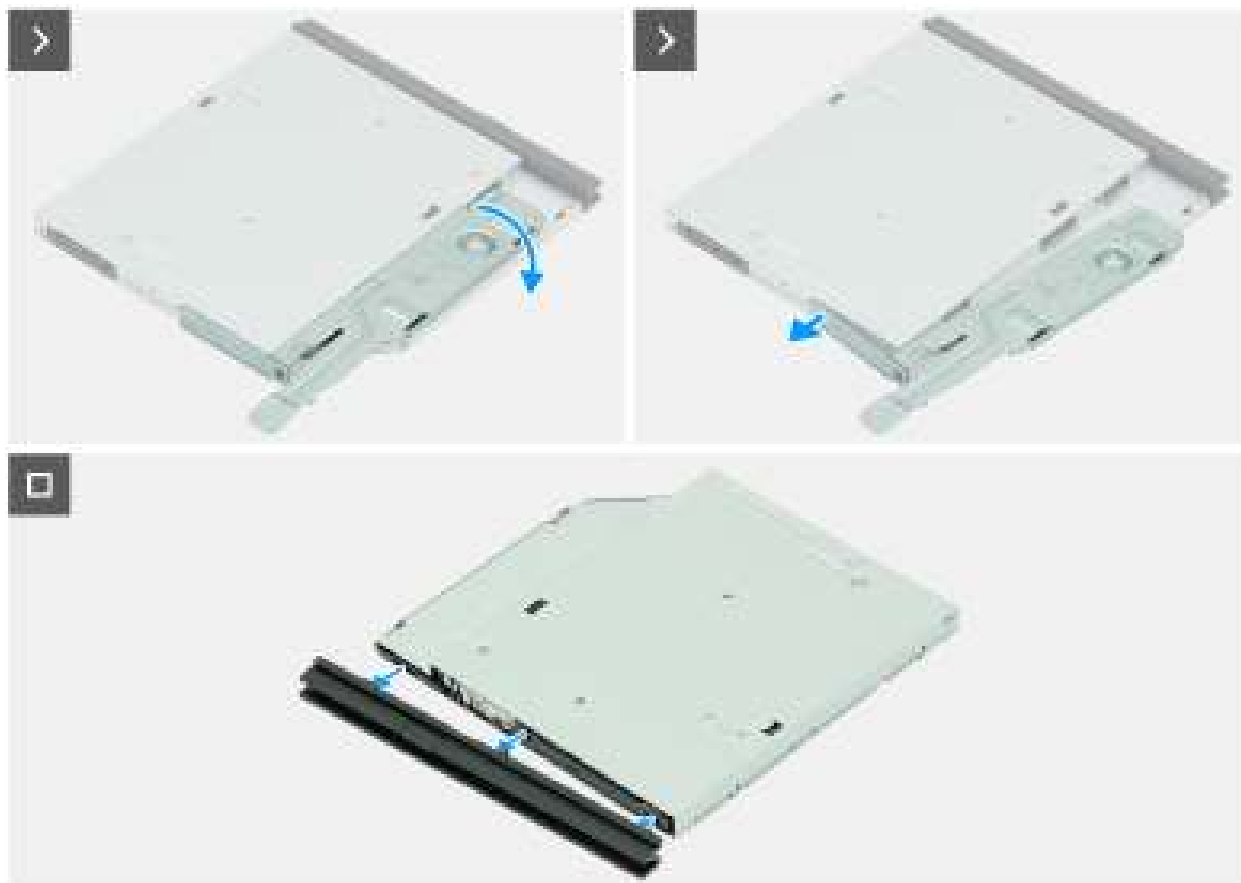
Afbeelding 18. Het optische station verwijderen
