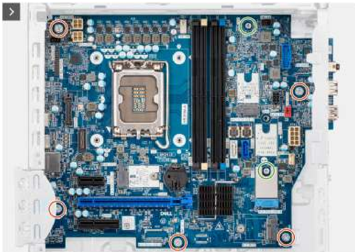
Afbeelding 89. De systeemkaart installeren
