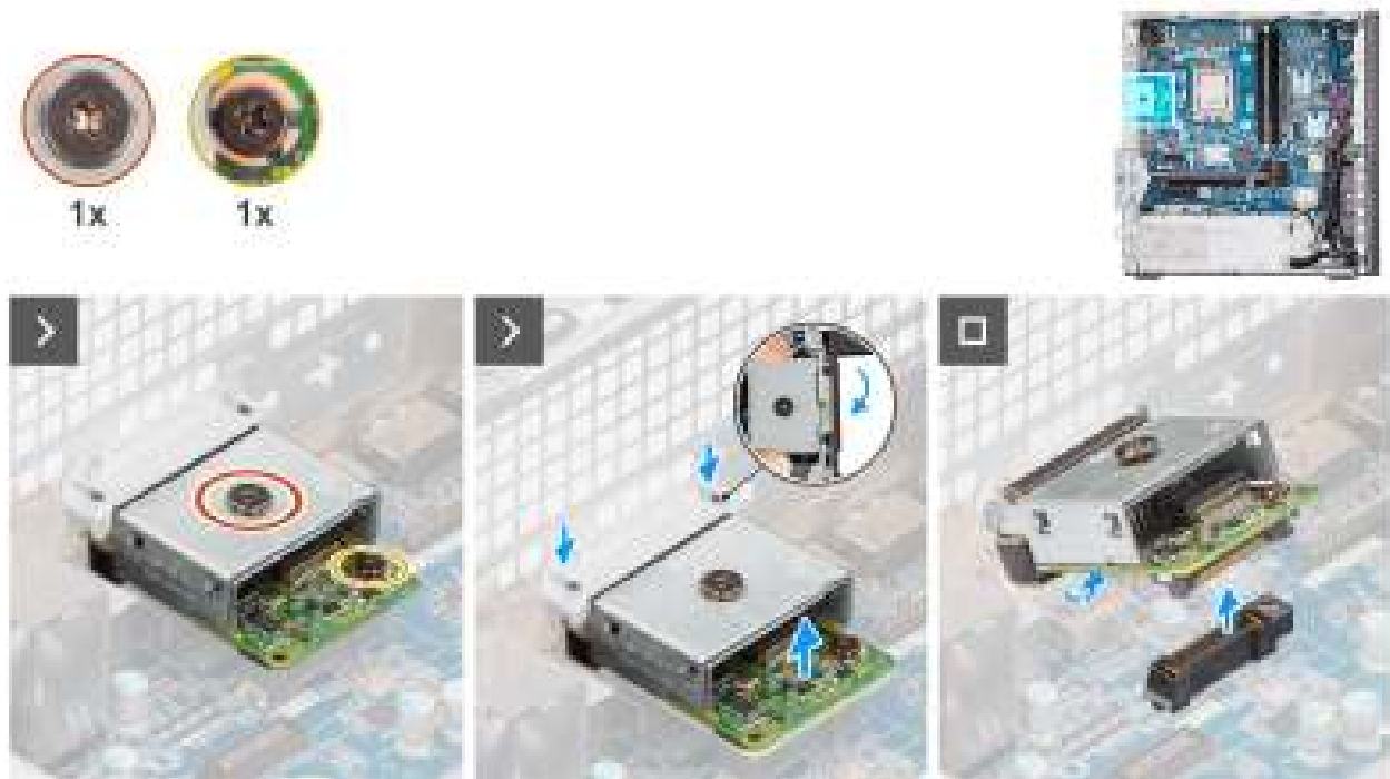
Figure 70. Removing the optional LAN module
