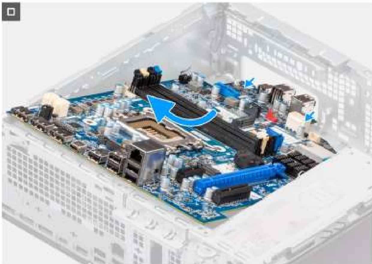
Afbeelding 86. De systeemkaart verwijderen
