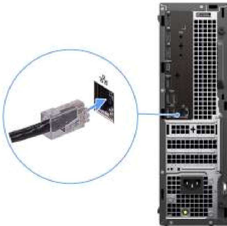
Afbeelding 4. De netwerkkabel aansluiten
