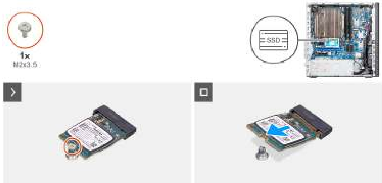
Afbeelding 33. De M.2 2230 SSD verwijderen
