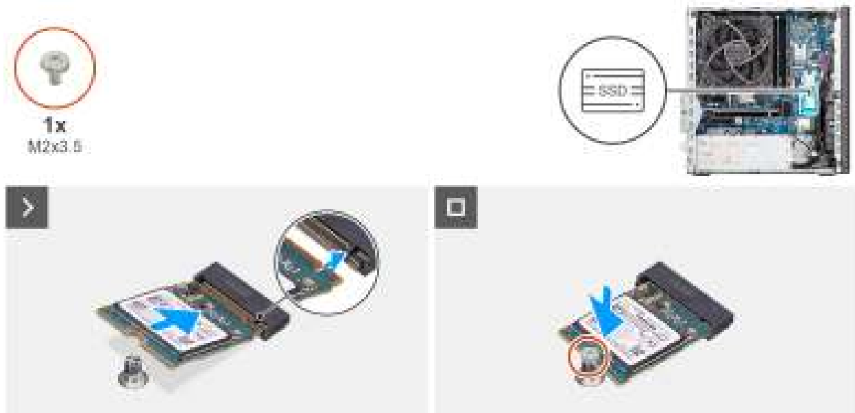
Afbeelding 32. De M.2 2230 SSD in slot 0 installeren
