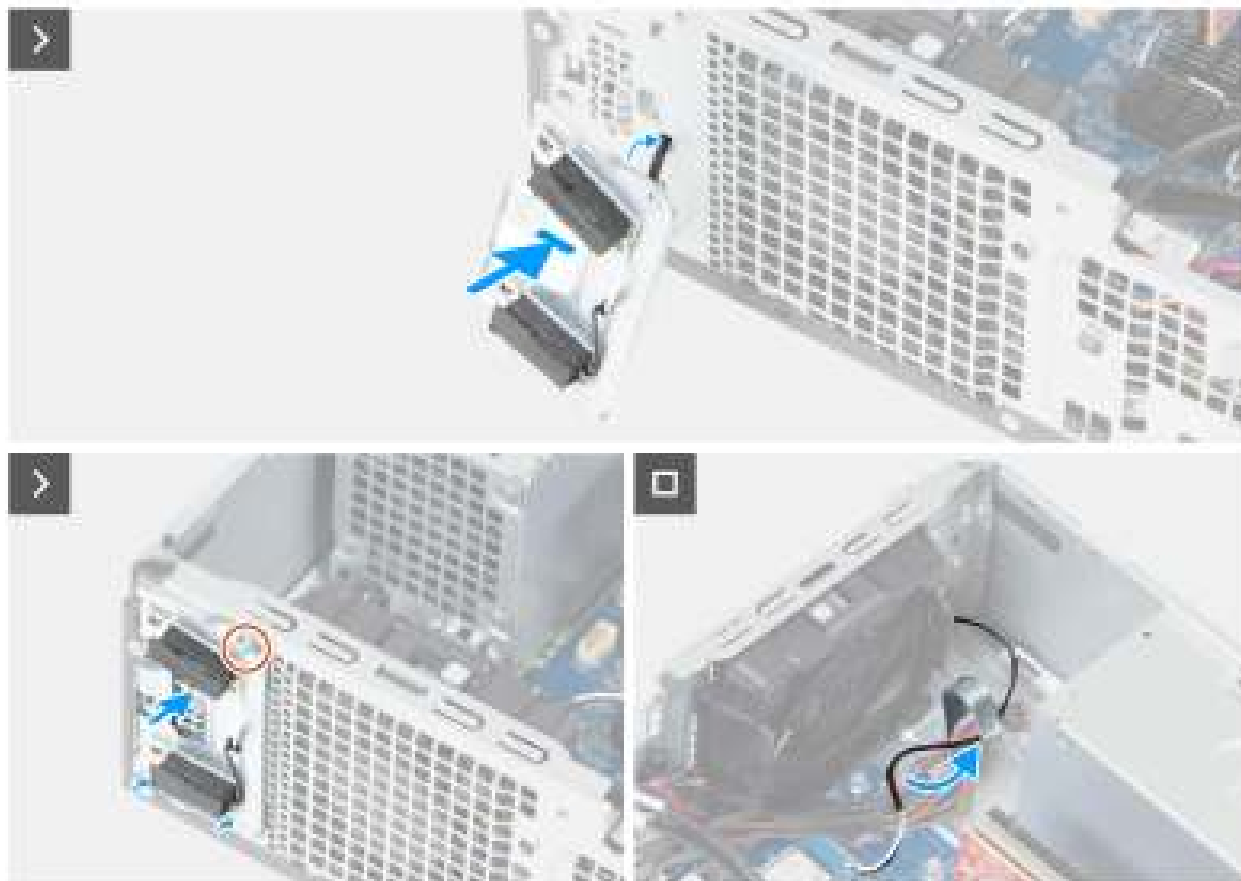
Afbeelding 50. De antennemodule plaatsen
