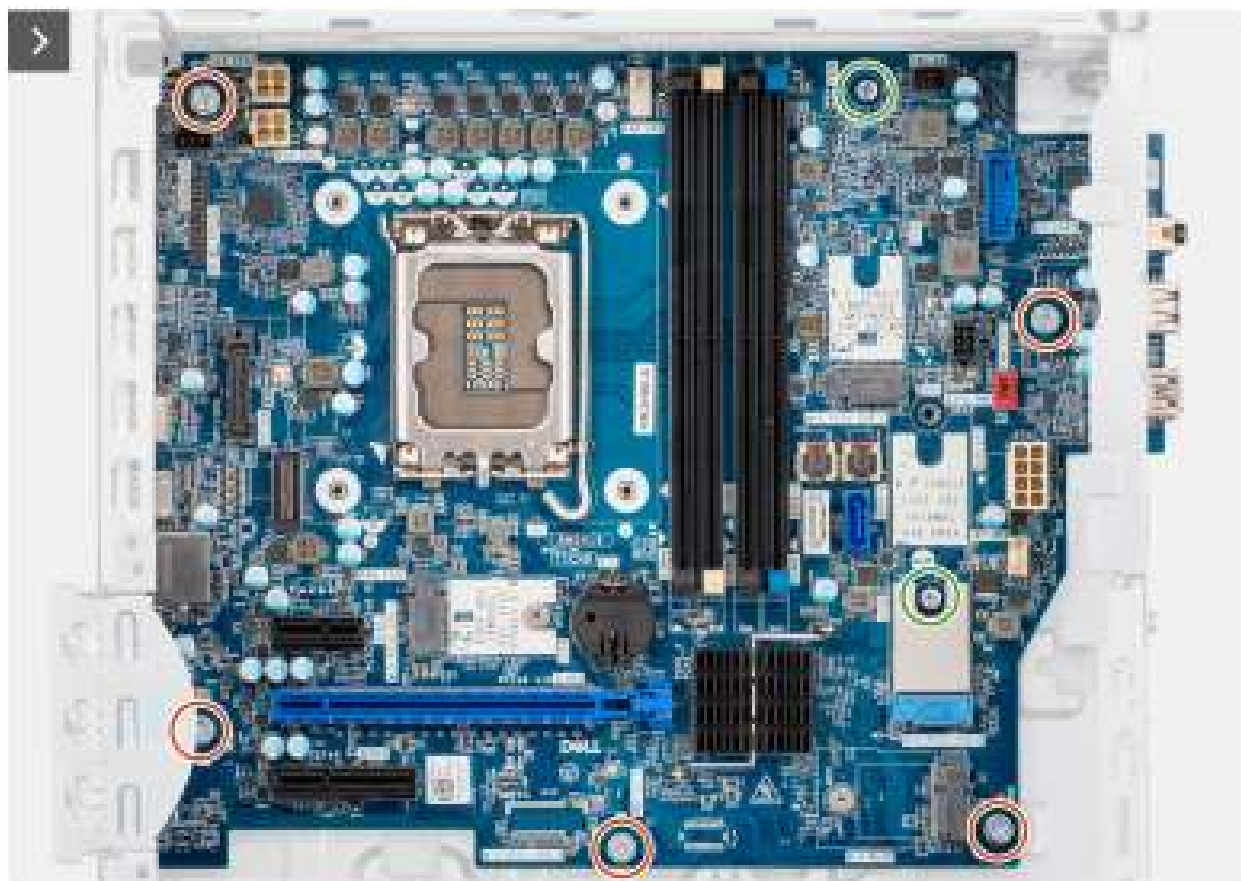
Afbeelding 85. De systeemkaart verwijderen
