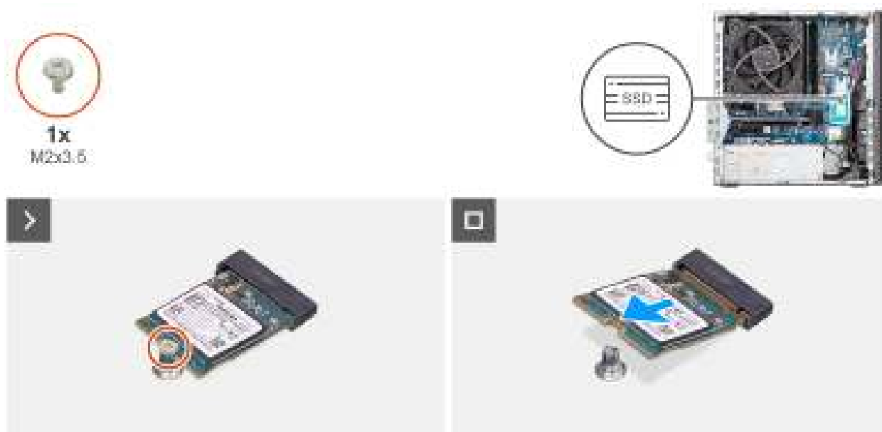
Afbeelding 31. De M.2 2230 SSD verwijderen
