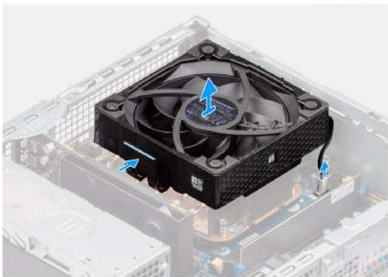
Afbeelding 51. De processorventilator verwijderen
