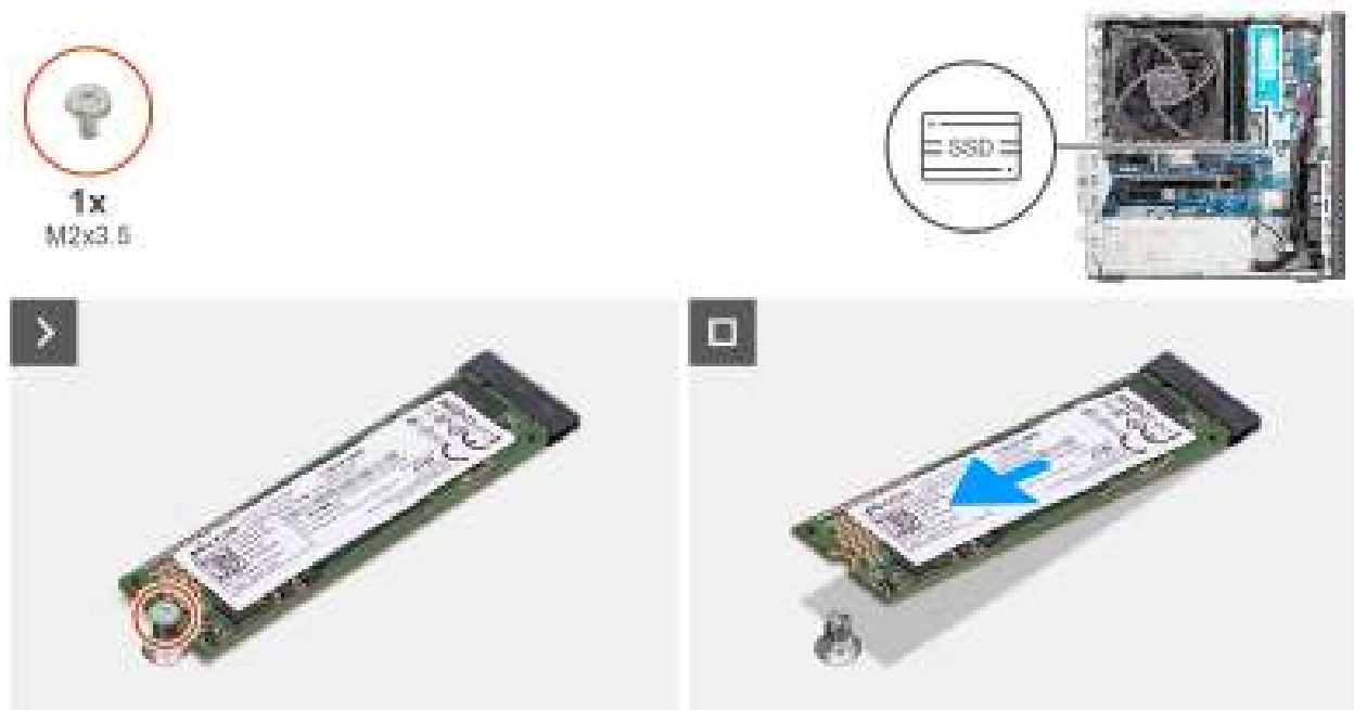
Afbeelding 35. De M.2 2280 SSD verwijderen
