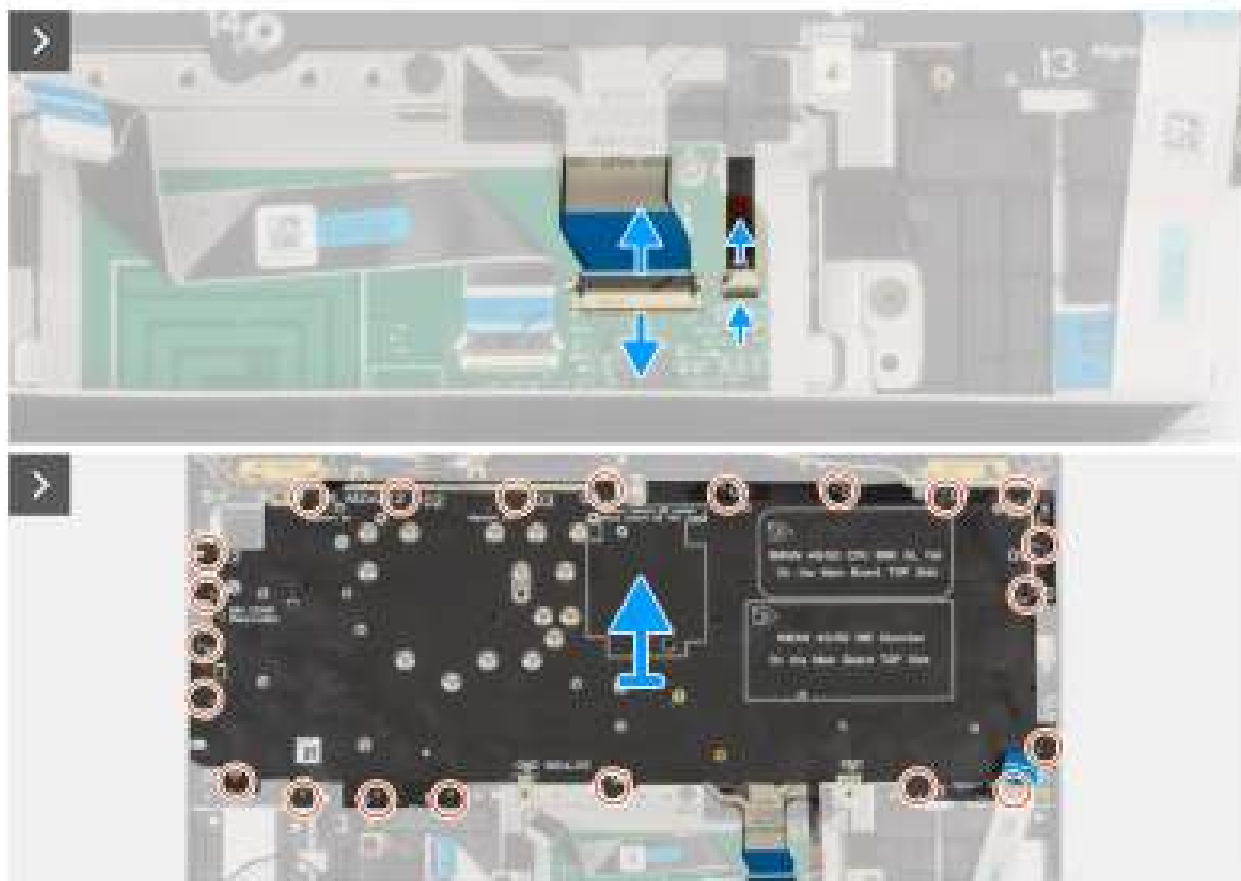
Afbeelding 58. Het toetsenbord verwijderen
