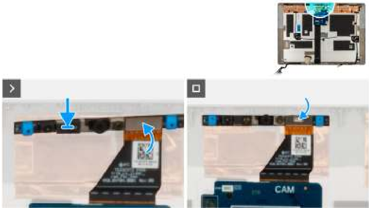
Afbeelding 39. De kabel van het cameramoduledisplay installeren
