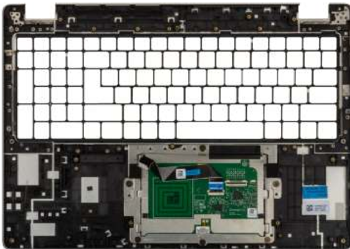
Afbeelding 62. De palmsteuneenheid installeren
