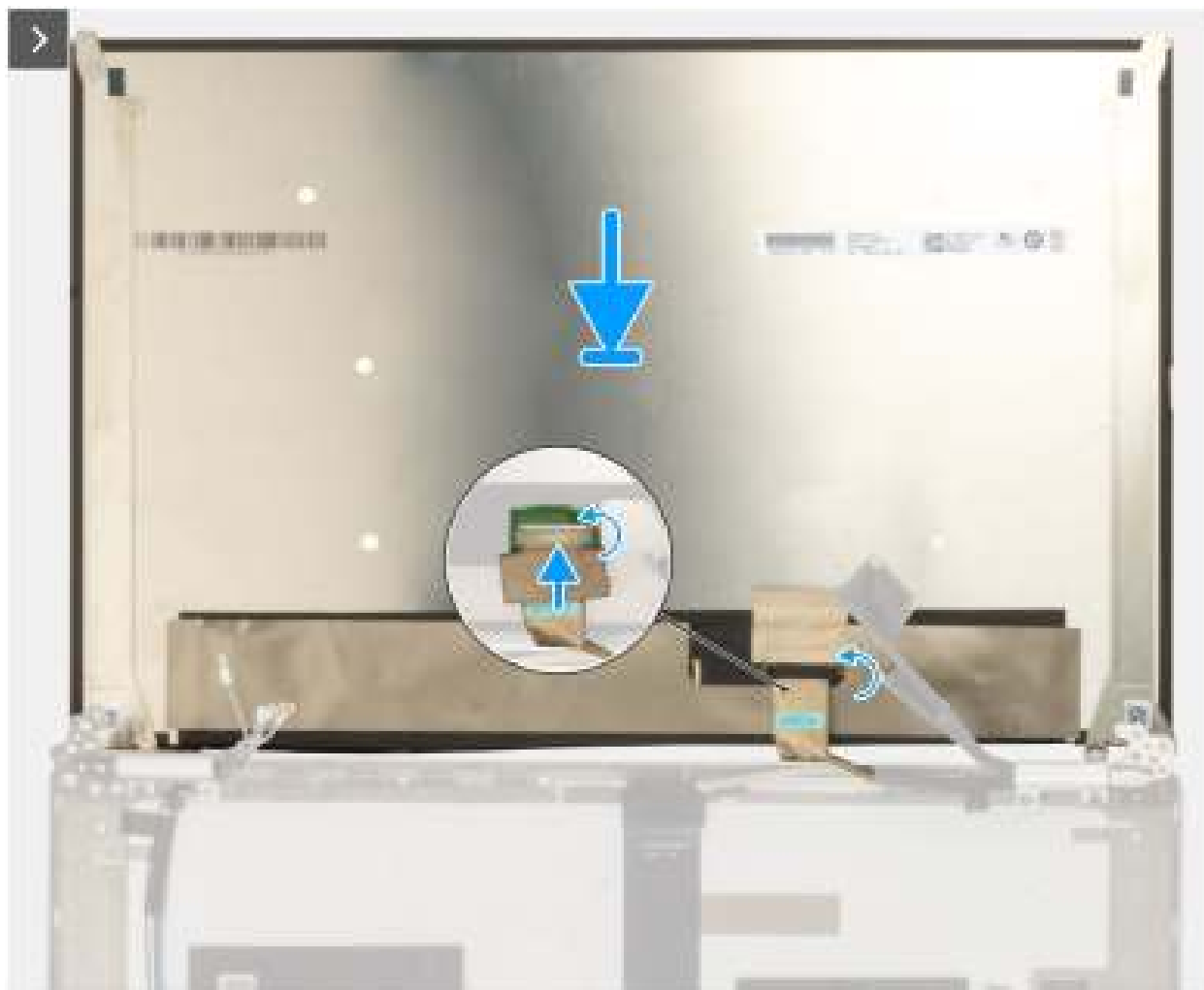
Afbeelding 32. Het beeldschermpaneel installeren
