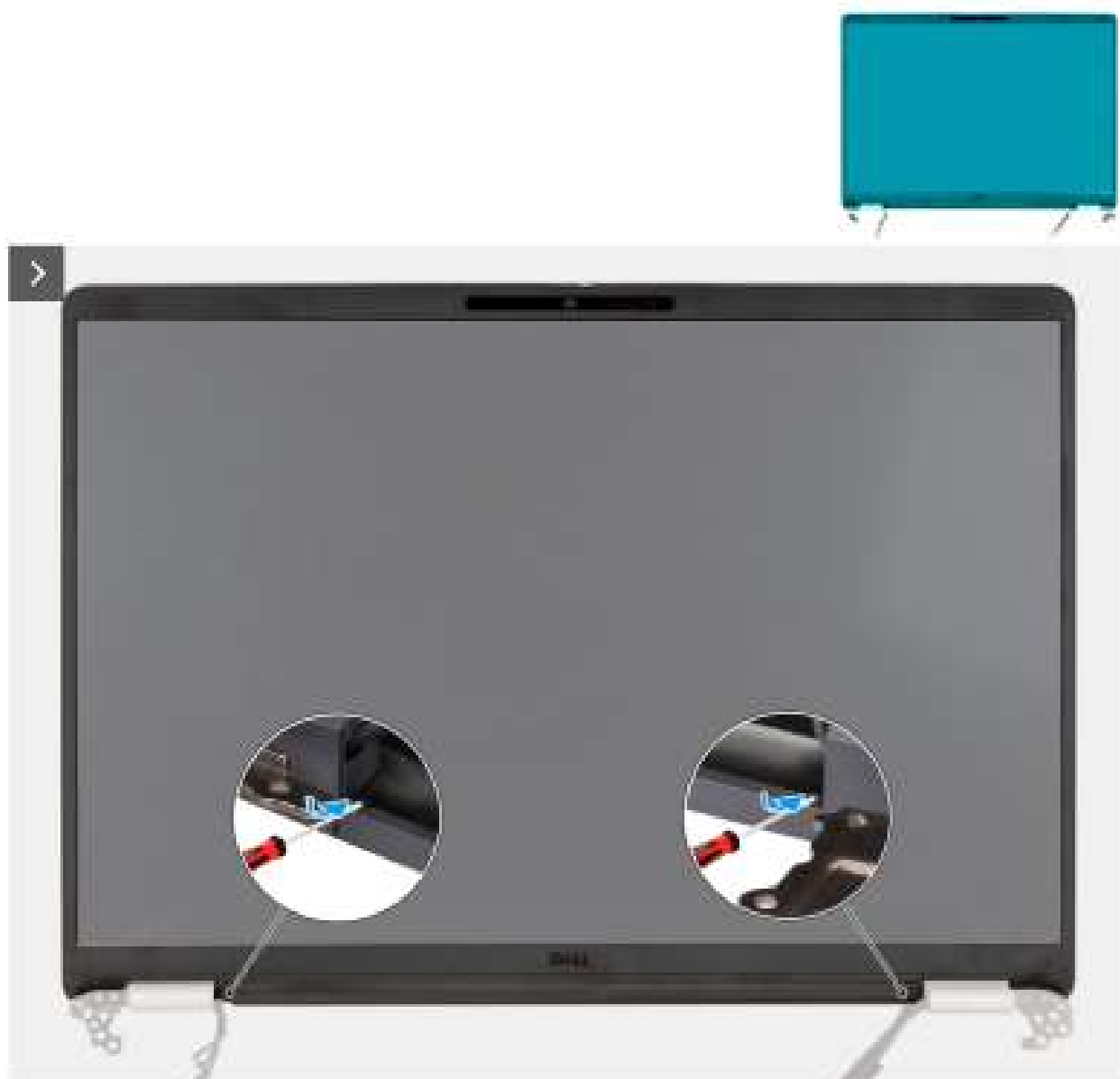
Afbeelding 24. De plastic bezel loswrikken
