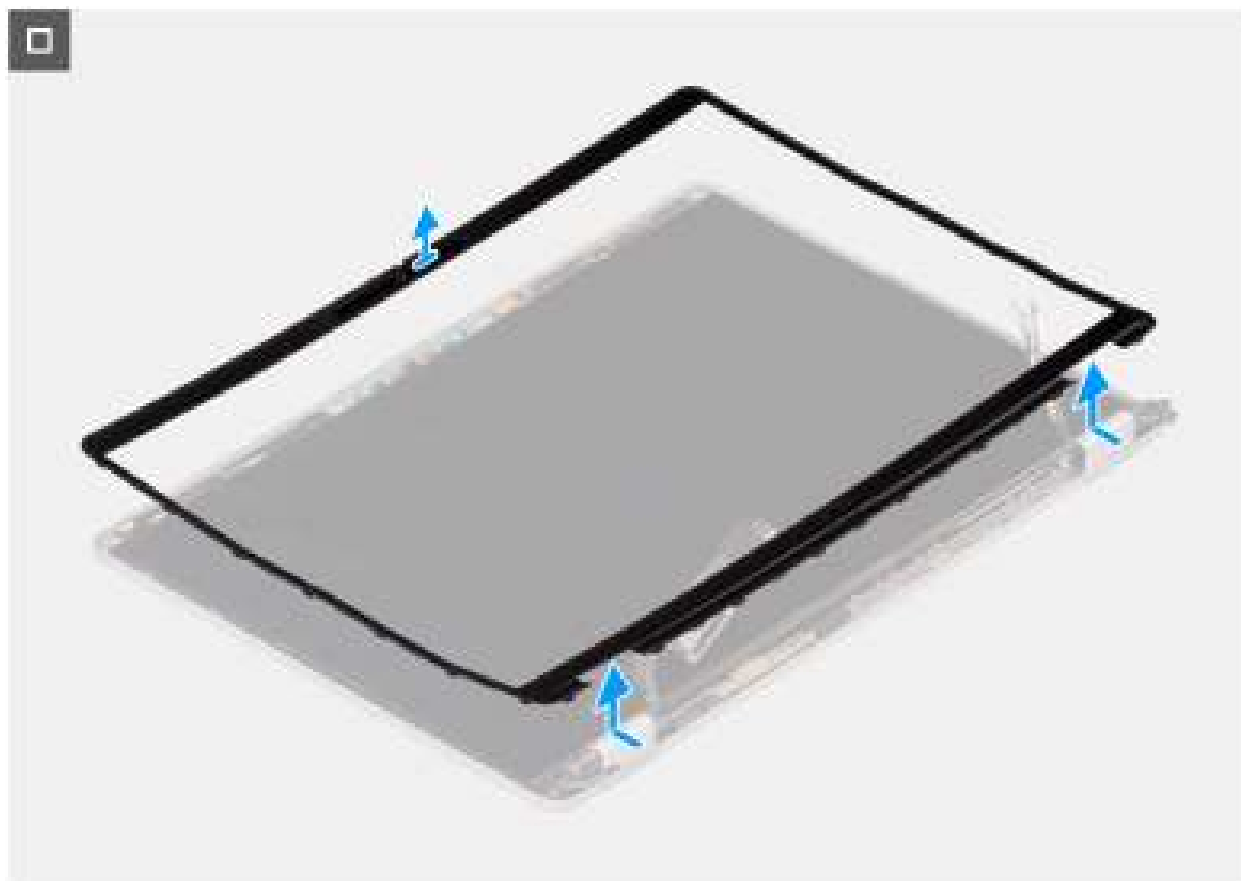
Afbeelding 28. De beeldschermbezel verwijderen
