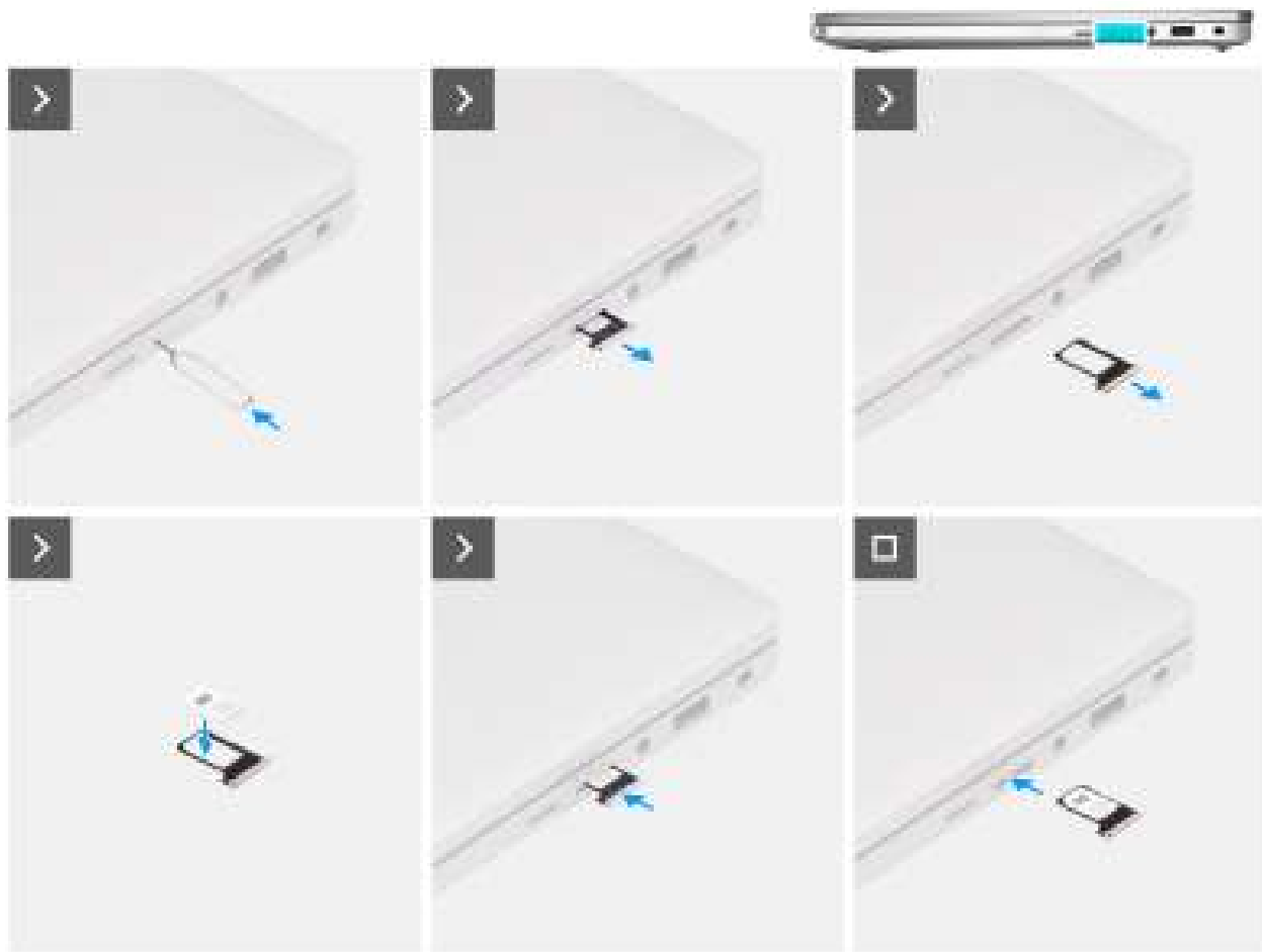
Afbeelding 5. De simkaarthouder installeren
