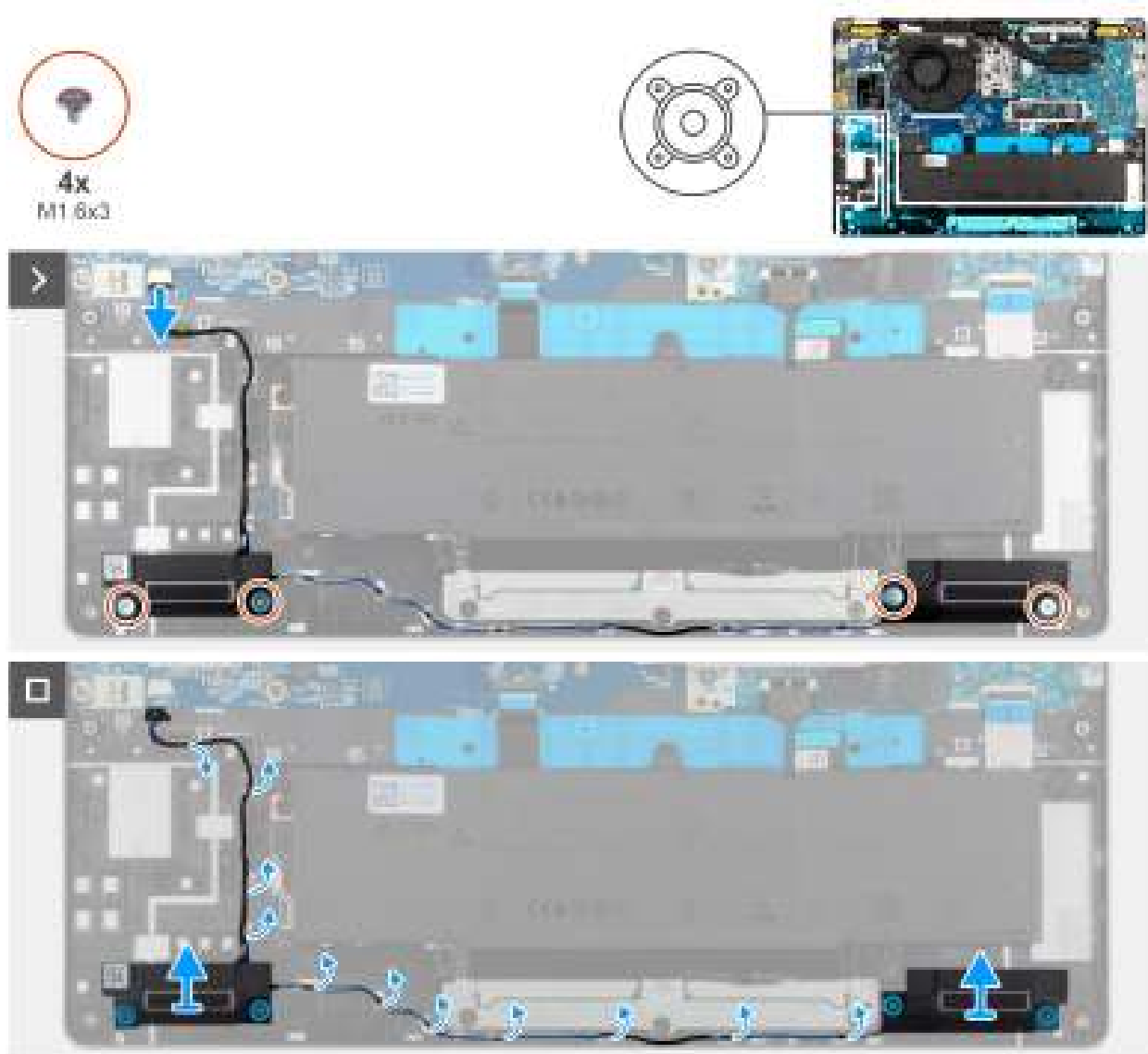
Afbeelding 16. De luidsprekers verwijderen
