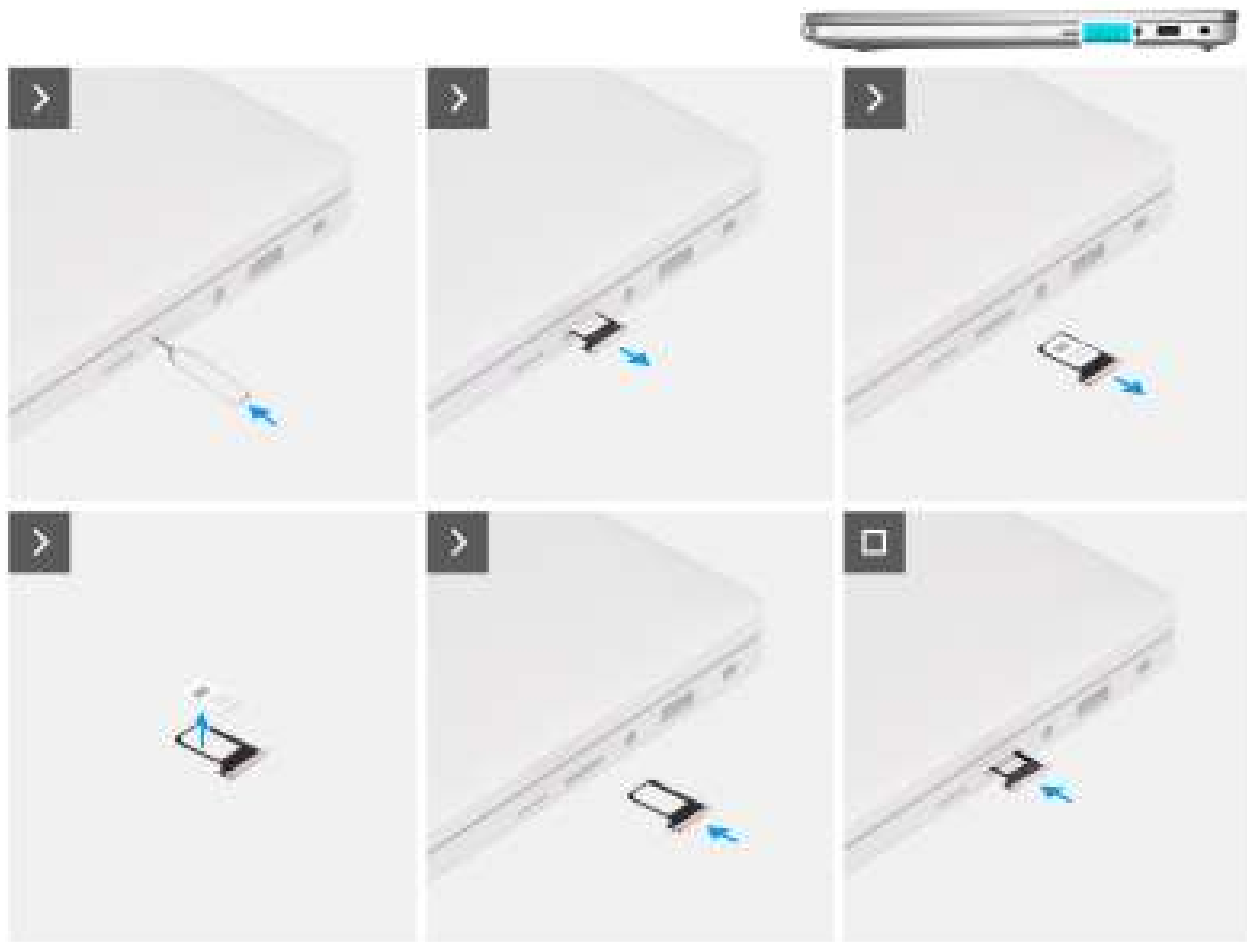
Afbeelding 4. De simkaarthouder verwijderen
