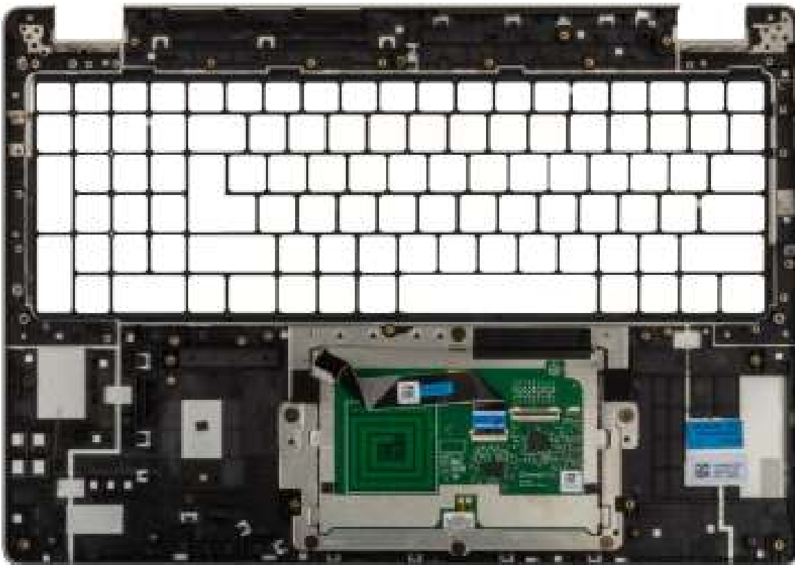
Afbeelding 61. De palmsteuneenheid verwijderen
