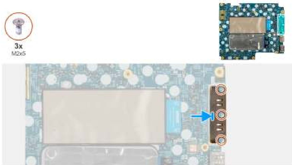
Afbeelding 53. De USB-C-connectormodule installeren
