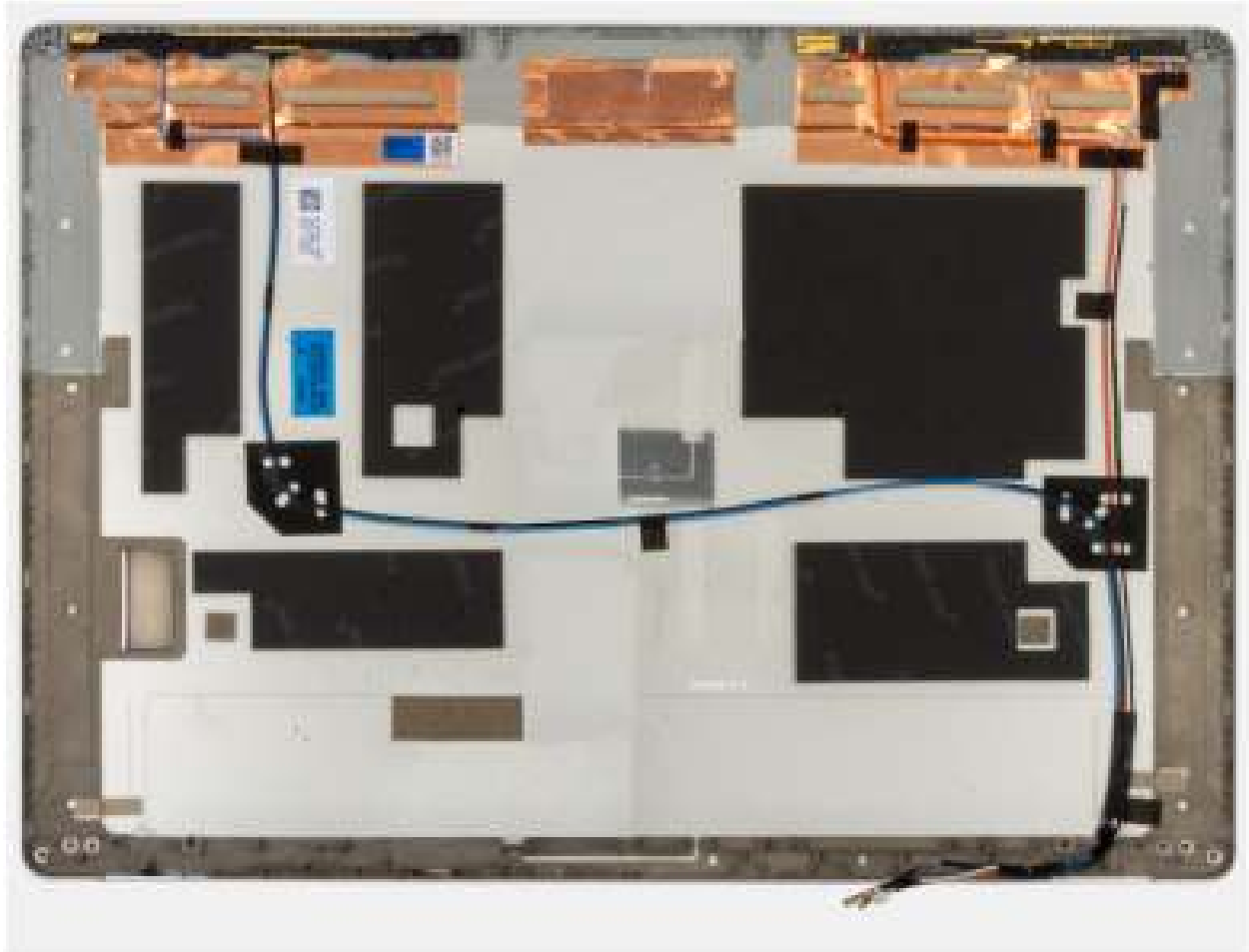
Afbeelding 40. Het achterpaneel van het beeldscherm verwijderen
