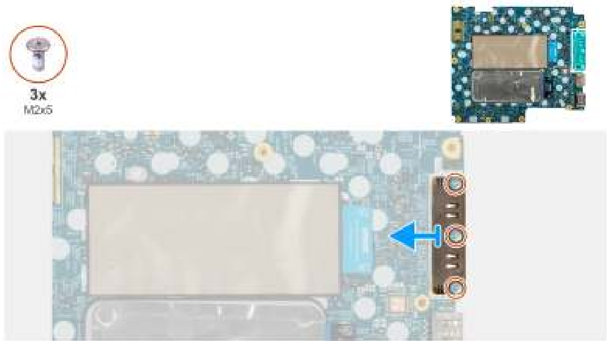
Afbeelding 52. De USB-C-connectormodule verwijderen
