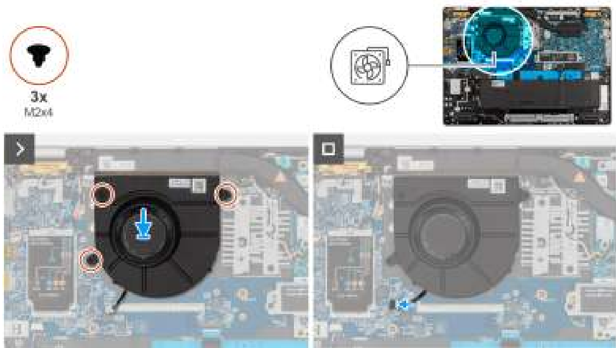
Afbeelding 20. De ventilator installeren
