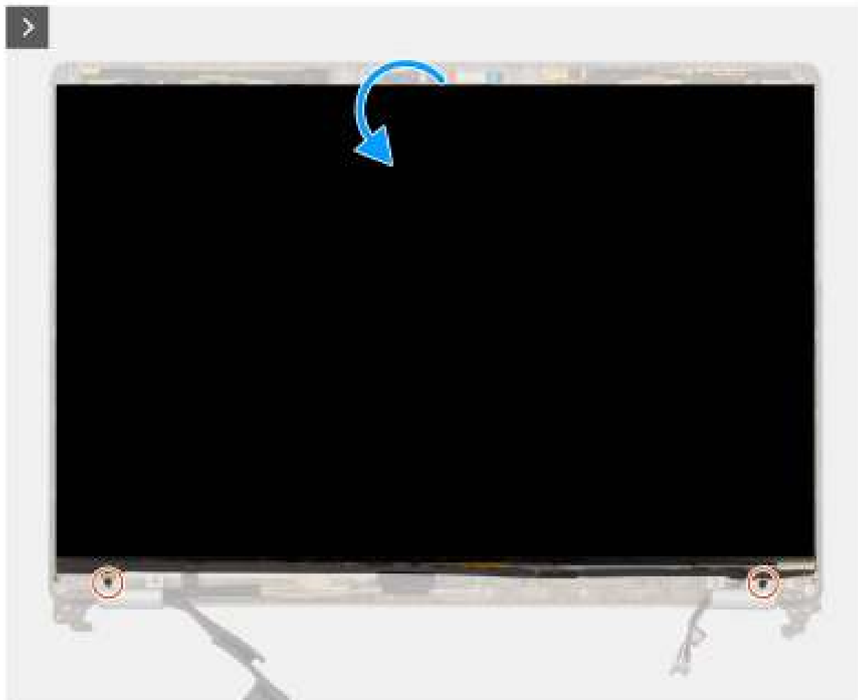
Afbeelding 30. Het beeldschermpaneel verwijderen
