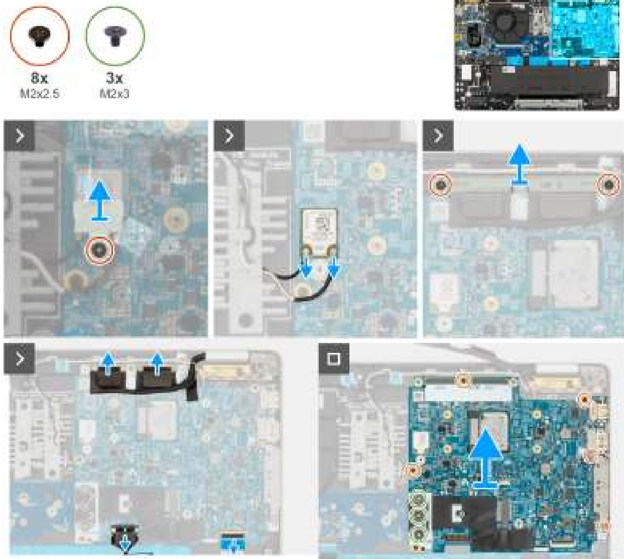
Afbeelding 49. De systeemkaart verwijderen
