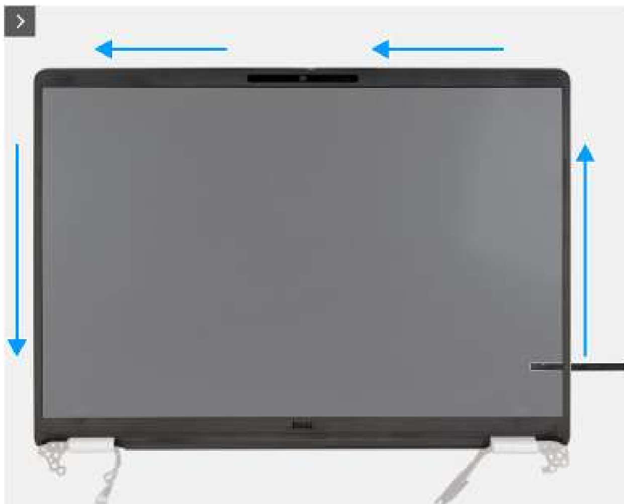
Afbeelding 27. De beeldschermbezel verwijderen
