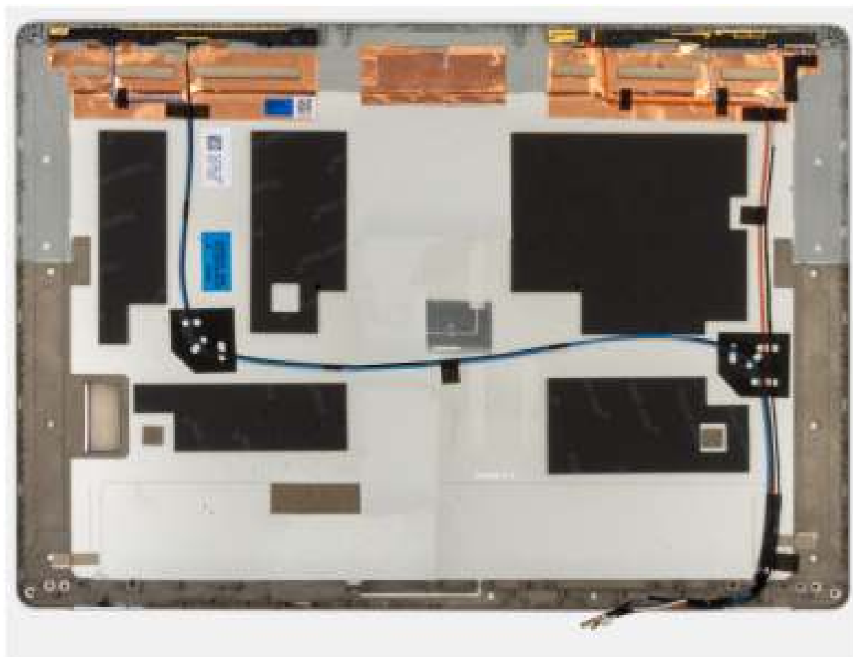
Afbeelding 41. Het achterpaneel van het beeldscherm installeren
