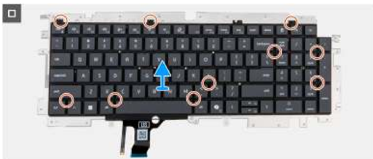
Afbeelding 59. Het toetsenbord verwijderen
