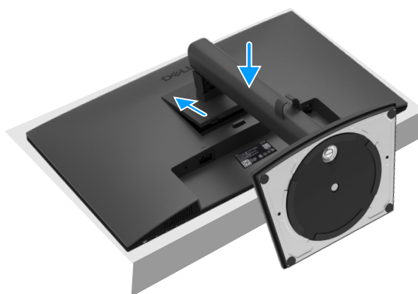
Afbeelding 13. De VESA-beschermkap verwijderen
