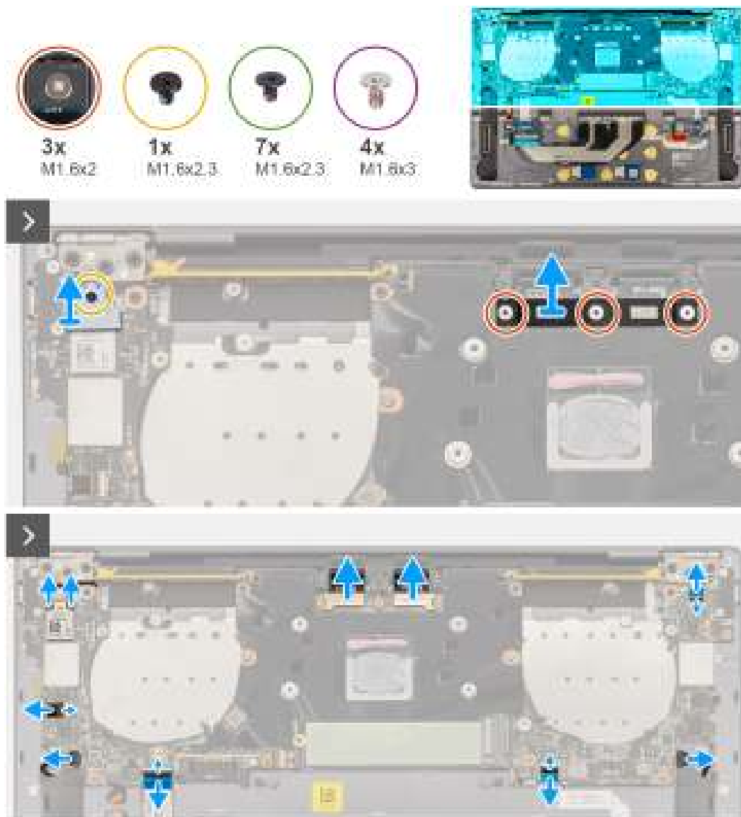
Afbeelding 36. De systeemkaart verwijderen
