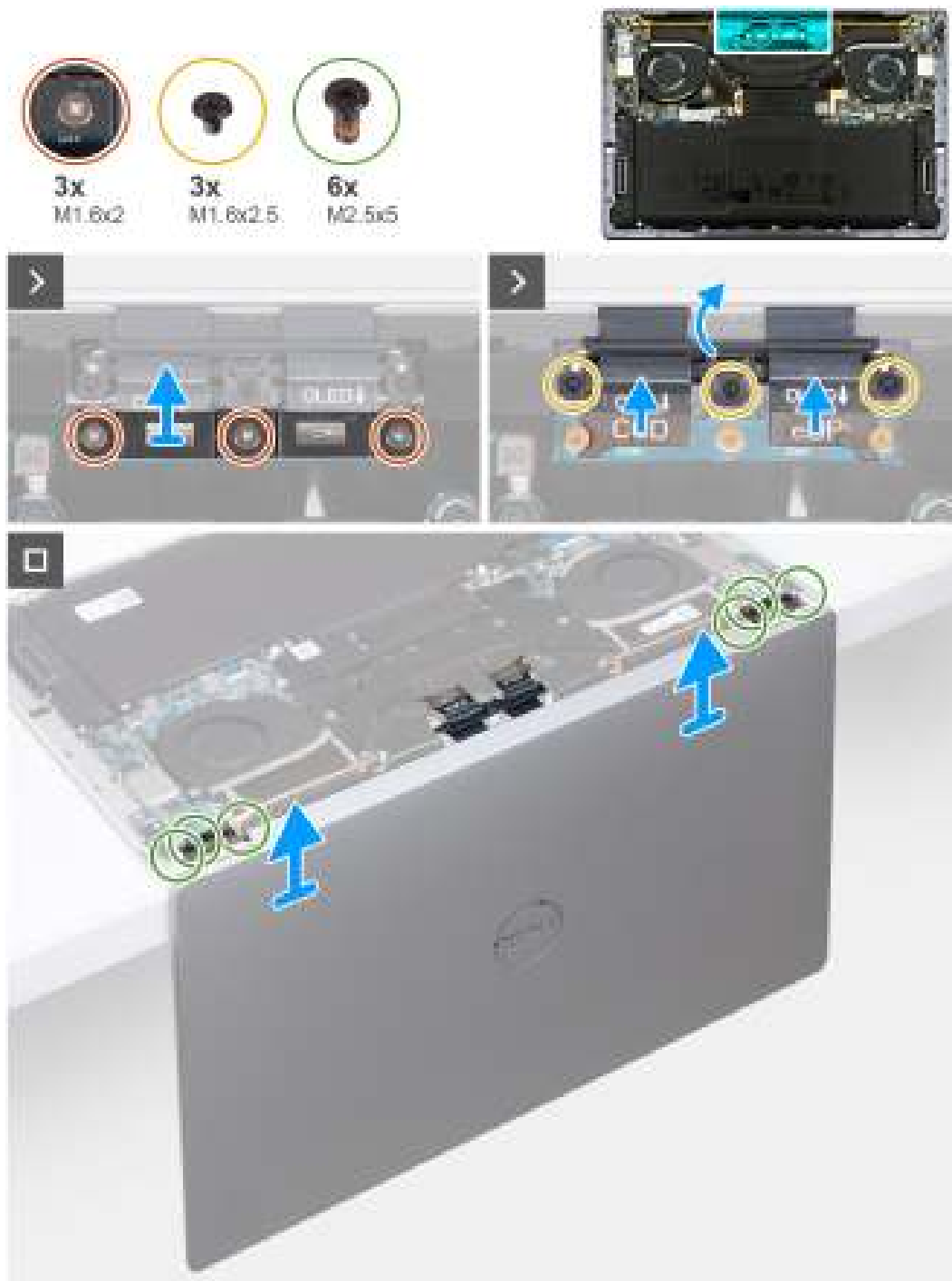
Afbeelding 31. De beeldschermeenheid verwijderen
