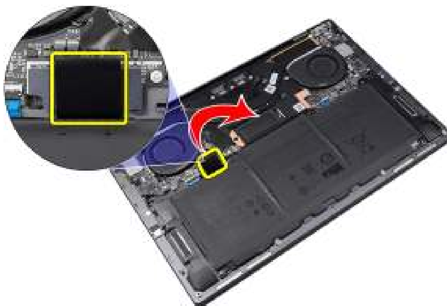
Afbeelding 16. De batterijconnectorbeugel verwijderen
