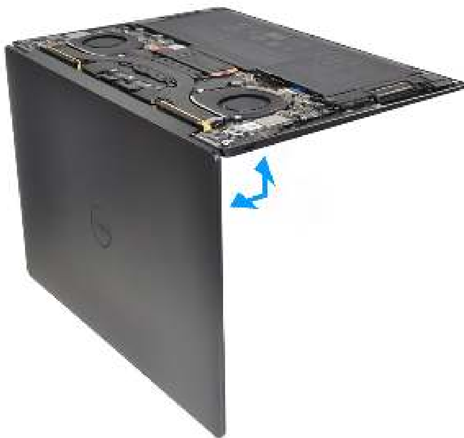
Afbeelding 39. Open de beeldschermeenheid onder een hoek van 90 graden.
