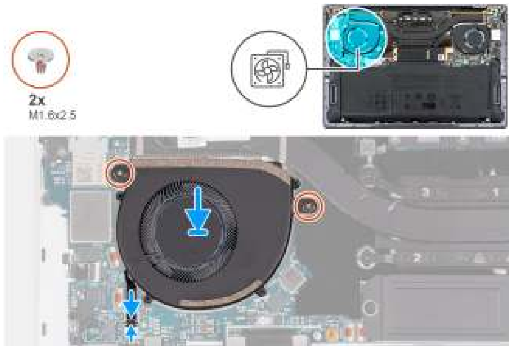
Afbeelding 28. De rechterventilator plaatsen
