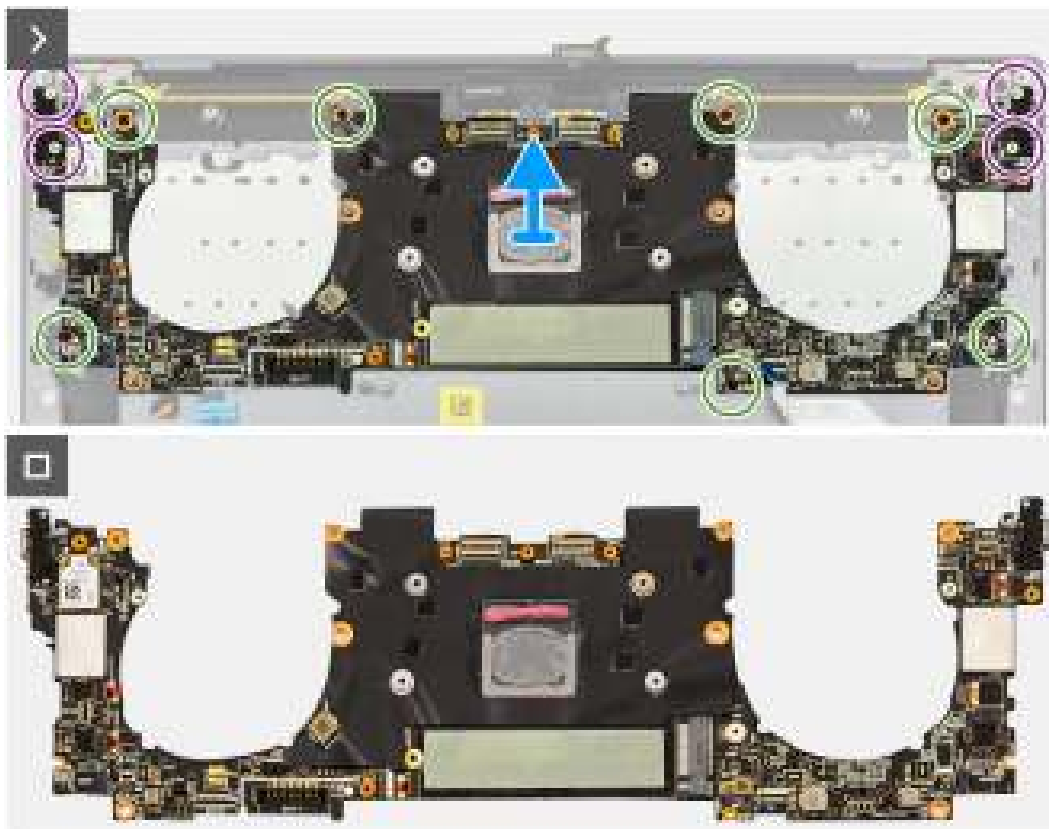
Afbeelding 37. De systeemkaart verwijderen
