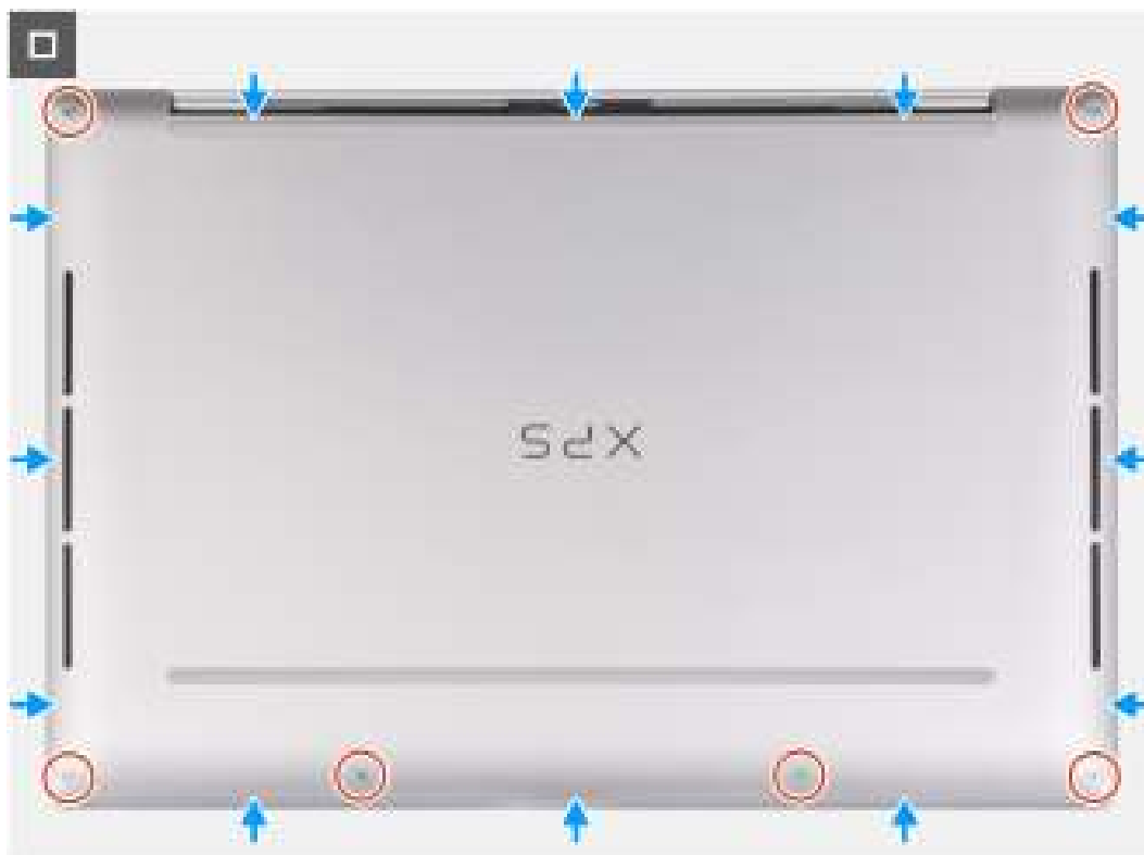
Afbeelding 13. De onderplaat plaatsen
