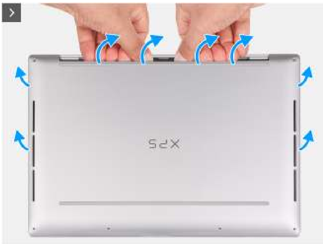
Afbeelding 10. De onderplaat verwijderen
