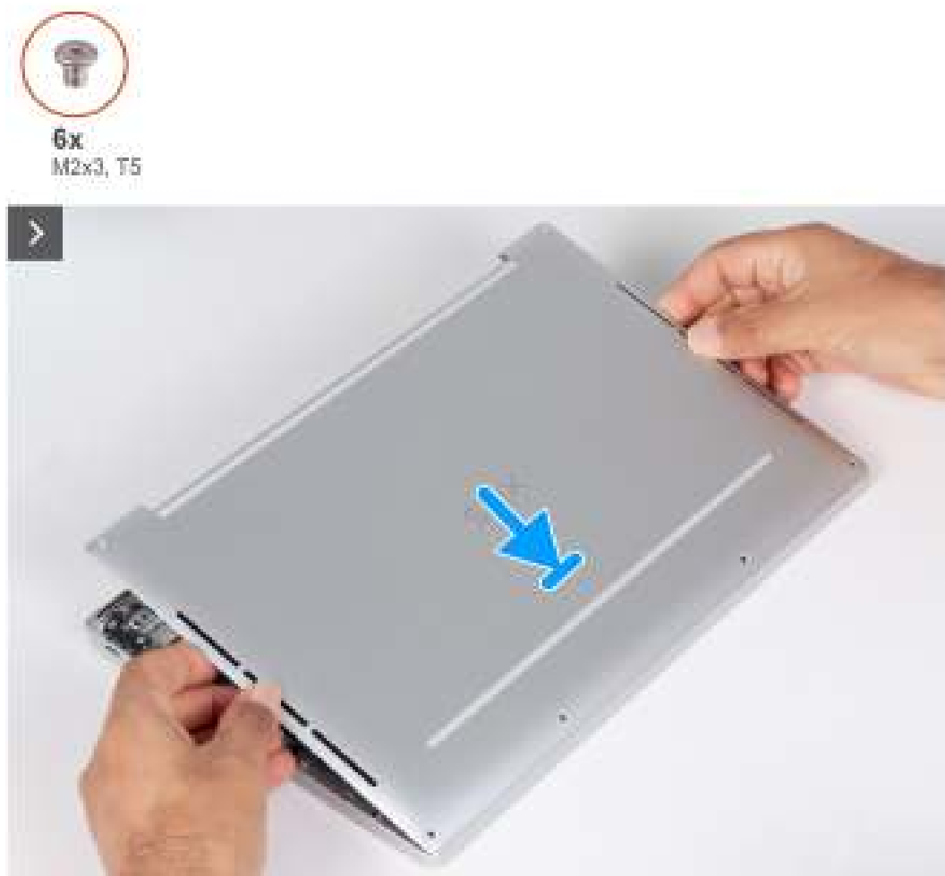
Afbeelding 12. De onderplaat plaatsen
