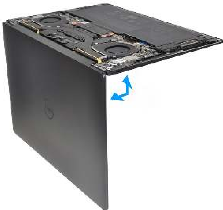
Afbeelding 35. Open de beeldschermeenheid onder een hoek van 90 graden.
