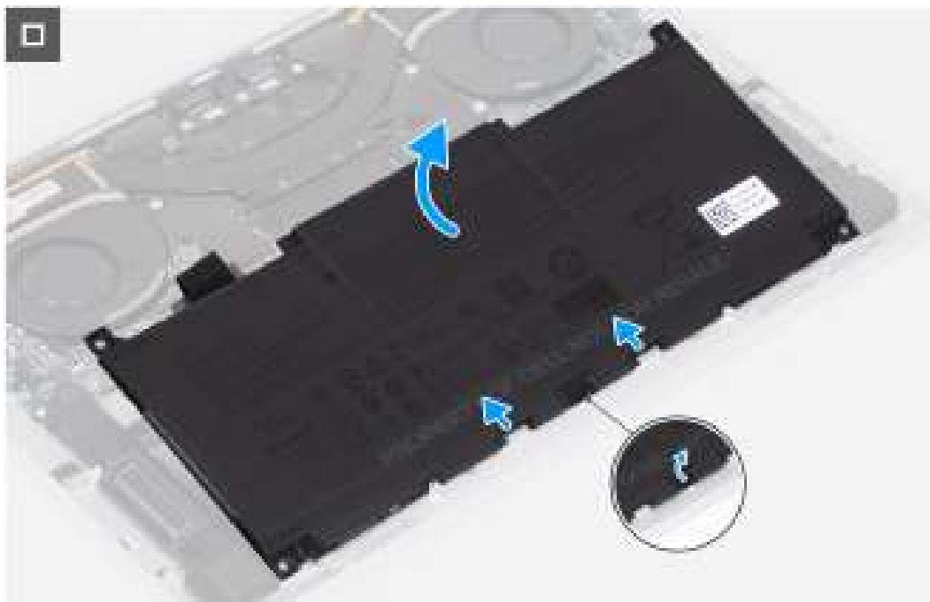
Afbeelding 15. De batterij verwijderen
