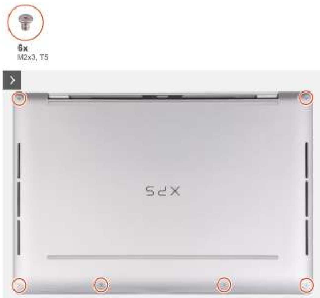
Afbeelding 9. De onderplaat verwijderen
