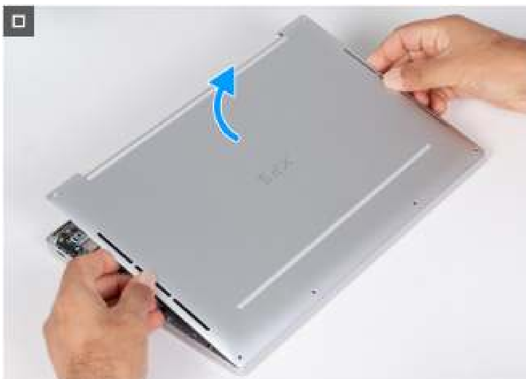
Afbeelding 11. De onderplaat verwijderen
