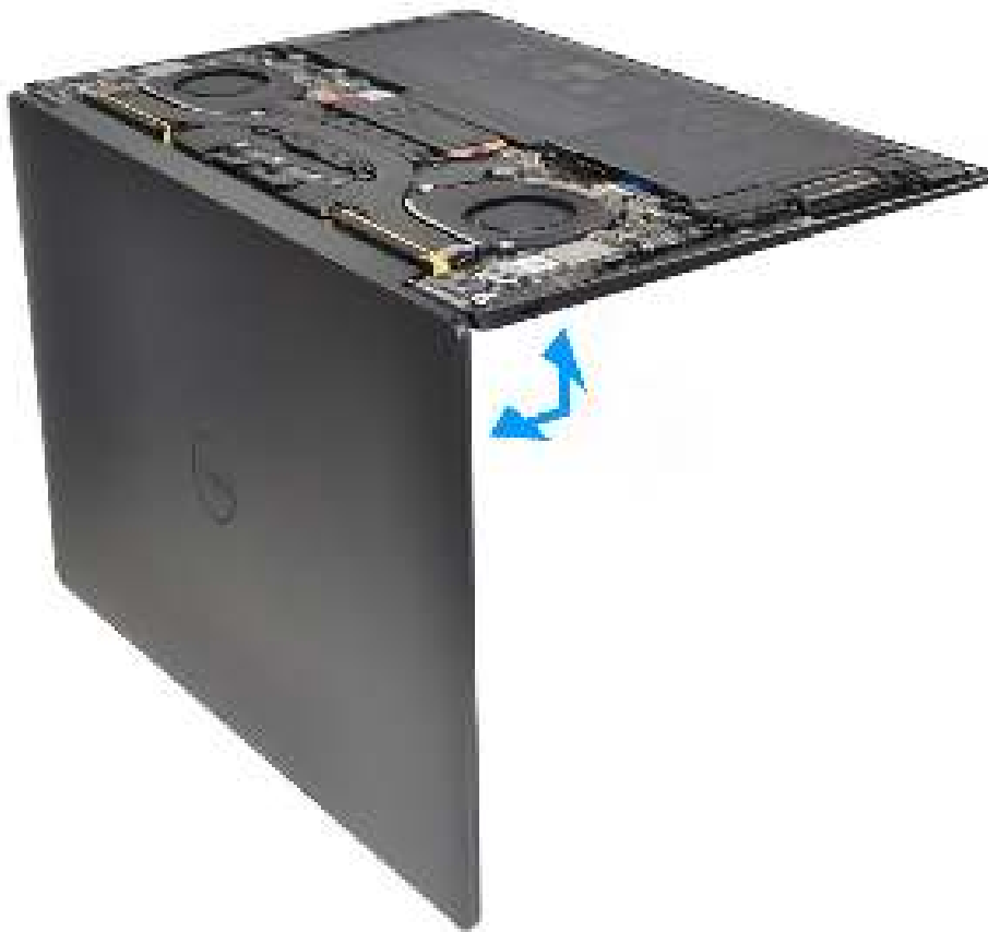
Afbeelding 43. Open de beeldscherm eenheid onder een hoek van 90 graden.
