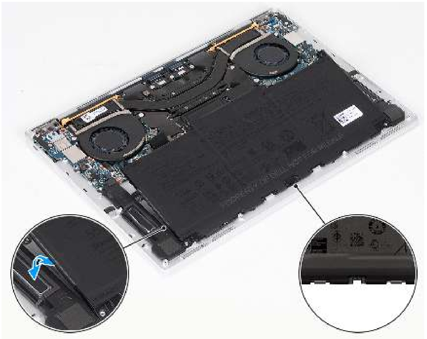
Afbeelding 17. Til de batterij op onder een hoek van minder dan 30 graden
