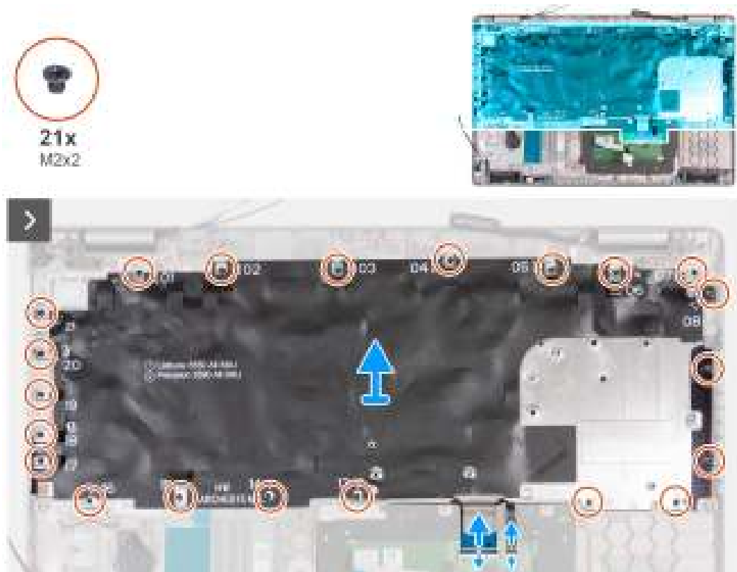
Afbeelding 65. Het toetsenbord verwijderen
