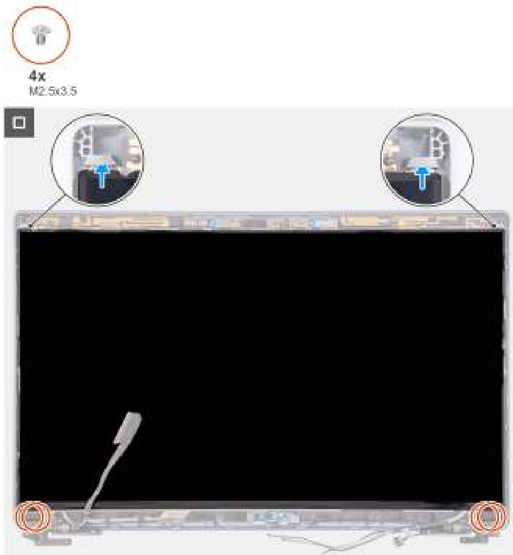
Afbeelding 83. Het beeldschermpaneel installeren
