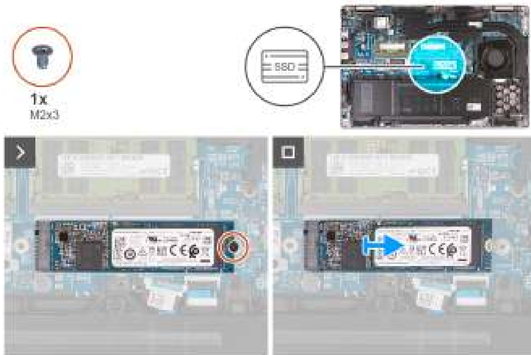
Afbeelding 29. De M.2 2280 SSD verwijderen uit slot 1
