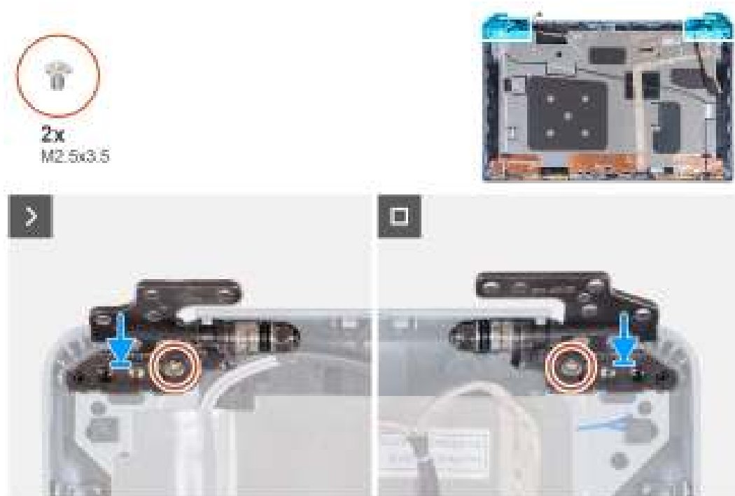
Afbeelding 87. De beeldschermcharnieren installeren
