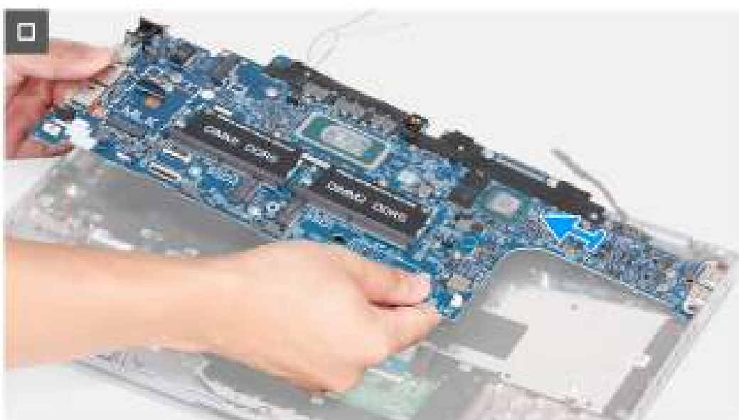
Afbeelding 56. De systeemkaart verwijderen
