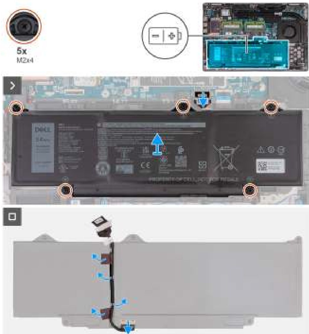
Afbeelding 35. De batterij verwijderen
