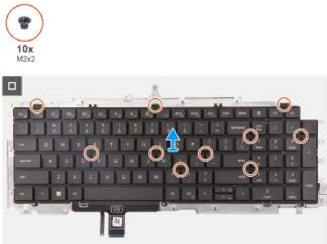
Afbeelding 66. Het toetsenbord verwijderen
