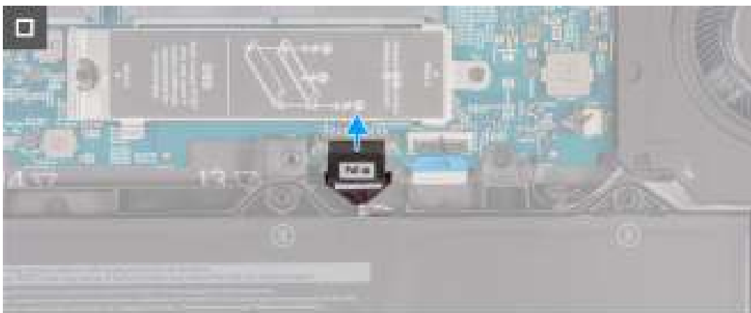
Afbeelding 15. De batterijkabel loskoppelen
