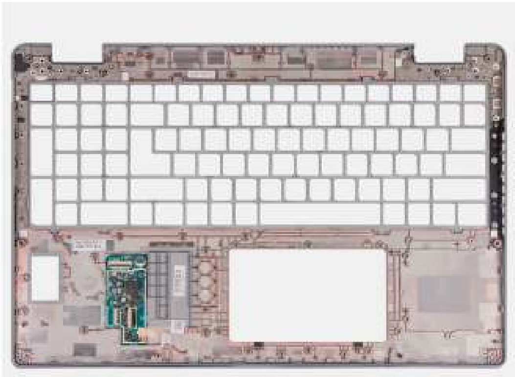
Afbeelding 101. De palmsteuneenheid installeren
