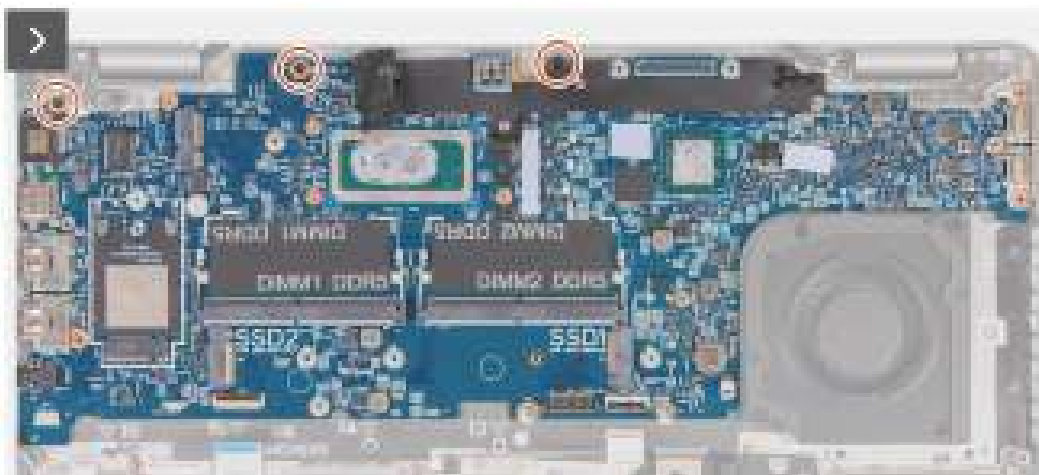
Afbeelding 55. De systeemkaart verwijderen
