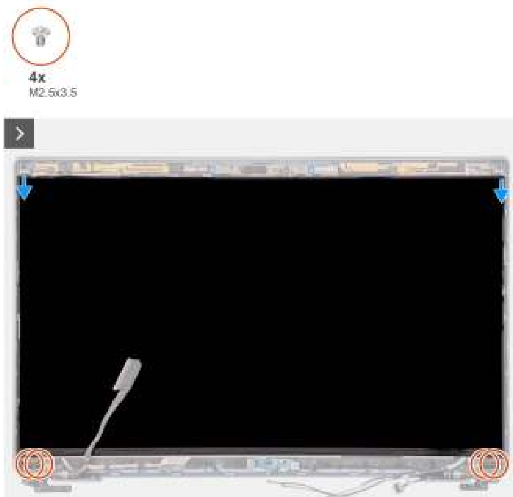
Afbeelding 76. Het beeldschermpaneel verwijderen
