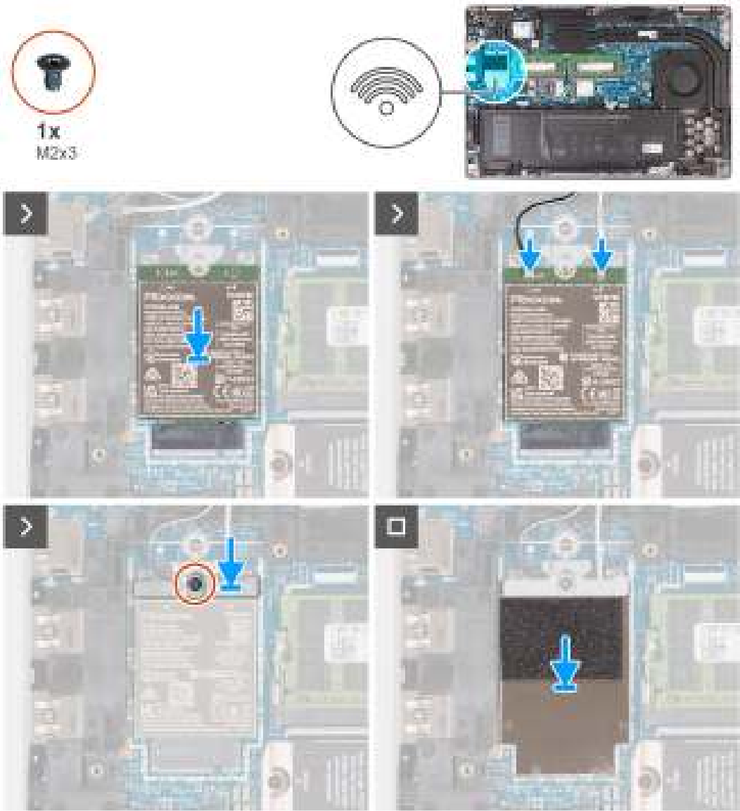
Afbeelding 22. De 4G WWAN-kaart installeren
