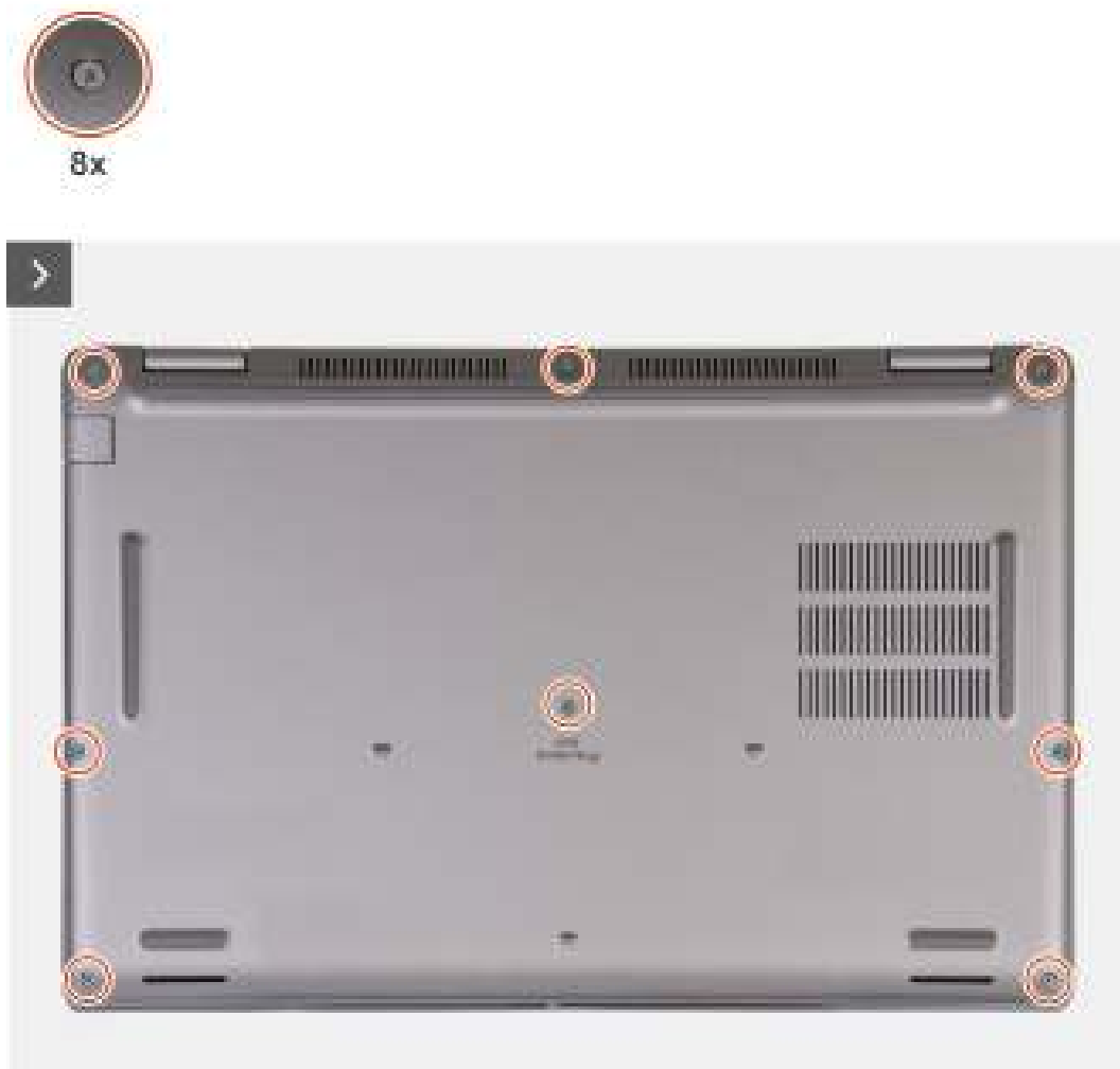
Afbeelding 13. De geborgde schroeven losdraaien
