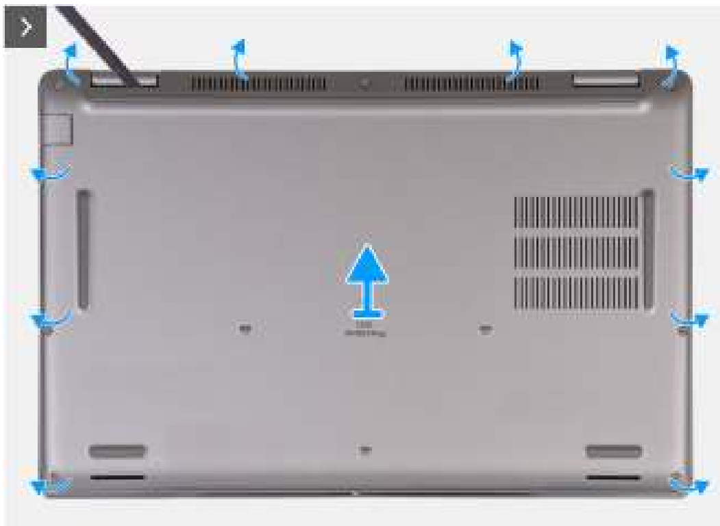
Afbeelding 14. De onderplaat verwijderen
