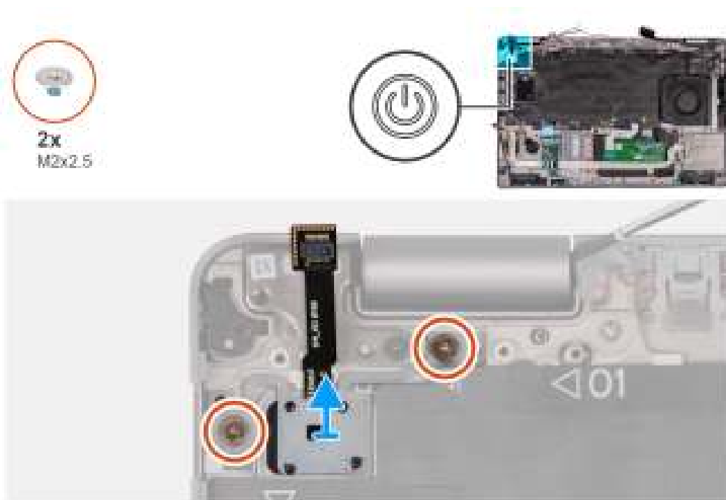
Afbeelding 63. De aan-uitknop met de optionele vingerafdruklezer verwijderen
