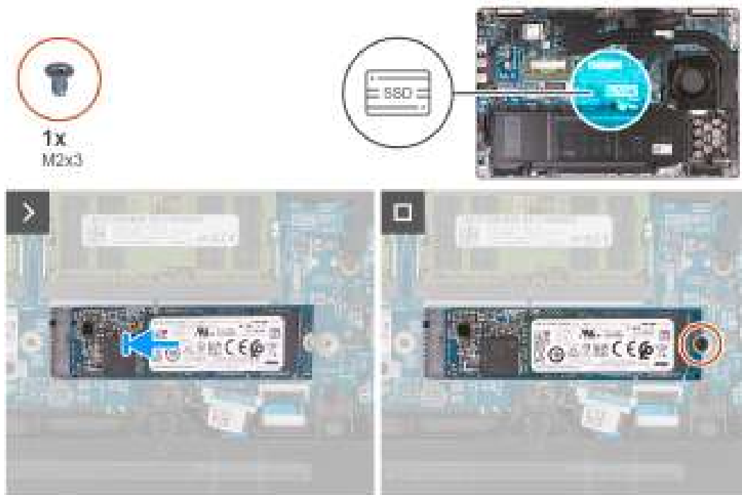
Afbeelding 30. De M.2 2280 SSD in slot 1 installeren
