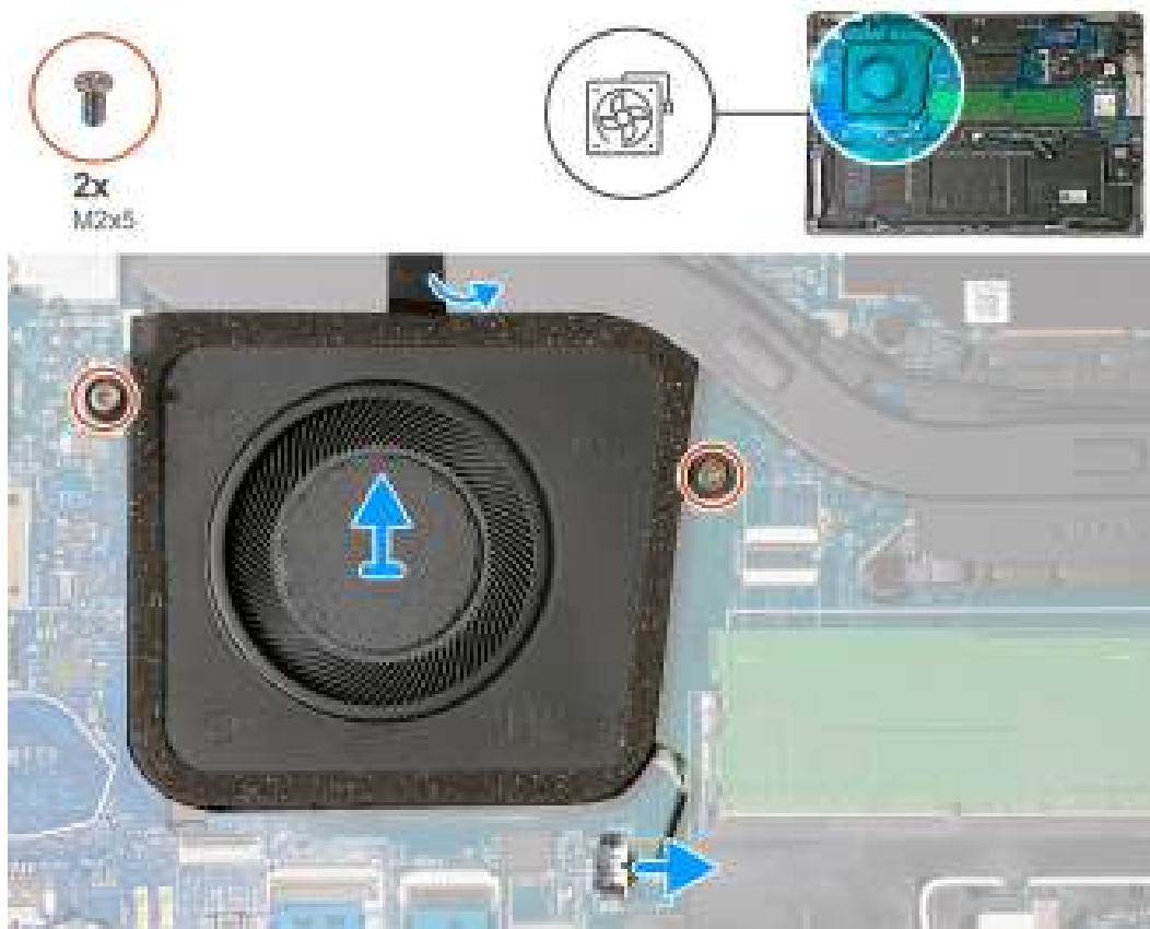
Afbeelding 24. De ventilator verwijderen
