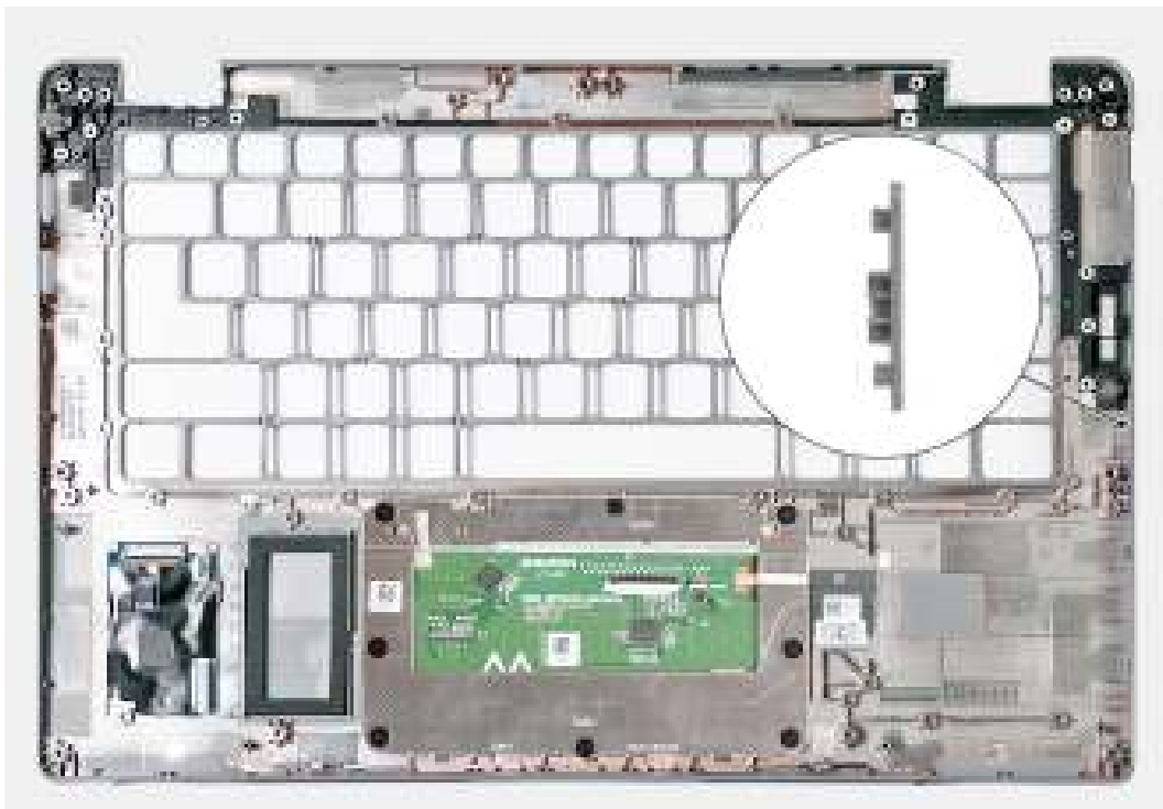
Afbeelding 83. De palmsteuneenheid verwijderen
