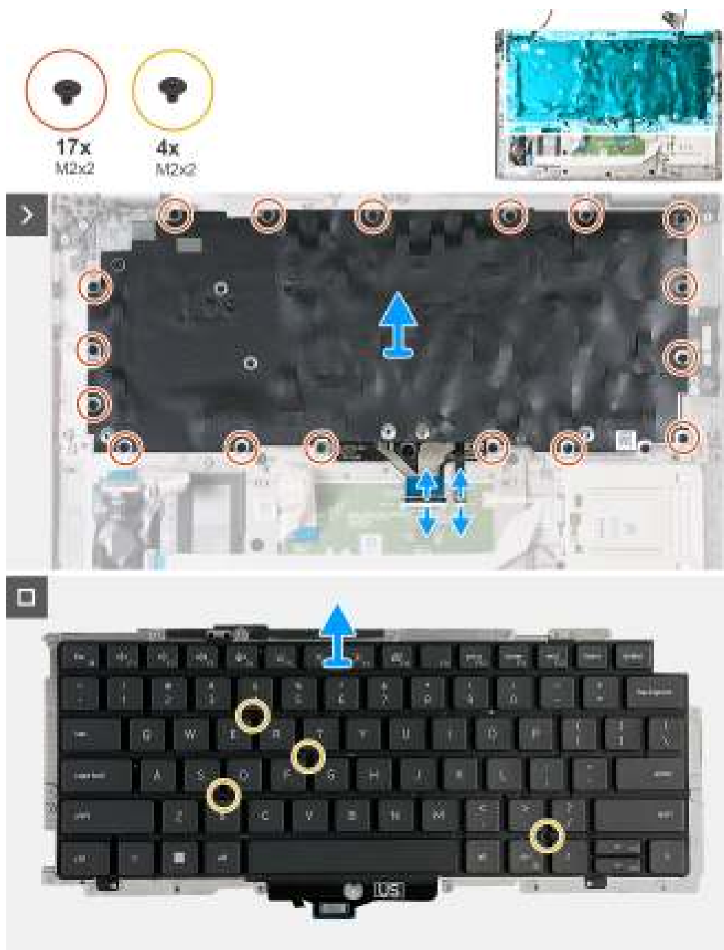
Afbeelding 79. Het toetsenbord verwijderen
