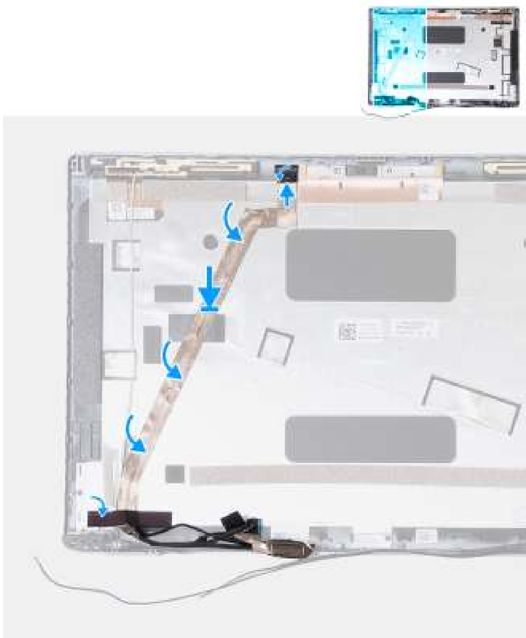
Afbeelding 63. De beeldschermkabel installeren
