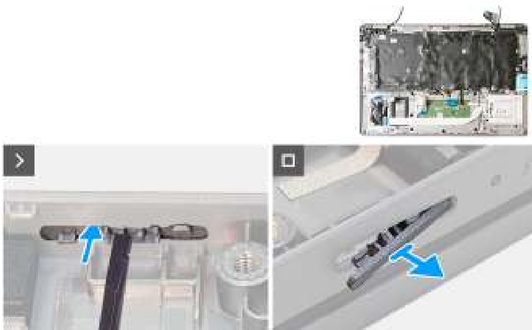
Afbeelding 85. De dummy simkaartslotvuller verwijderen
