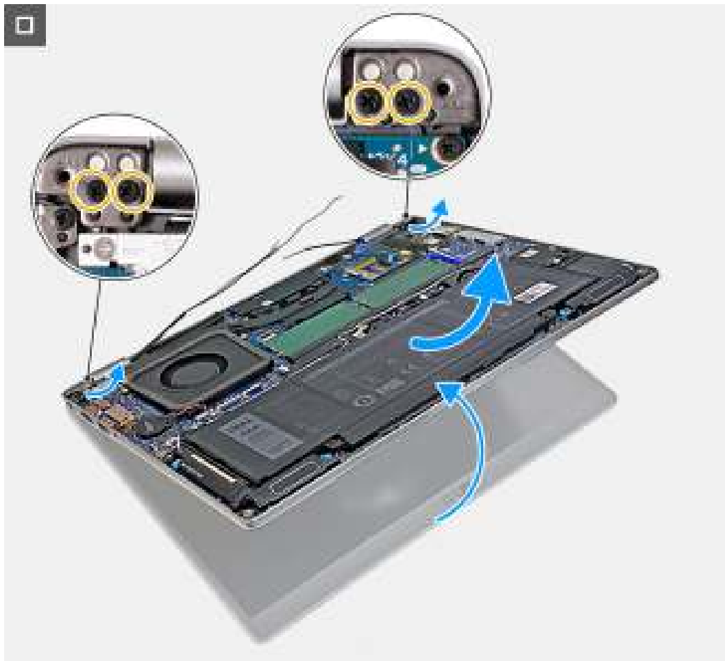
Afbeelding 44. De beeldschermeenheid verwijderen - Voor computers die worden geleverd met een 4G-kaart
