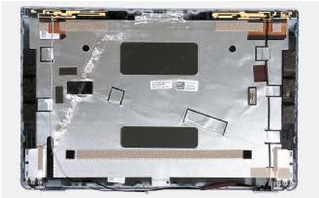
Afbeelding 65. Het achterpaneel van het beeldscherm installeren
