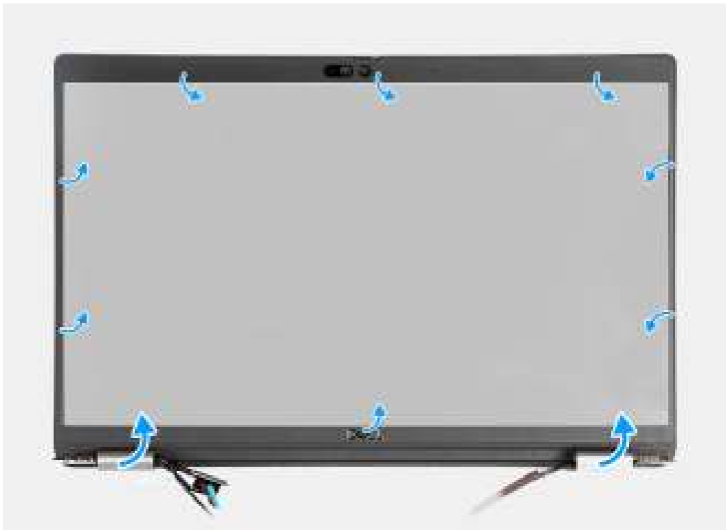
Afbeelding 53. De beeldschermbezel verwijderen
