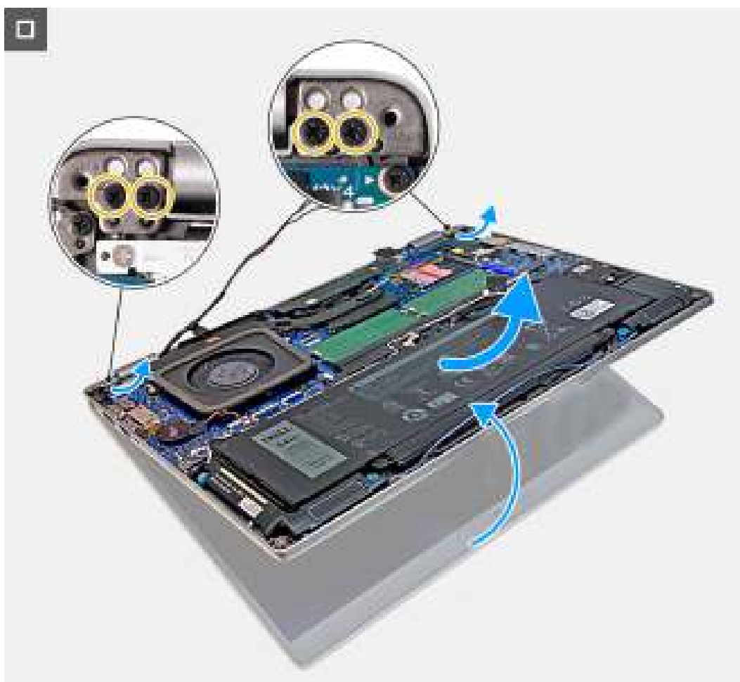
Afbeelding 46. De beeldschermeenheid verwijderen - Voor computers die worden geleverd met een 5G-kaart
