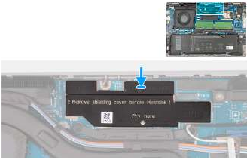
Afbeelding 35. De afdekplaat van de voeding installeren - voor computers die worden geleverd met een H28 UMA-systeemkaart
