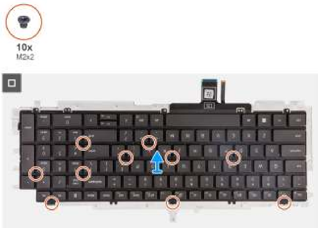
Afbeelding 70. Het toetsenbord verwijderen
