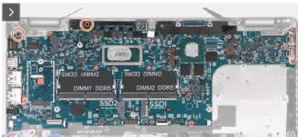
Afbeelding 59. De systeemkaart verwijderen
