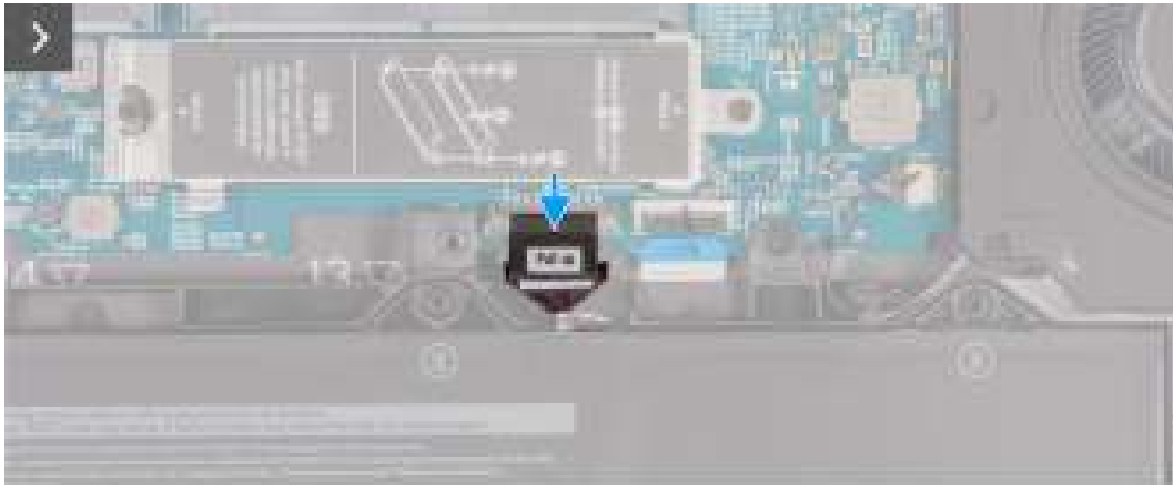
Afbeelding 16. De batterijkabel aansluiten
