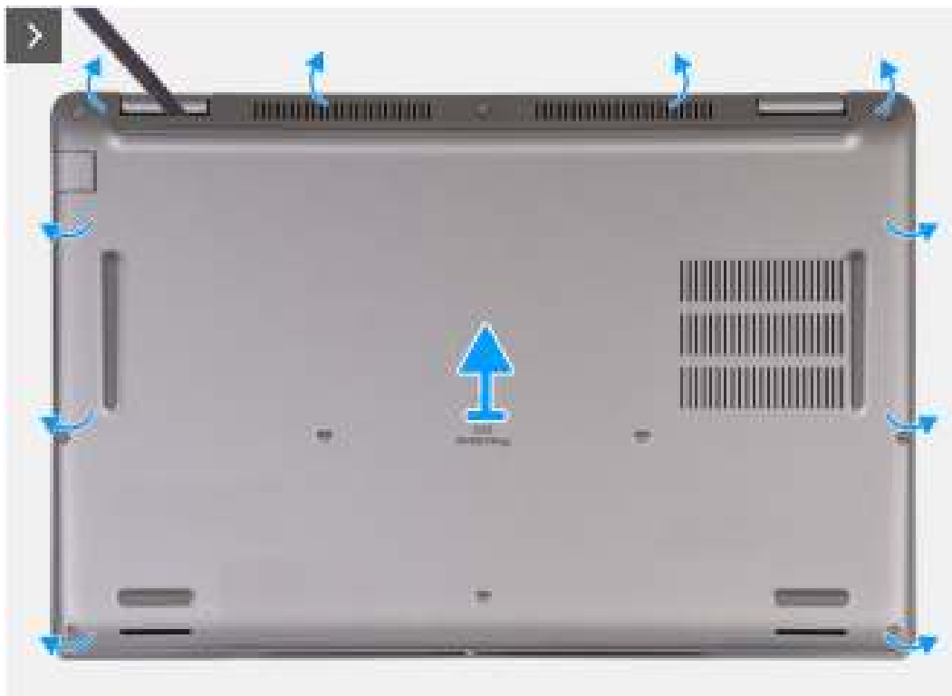
Afbeelding 14. De onderplaat verwijderen
