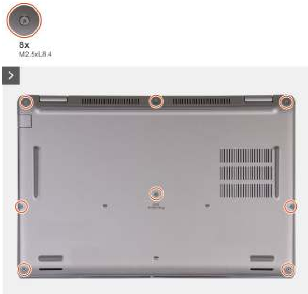
Afbeelding 13. De geborgde schroeven losdraaien
