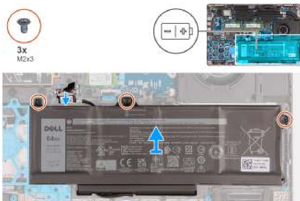
Afbeelding 37. De batterij verwijderen - 64 Whr
