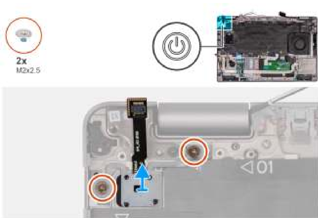
Afbeelding 67. De aan-uitknop met de optionele vingerafdruklezer verwijderen
