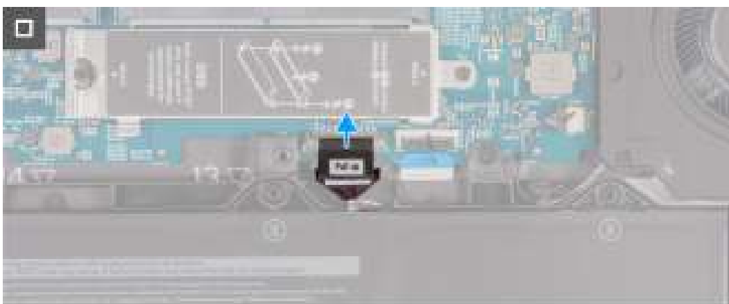
Afbeelding 15. De batterijkabel loskoppelen
