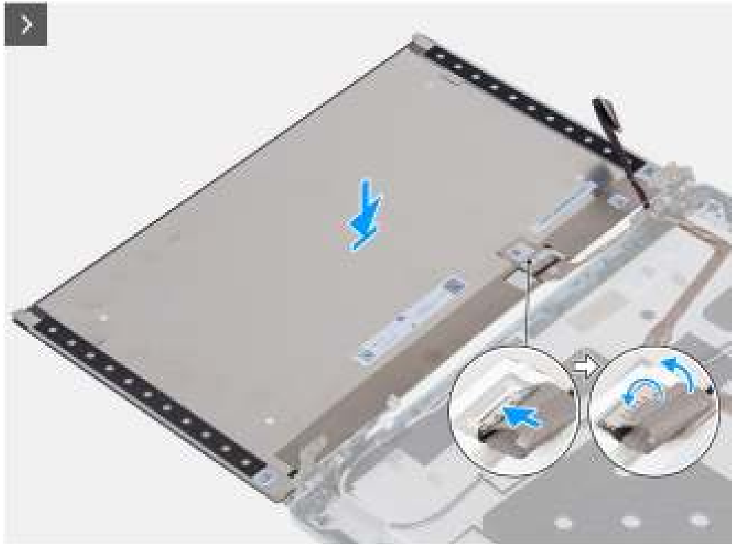
Afbeelding 85. Het beeldschermpaneel installeren
