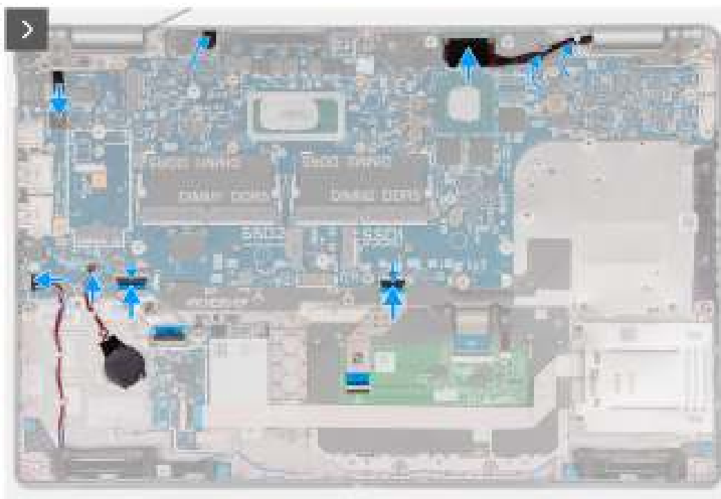
Afbeelding 63. De systeemkaart installeren
