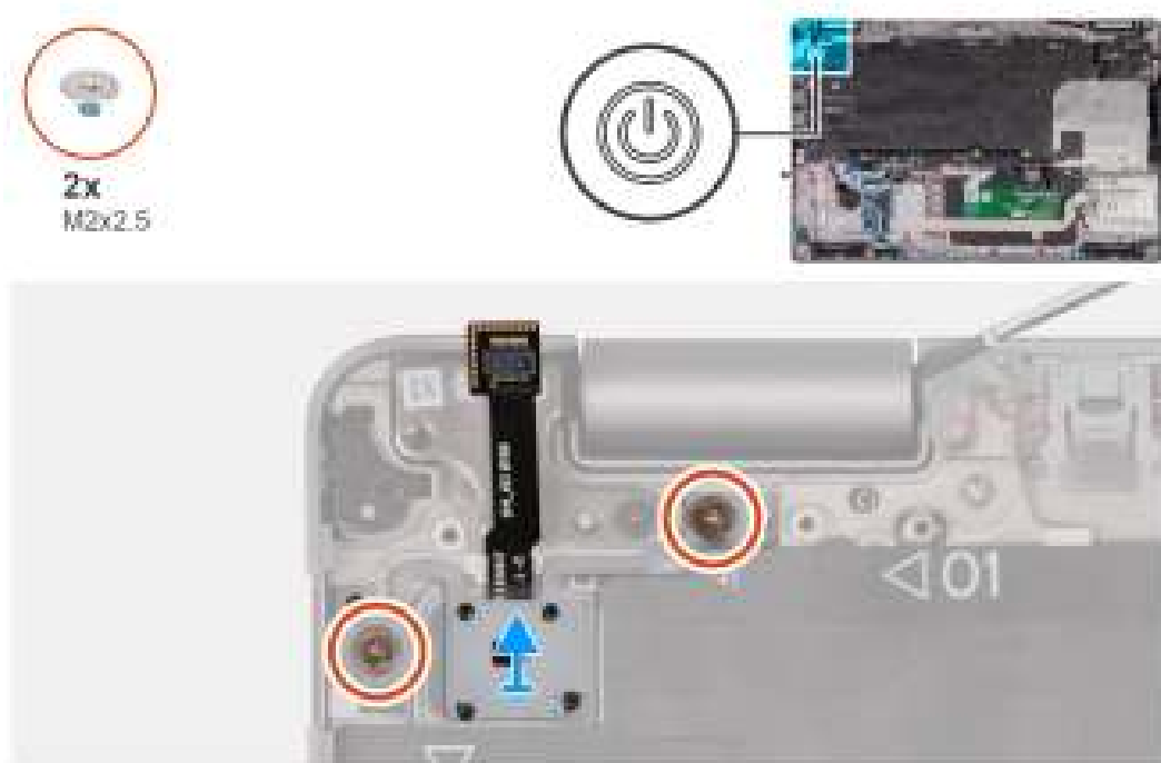
Afbeelding 65. De aan/uit-knop verwijderen
