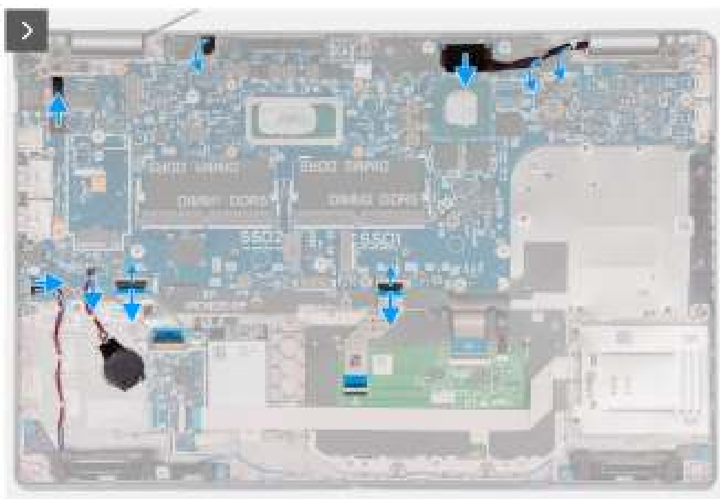
Afbeelding 58. De systeemkaart verwijderen
