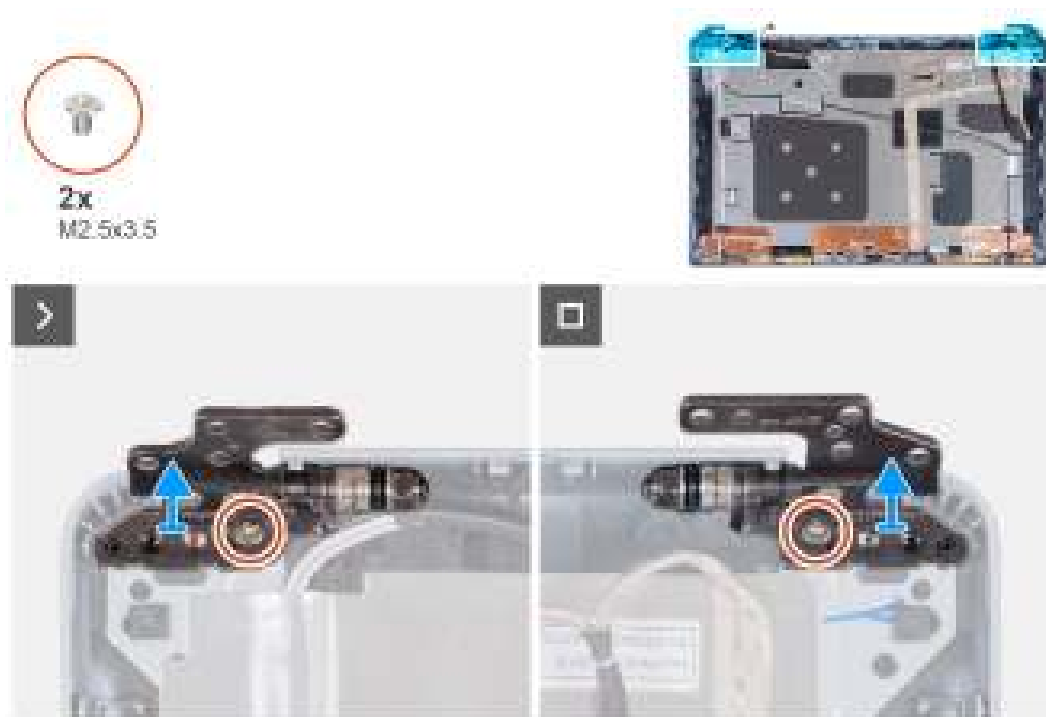
Afbeelding 90. De beeldschermcharnieren verwijderen
