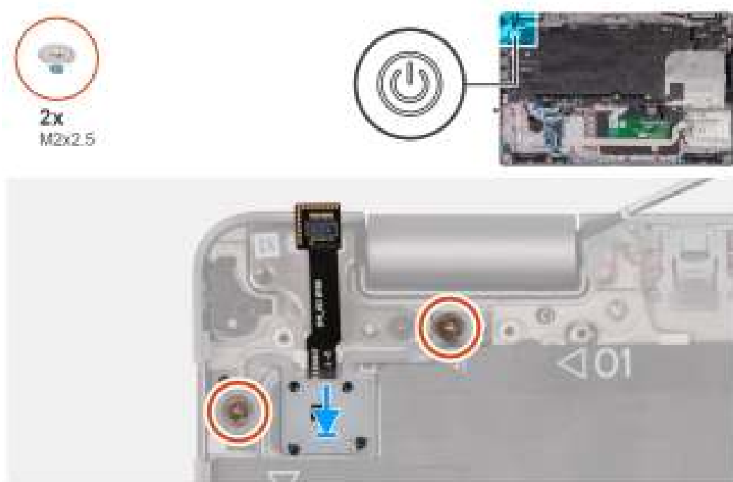
Afbeelding 68. De aan-uitknop met optionele vingerafdruklezer plaatsen
