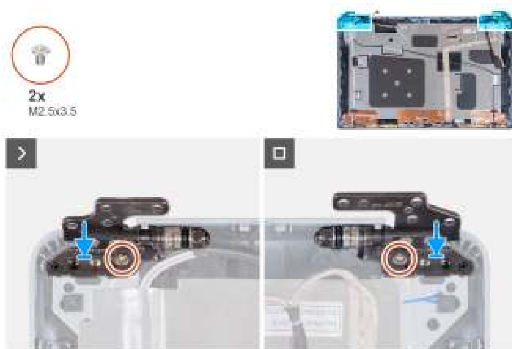
Afbeelding 91. De beeldschermcharnieren installeren
