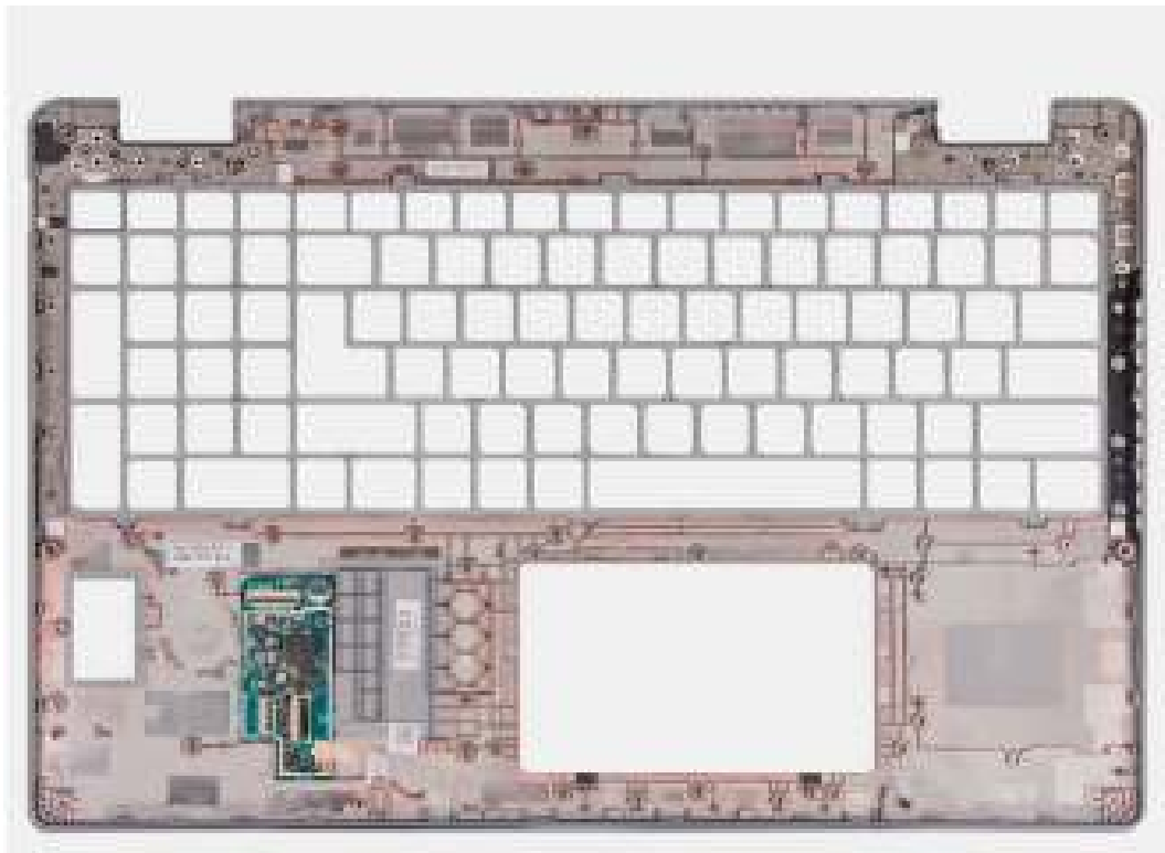
Afbeelding 102. De palmsteuneenheid verwijderen
