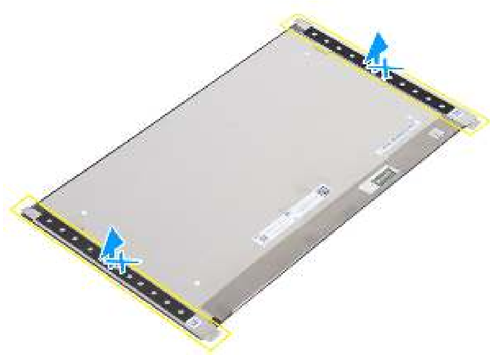
Afbeelding 83. Trek de Stretch Release-tapes (SR) niet los
