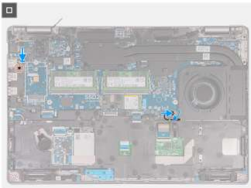
Afbeelding 44. Het binnenframe van de eenheid installeren
