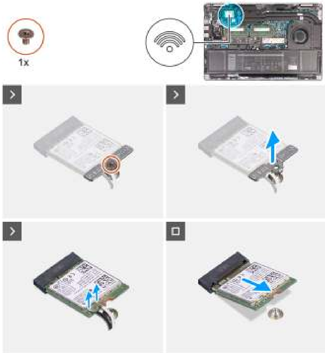
Afbeelding 19. De draadloze kaart verwijderen
