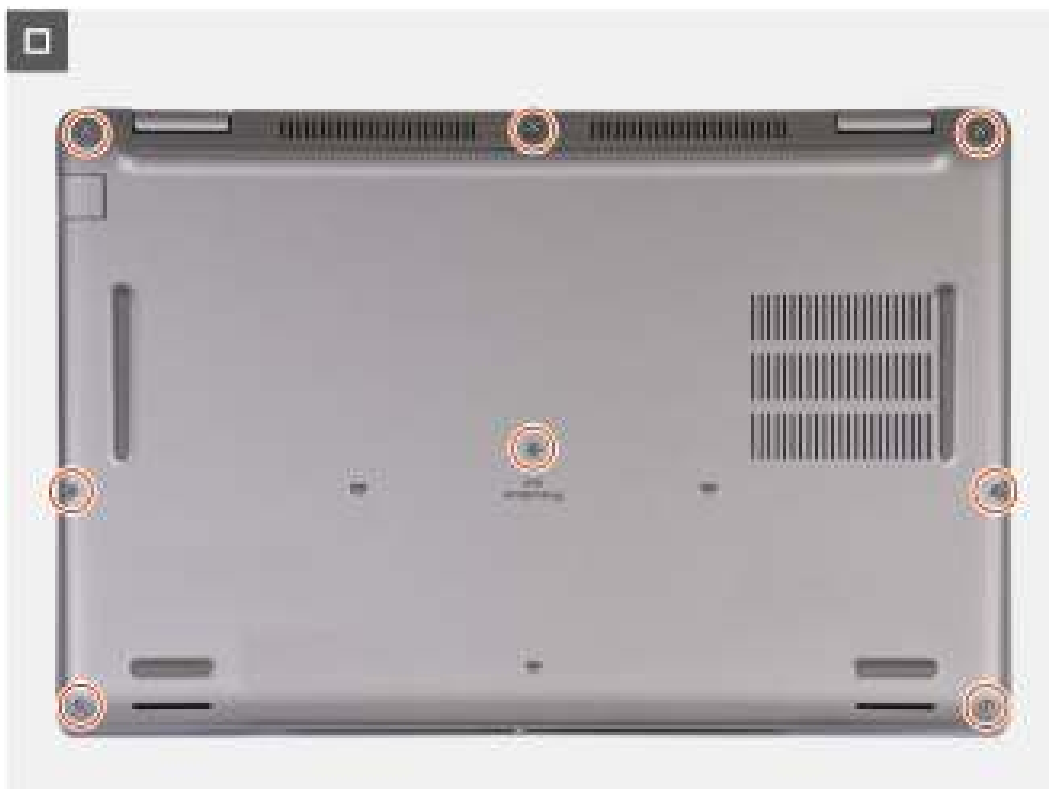
Afbeelding 18. De geborgde schroeven vastdraaien
