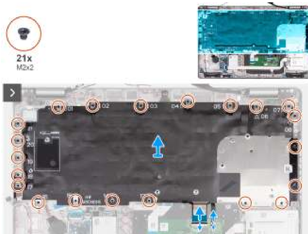
Afbeelding 69. Het toetsenbord verwijderen
