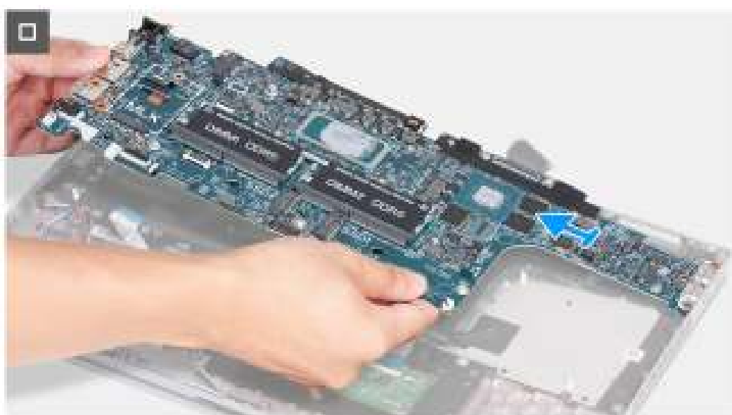
Afbeelding 60. De systeemkaart verwijderen
