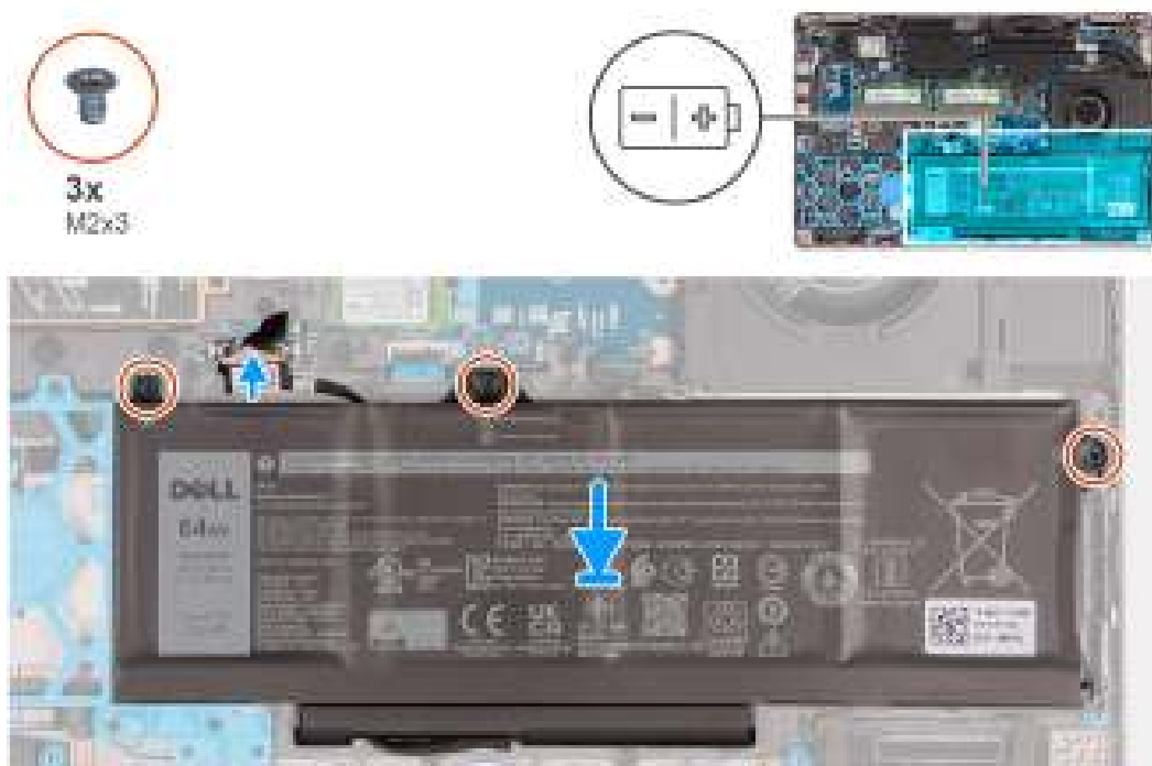
Afbeelding 39. De 64 Whr batterij installeren
