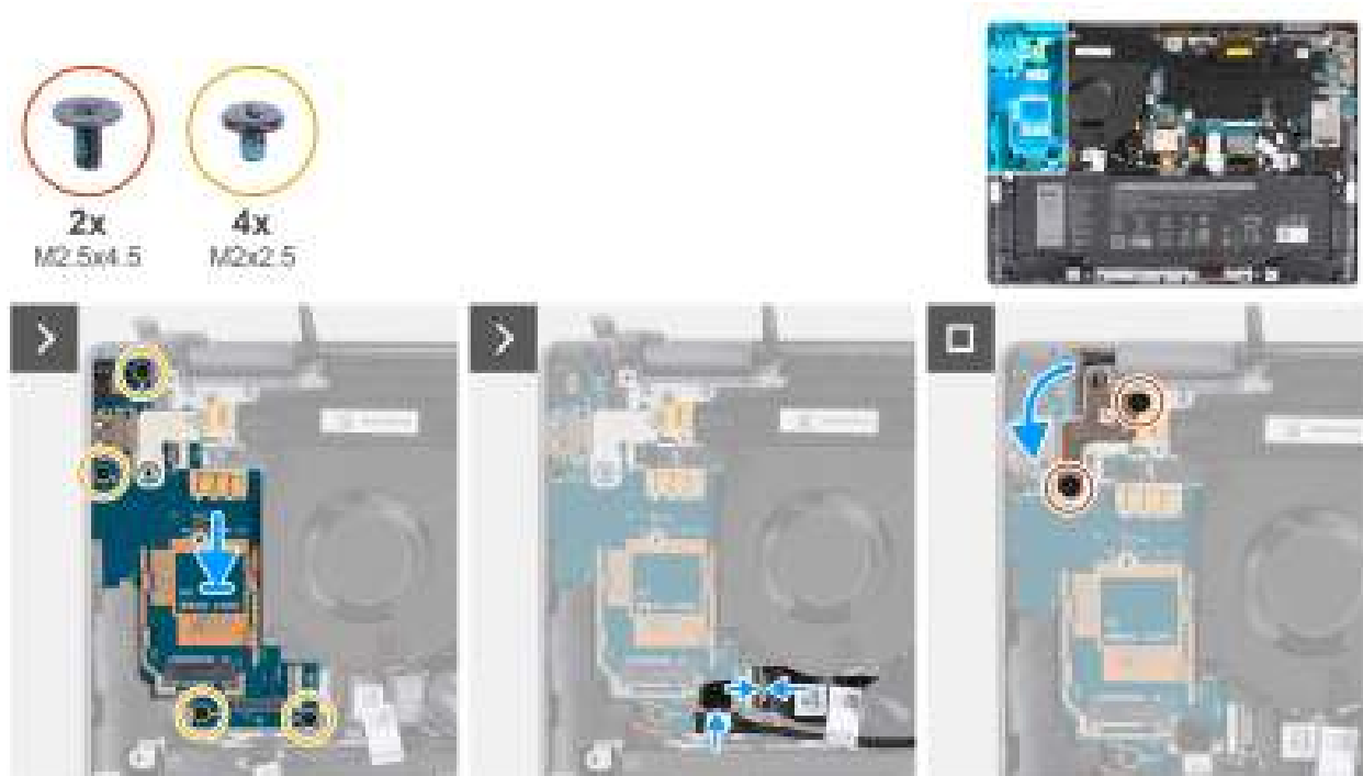
Afbeelding 85. De I/O-kaart plaatsen De I/O-kaart verwijderen (voor computers die worden geleverd met WWAN-ondersteuning)
