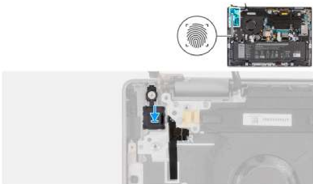
Afbeelding 91. De aan-uitknop met vingerafdrukkezer plaatsen
