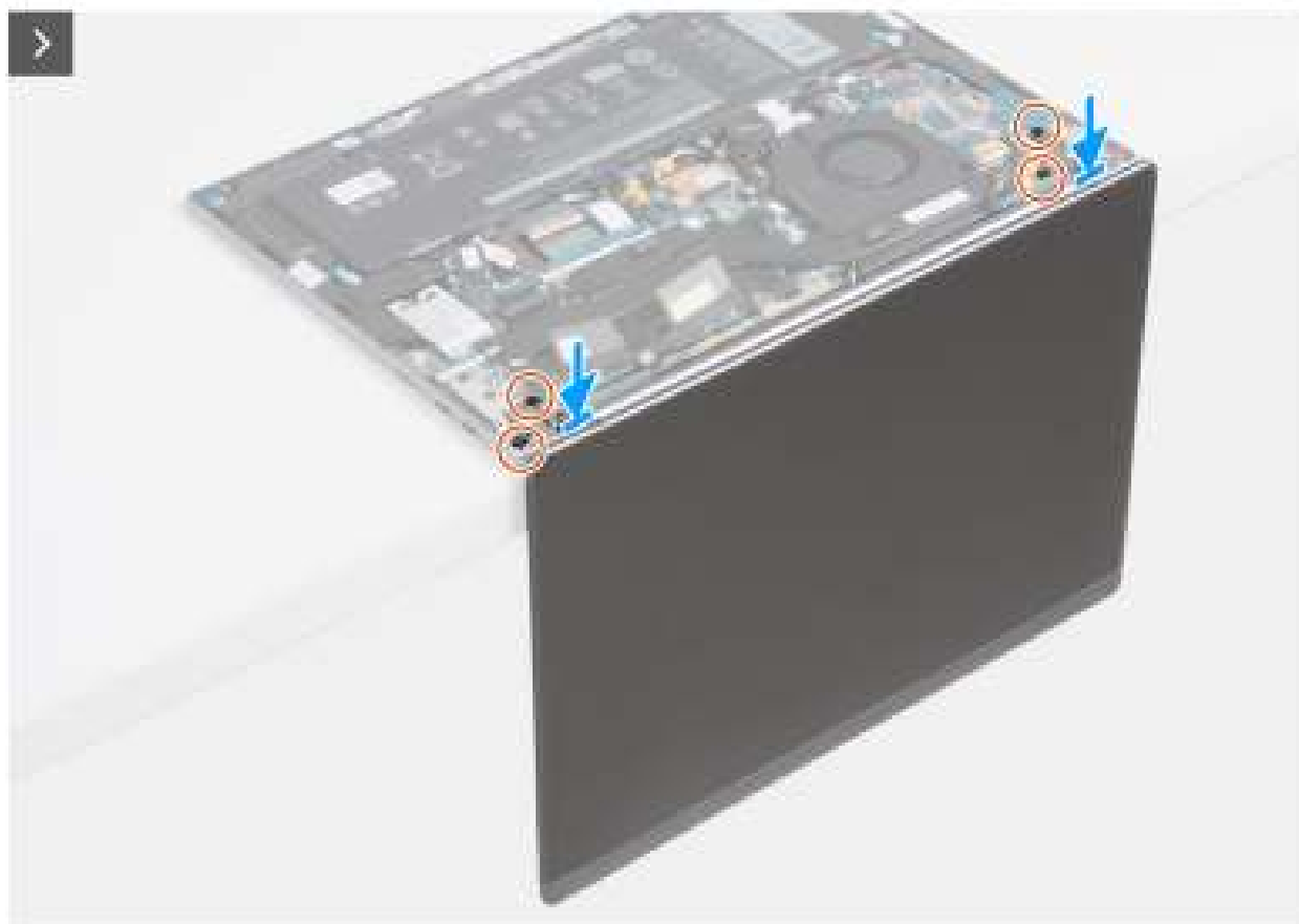
Afbeelding 80. De beeldschermeenheid plaatsen (voor computers die worden geleverd met WWAN-ondersteuning)
