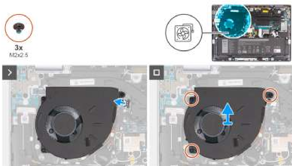
Afbeelding 35. De ventilator verwijderen (voor computers die worden geleverd met alleen WLAN-ondersteuning)
