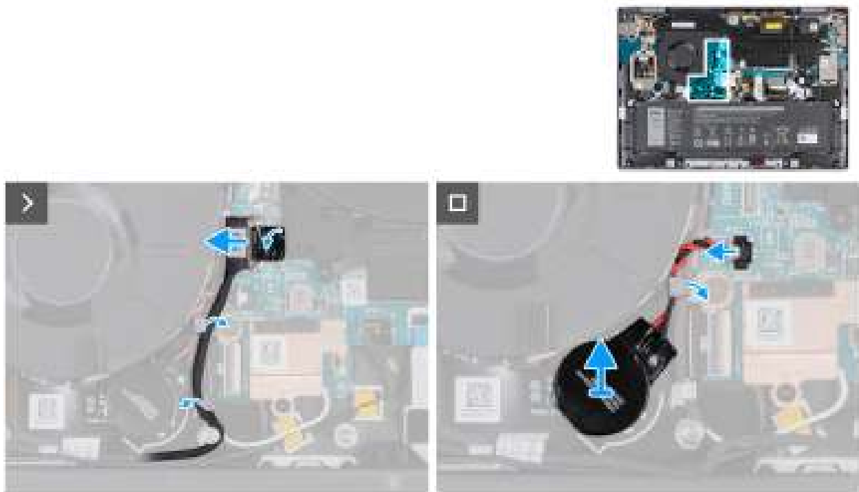
Afbeelding 46. De knoopcelbatterij verwijderen
