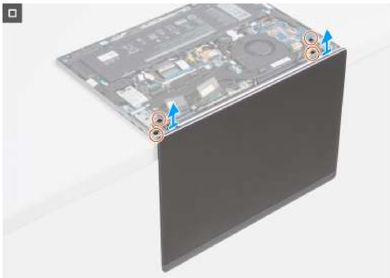
Afbeelding 78. De beeldschermeenheid verwijderen (voor computers die worden geleverd met WWAN-ondersteuning)
