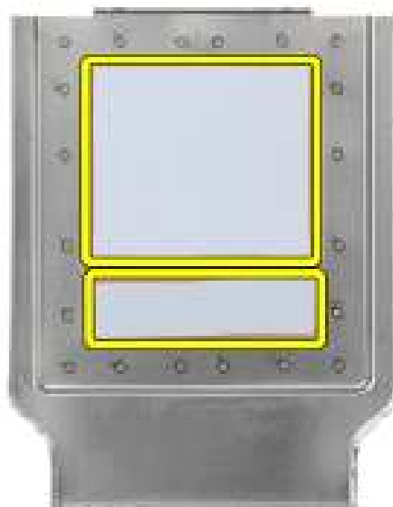
Afbeelding 30. Thermische pads aan de onderkant van het thermische WWAN-schild
