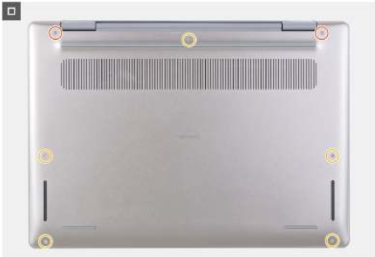
Afbeelding 20. De schroeven terugplaatsen en vastdraaien
