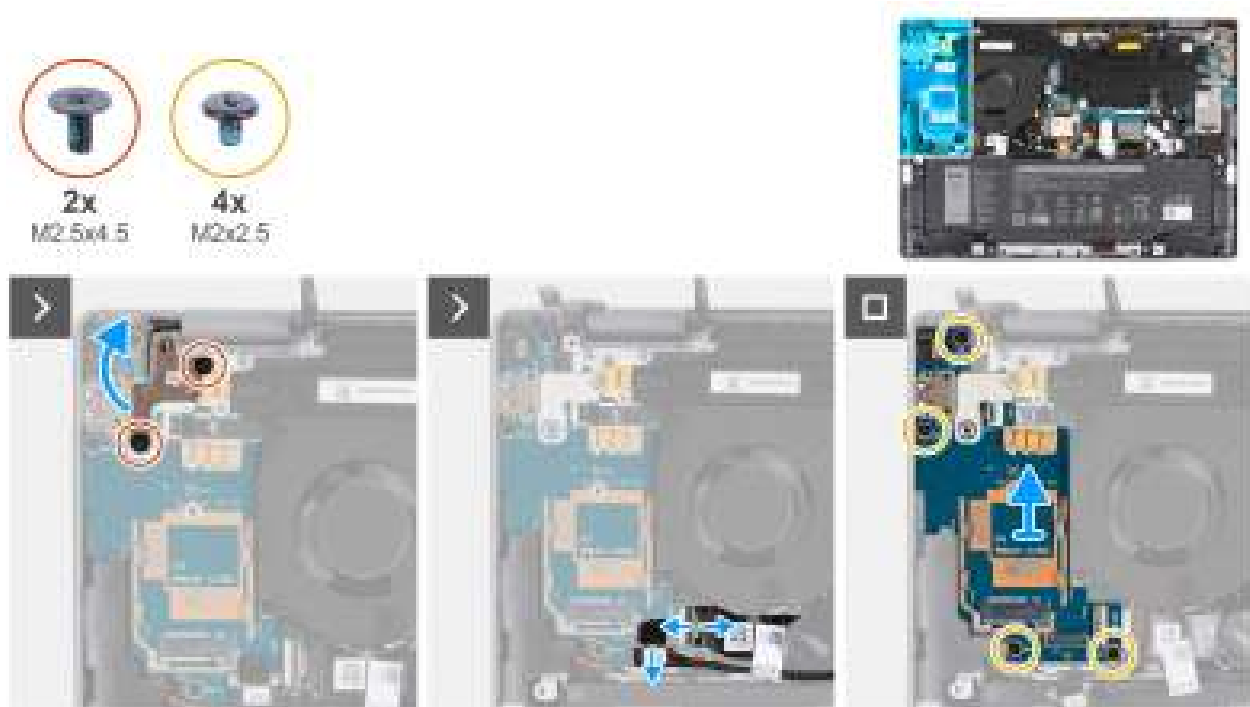
Afbeelding 84. De I/O-kaart verwijderen (voor computers die worden geleverd met WWAN-ondersteuning)
