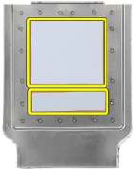
Afbeelding 27. Thermische pads aan de onderkant van het thermische schild van de WWAN-kaart
