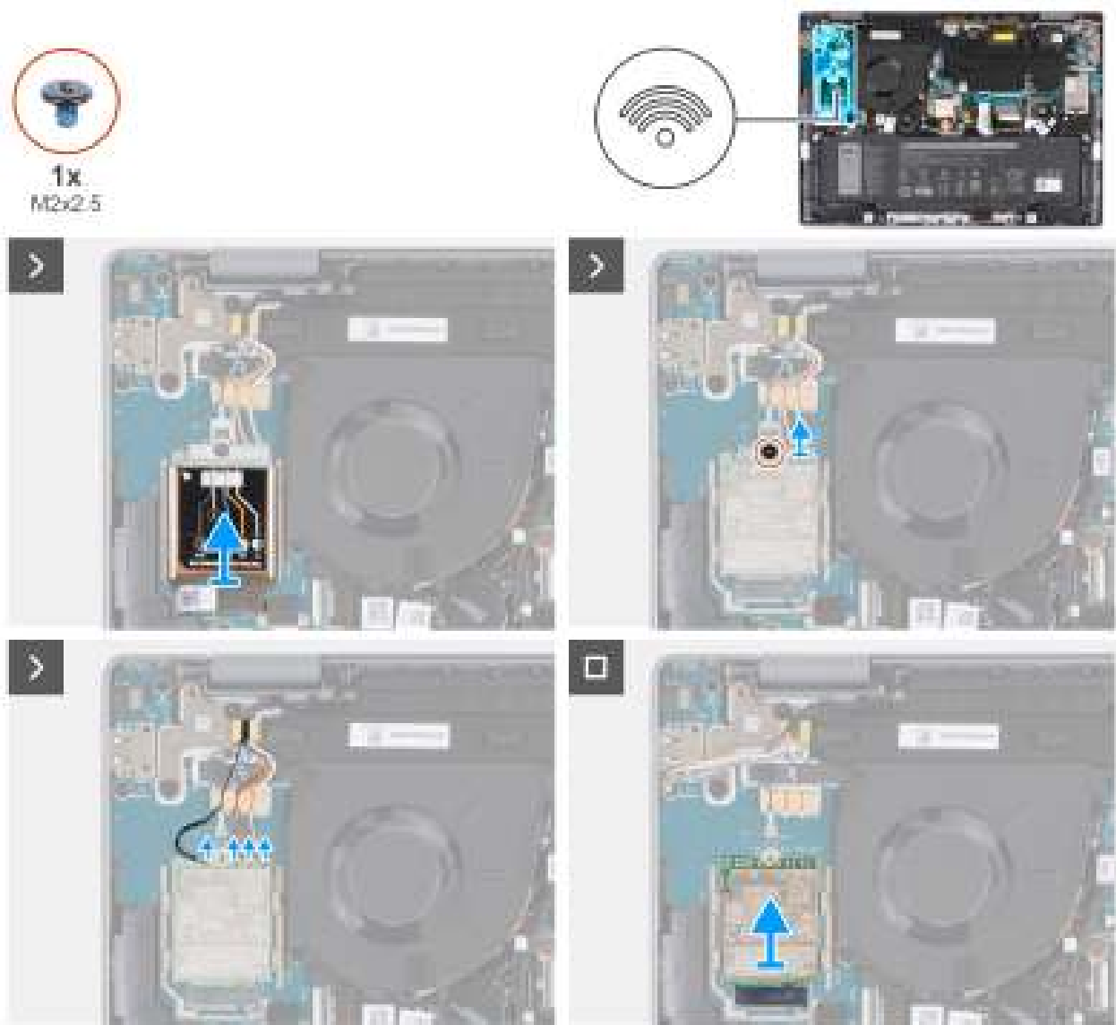
Afbeelding 26. De 5G WWAN-kaart verwijderen
