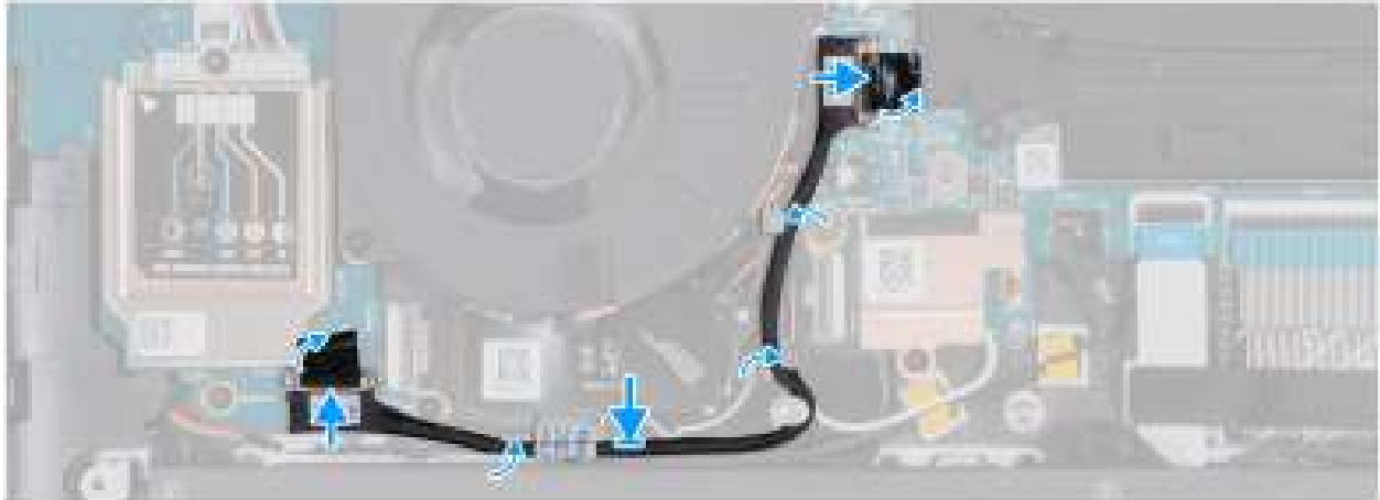
Afbeelding 55. De kabel van de I/O-kaart plaatsen (voor computers die worden geleverd met WWAN-ondersteuning)
