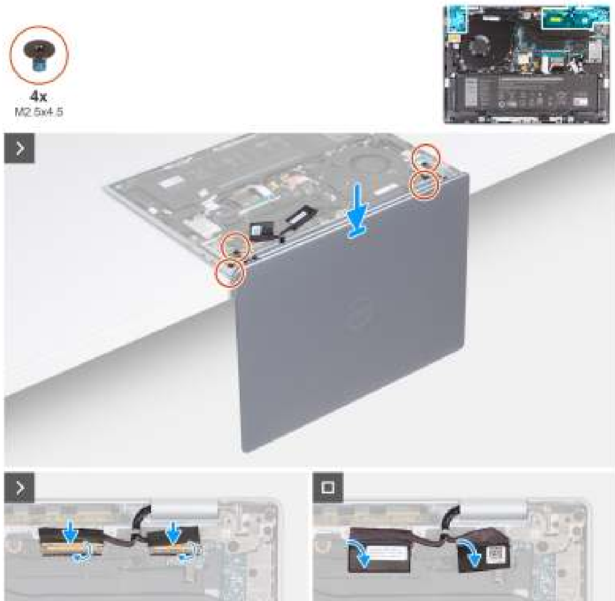
Afbeelding 76. De beeldscherm eenheid plaatsen (voor computers die worden geleverd met alleen WLAN-ondersteuning)
