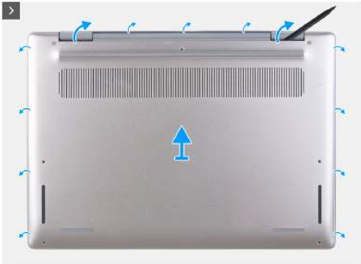
Afbeelding 16. De onderplaat verwijderen
