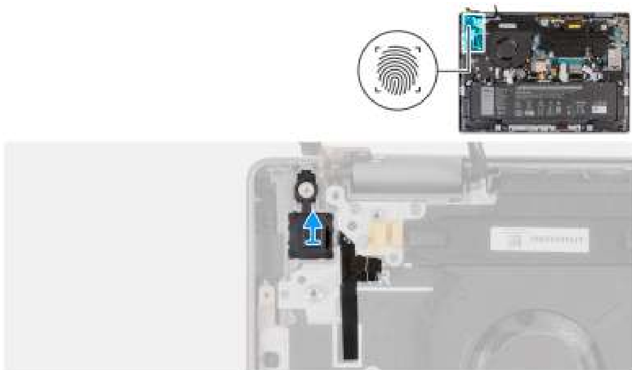
Afbeelding 89. De aan-uitknop met vingerafdrukkezer verwijderen
