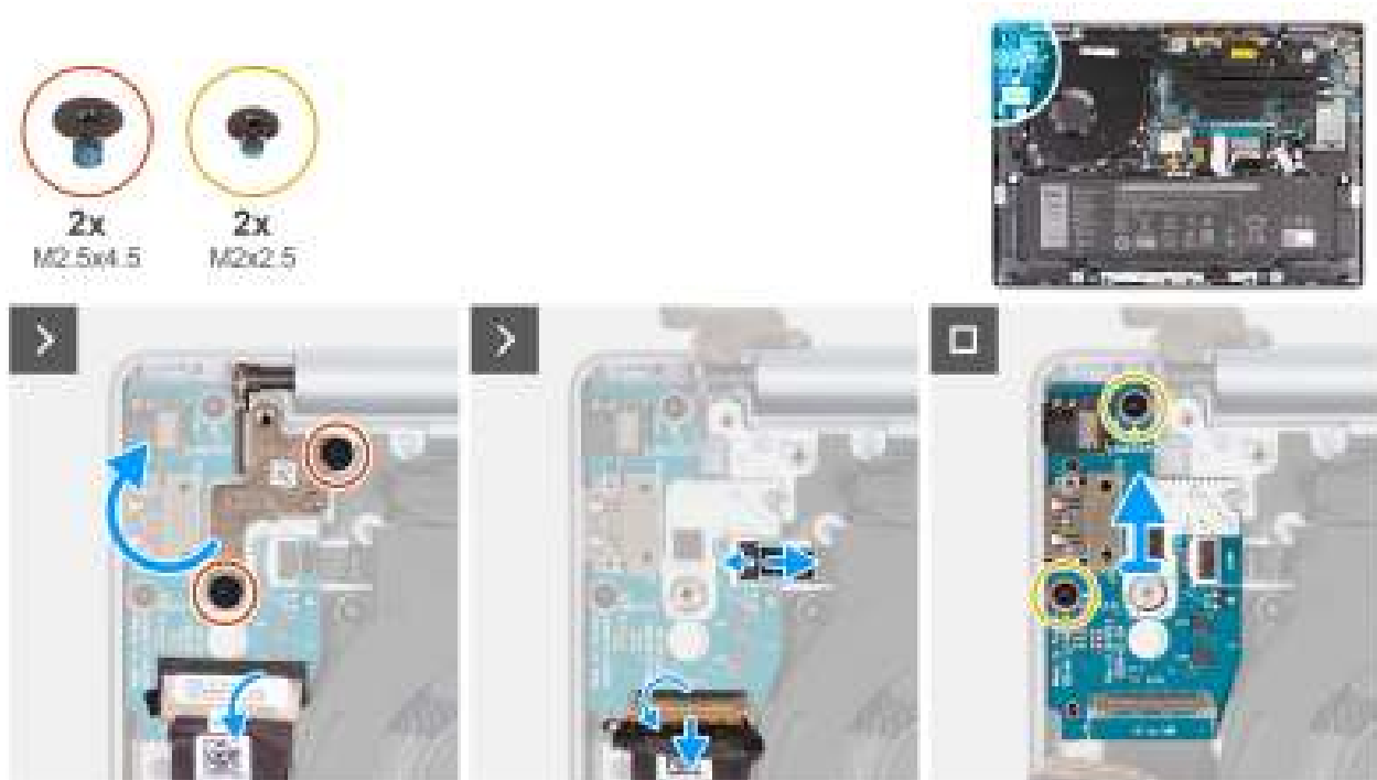
Afbeelding 82. De I/O-kaart verwijderen (voor computers die worden geleverd met alleen WLAN-ondersteuning)
