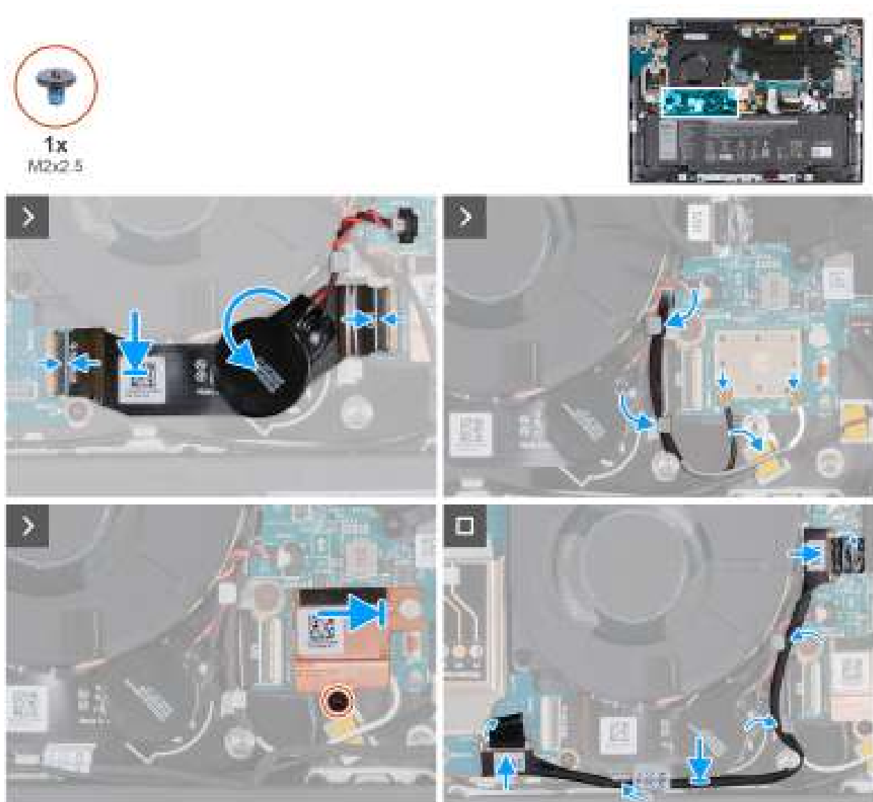
Afbeelding 57. De FPC-kabel van de I/O-kaart plaatsen
