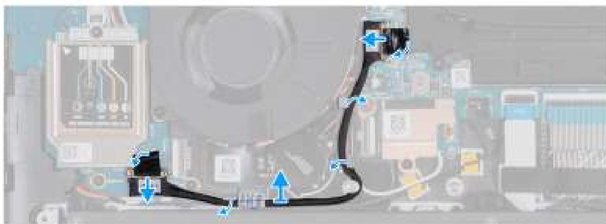
Afbeelding 53. De kabel van de I/O-kaart verwijderen (voor computers die worden geleverd met WWAN-ondersteuning)
