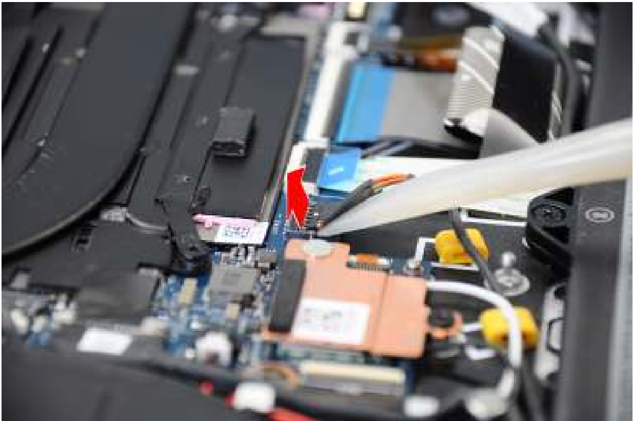
Afbeelding 32. De luidsprekerkabel loswrikken van de connector
