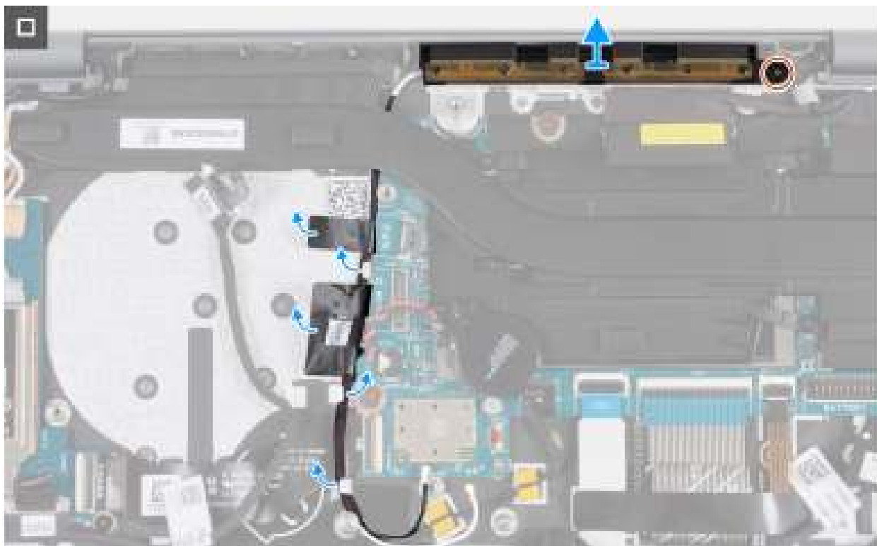
Afbeelding 66. De WLAN-antennemodule verwijderen
