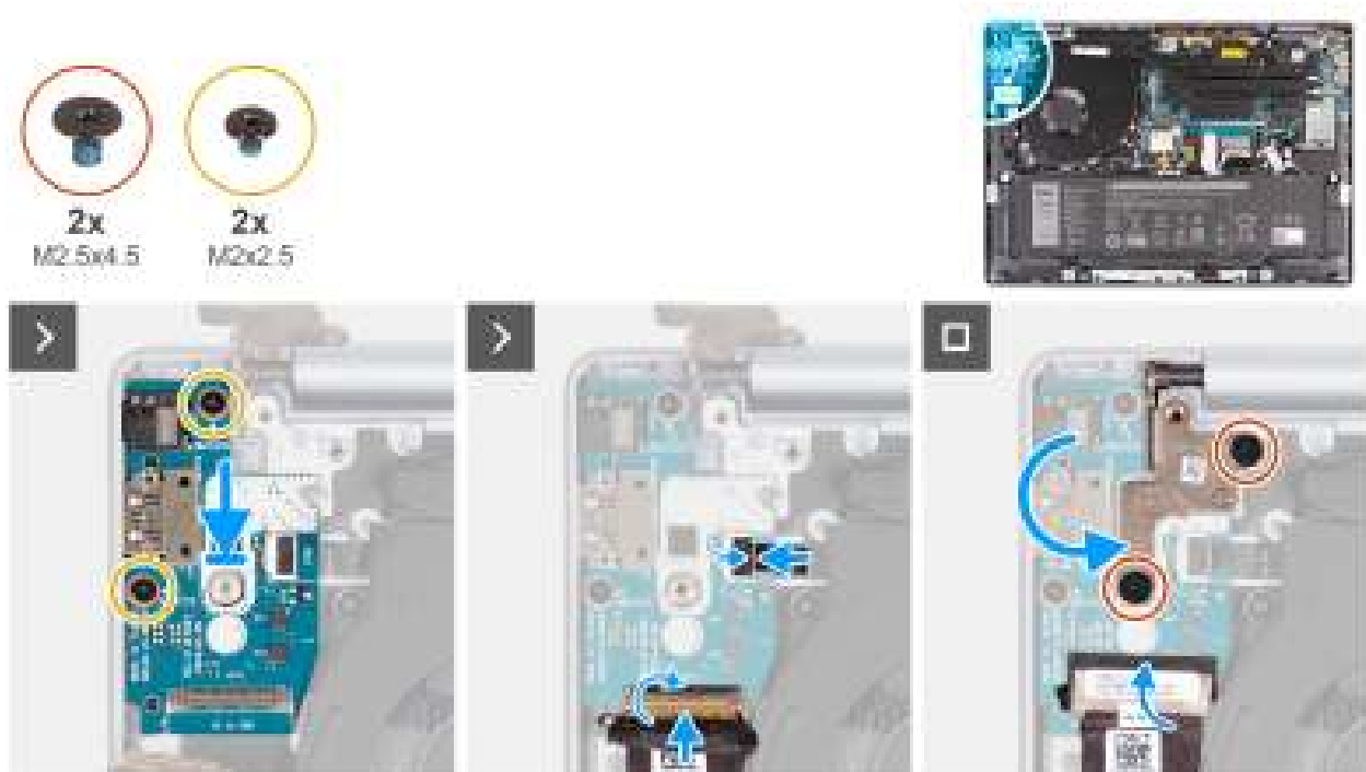
Afbeelding 83. De I/O-kaart plaatsen (voor computers die worden geleverd met alleen WLAN-ondersteuning)
