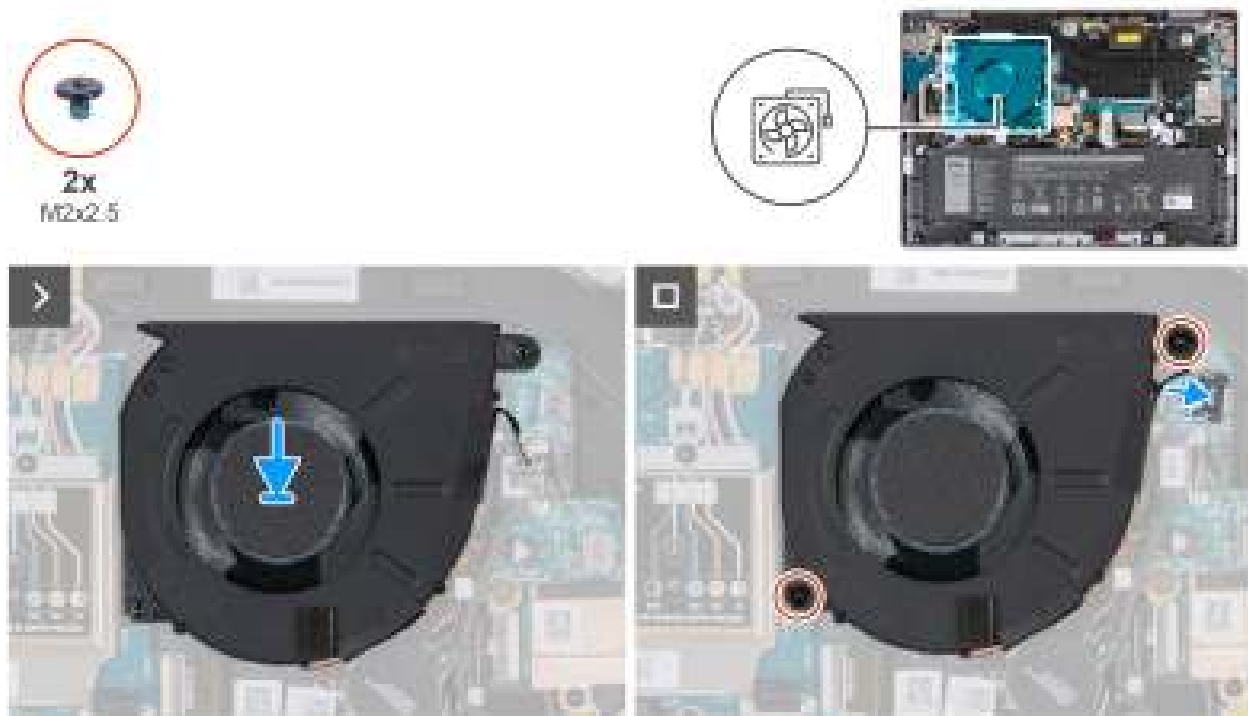
Afbeelding 38. De ventilator plaatsen (voor computers die worden geleverd met WWAN-ondersteuning)
