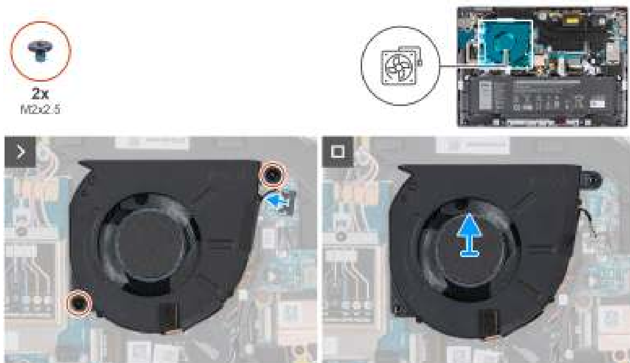
Afbeelding 37. De ventilator verwijderen (voor computers die worden geleverd met WWAN-ondersteuning)
