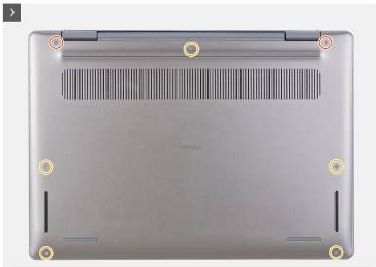
Afbeelding 15. De onderplaat verwijderen
