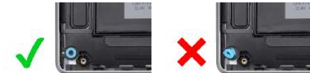
Afbeelding 34. Rubberen dichtingsringen plaatsen
