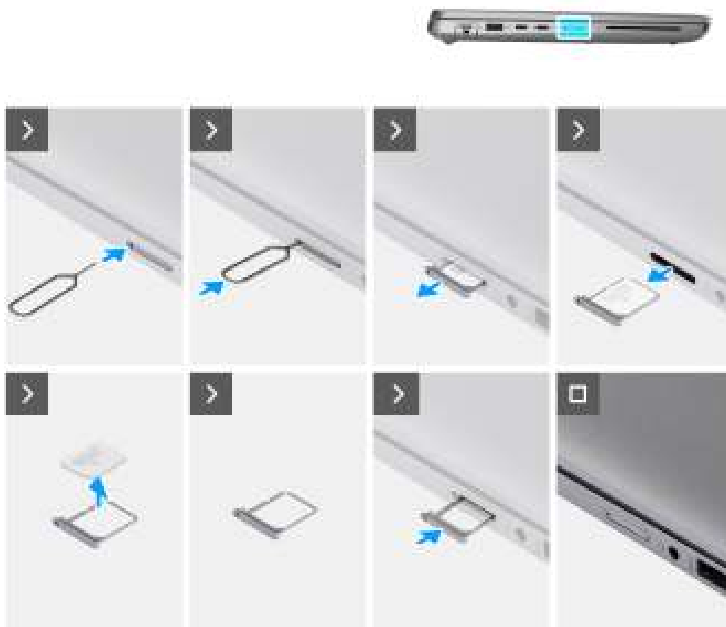
Afbeelding 10. De simkaartlade verwijderen
