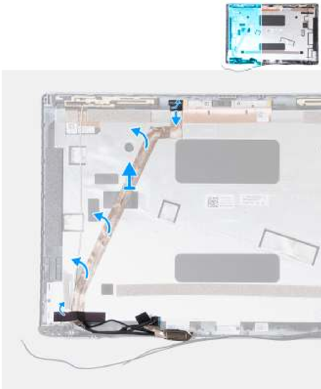
Afbeelding 62. De beeldschermkabel verwijderen
