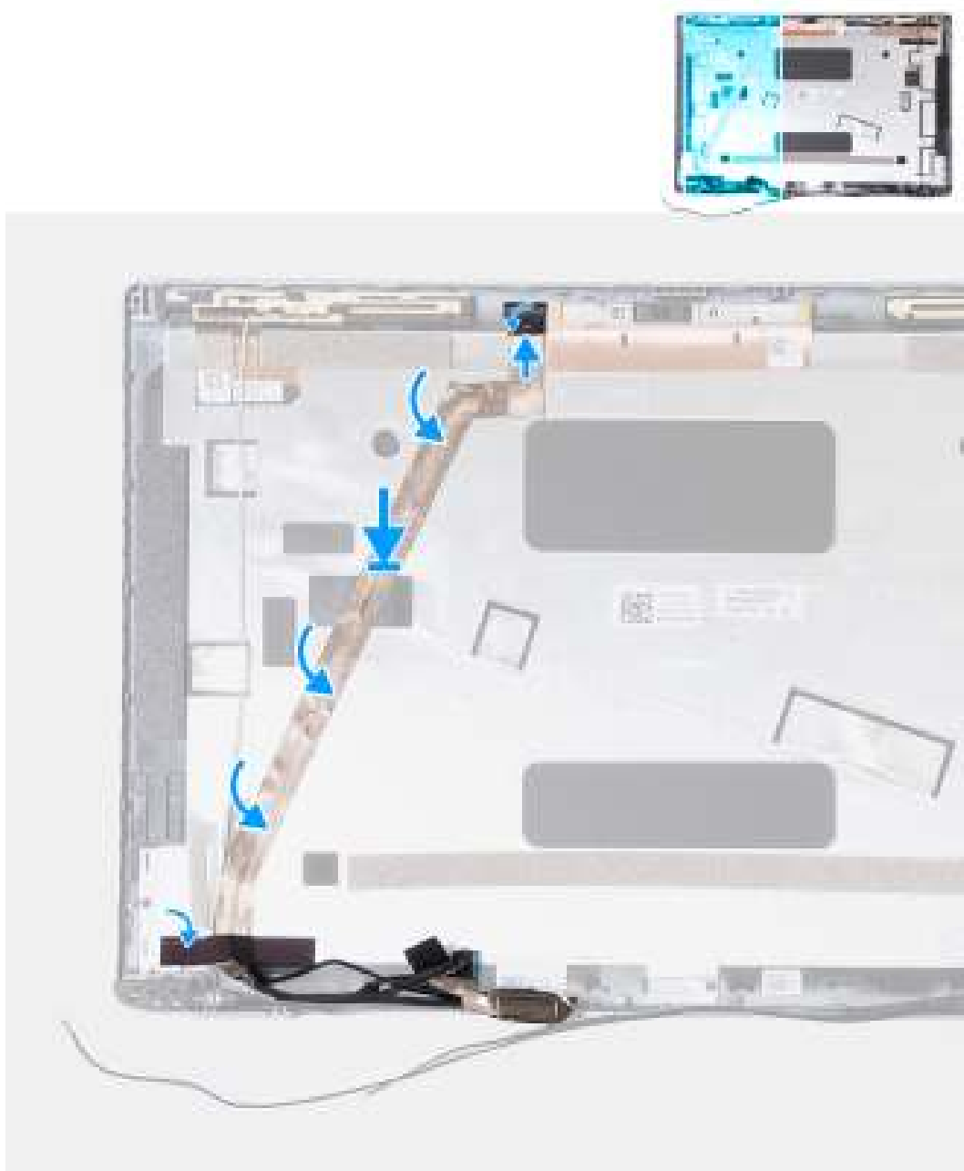
Afbeelding 63. De beeldschermkabel installeren
