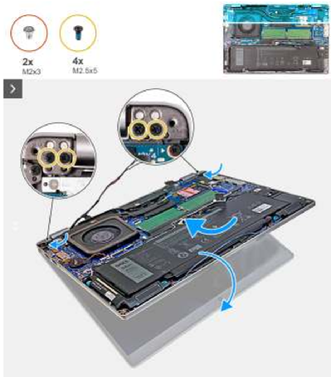
Afbeelding 49. De beeldscherm eenheid installeren - Voor computers die worden geleverd met 5G-kaart
