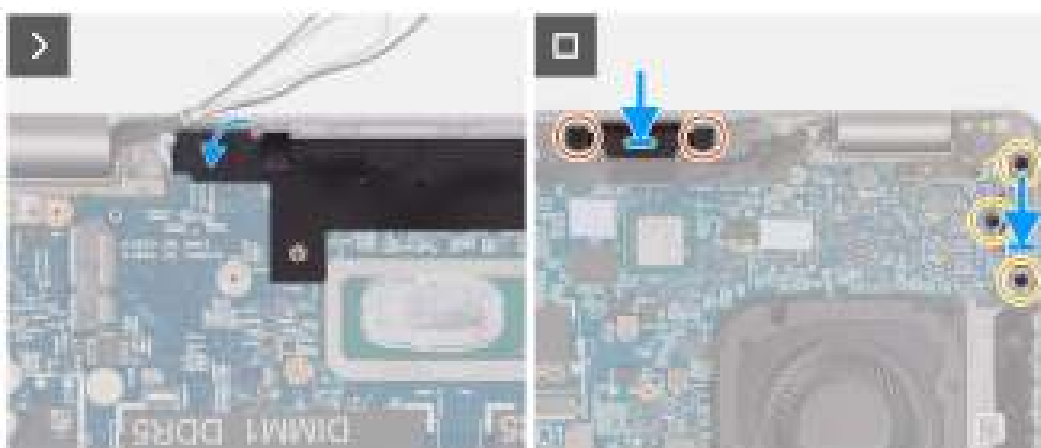
Afbeelding 60. De systeemkaart installeren
