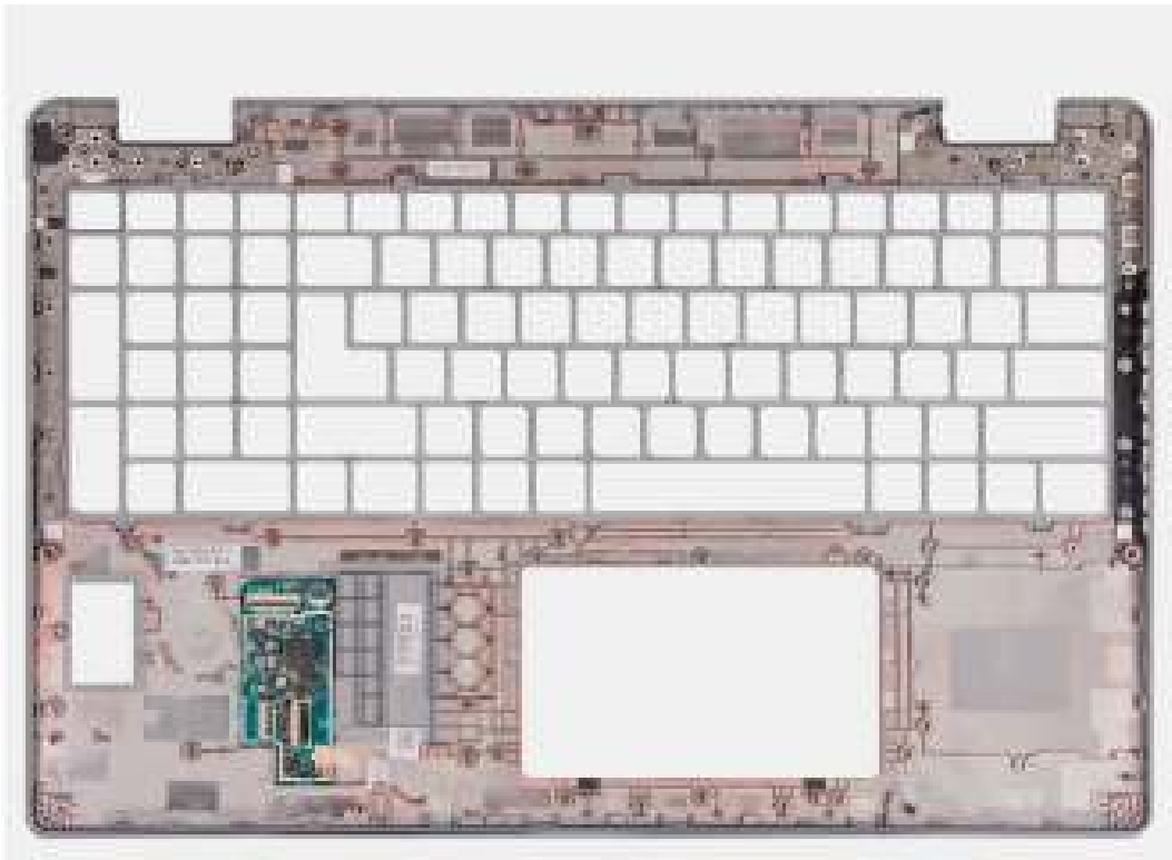
Afbeelding 101. De palmsteuneenheid installeren
