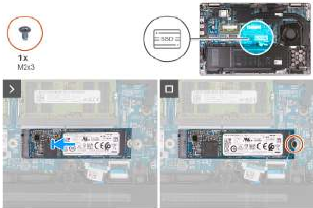
Afbeelding 30. De M.2 2280 SSD in slot 1 installeren
