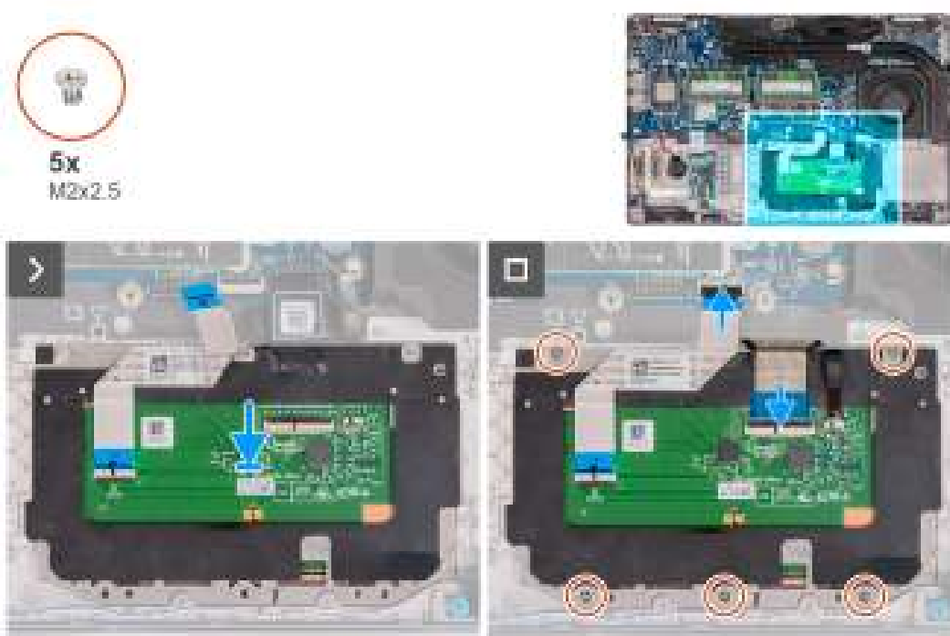
Afbeelding 42. De touchpad installeren
