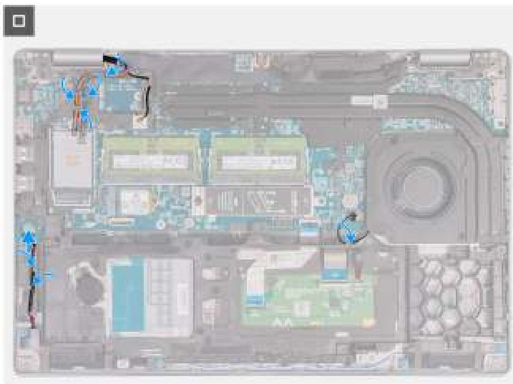
Afbeelding 40. De kabels routeren
