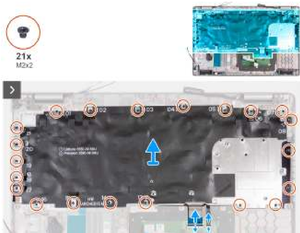
Afbeelding 65. Het toetsenbord verwijderen
