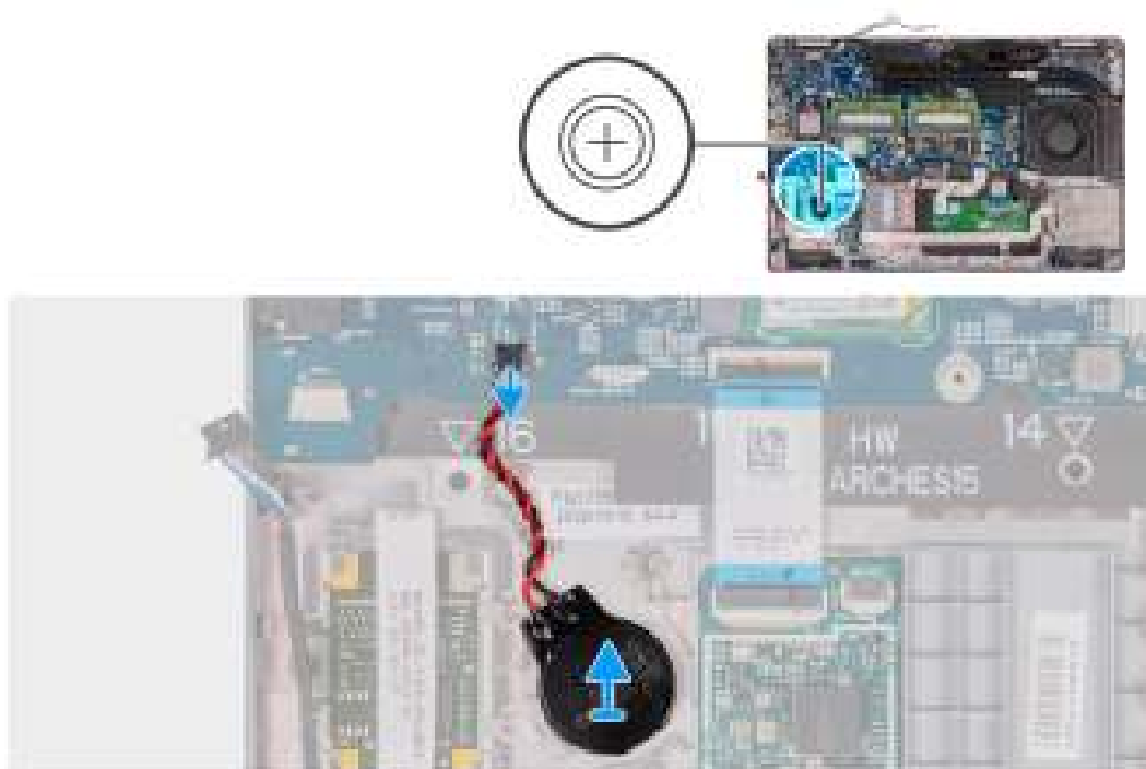
Afbeelding 46. De knoopcelbatterij verwijderen
