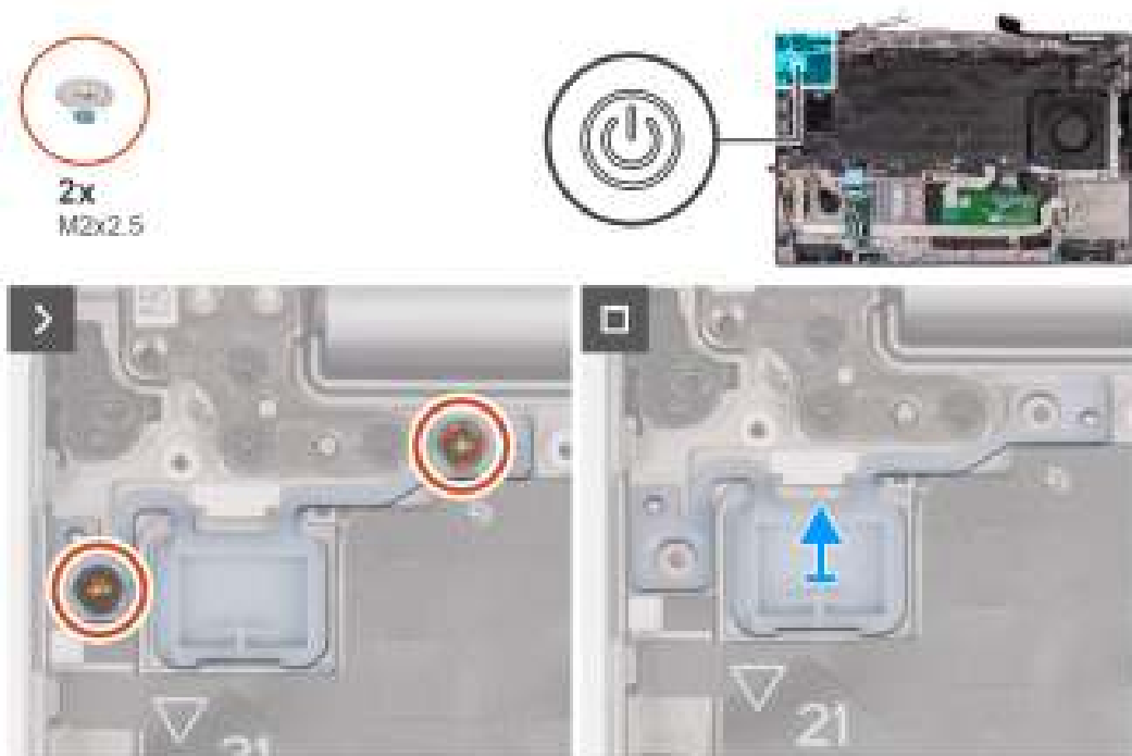
Afbeelding 61. De aan/uit-knop verwijderen
