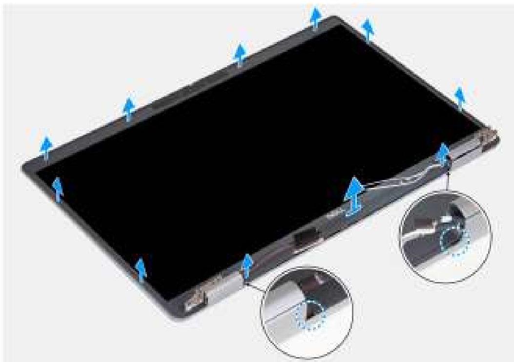
Afbeelding 74. De beeldschermbezel verwijderen
