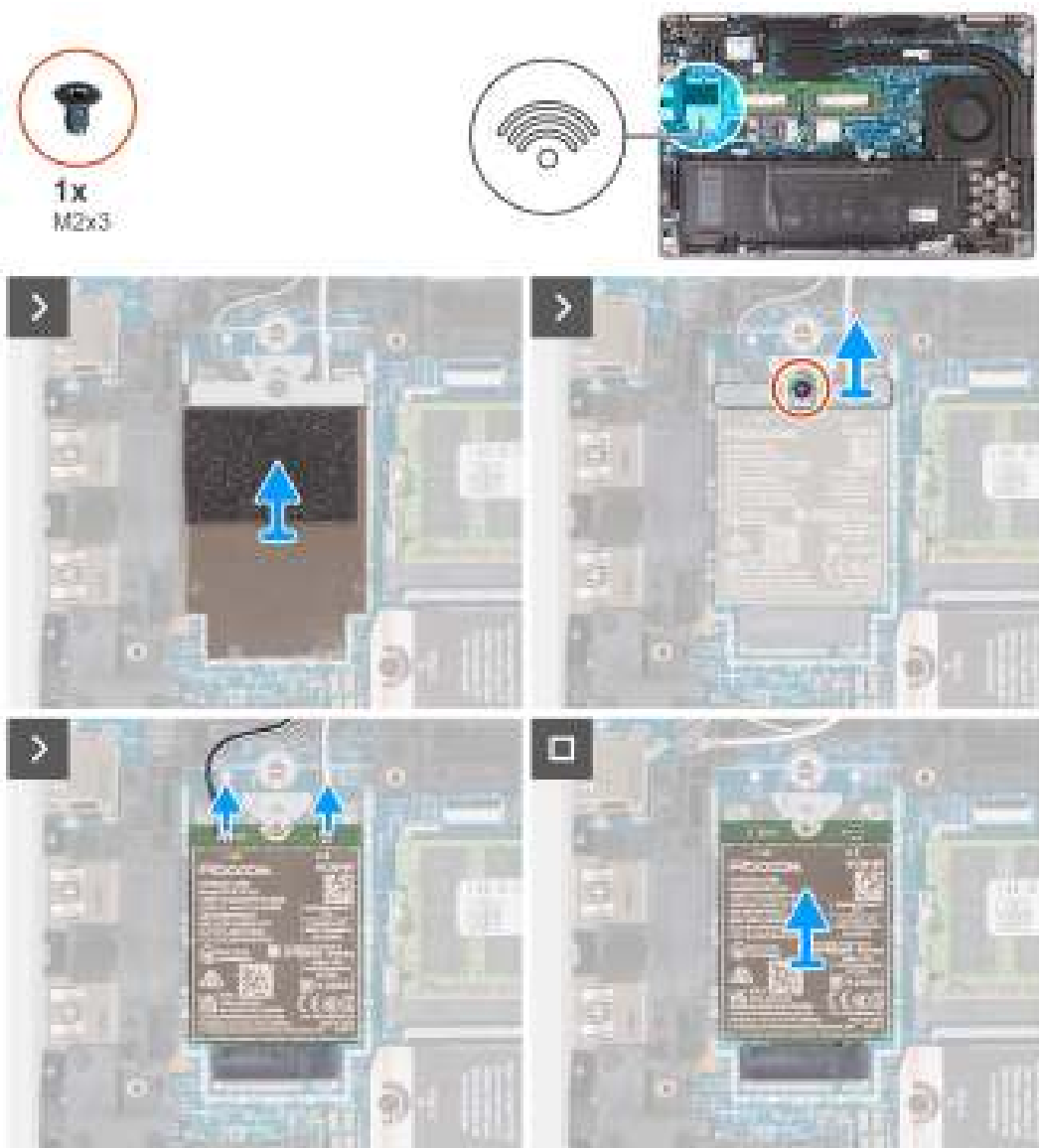
Afbeelding 21. De 4G WWAN-kaart verwijderen
