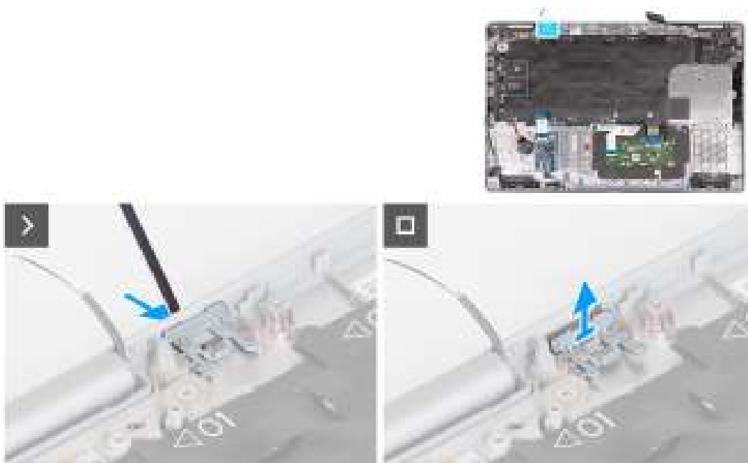
Afbeelding 98. De dummy simkaartslotvuller verwijderen
