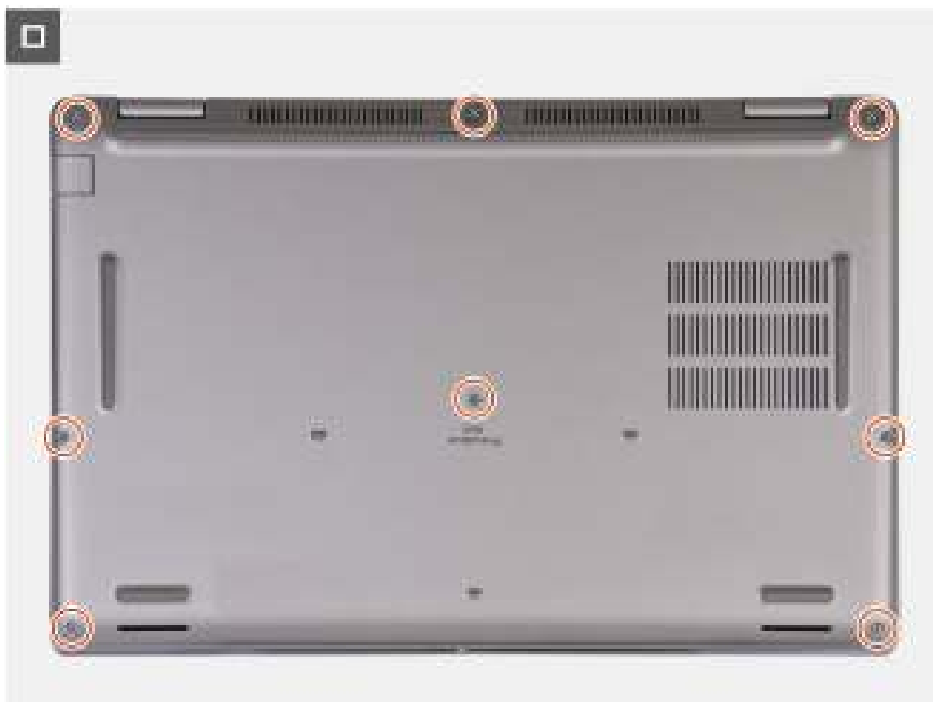
Afbeelding 18. De geborgde schroeven vastdraaien
