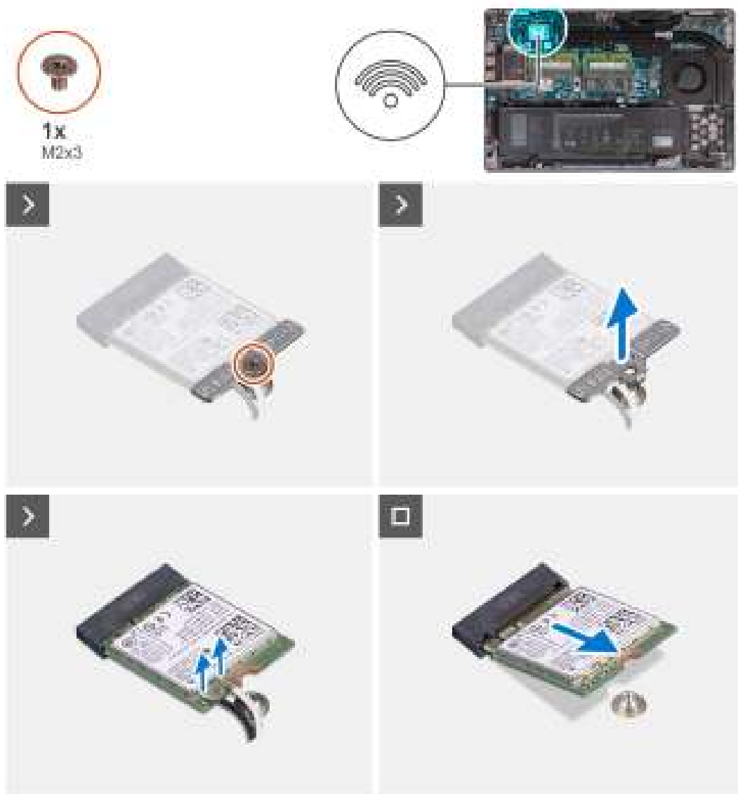
Afbeelding 19. De draadloze kaart verwijderen
