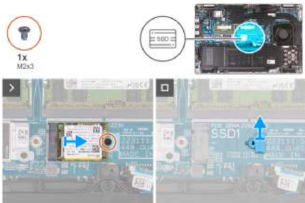
Afbeelding 27. De M.2 2230 SSD verwijderen uit slot 1
