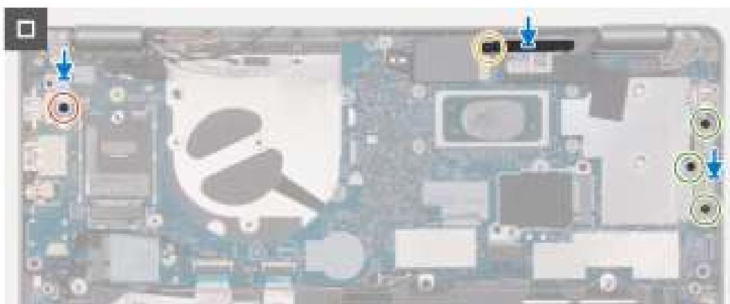
Afbeelding 51. De systeemkaart installeren
