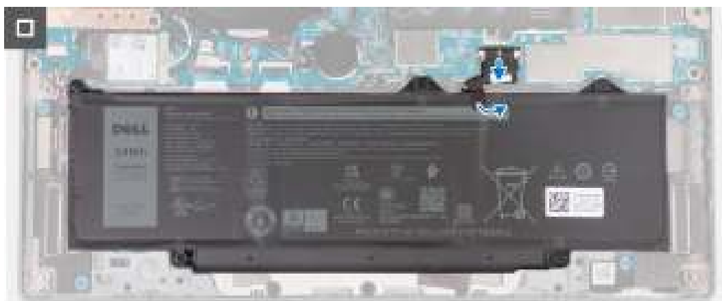
Afbeelding 19. De batterijkabel van de systeemkaart loskoppelen
