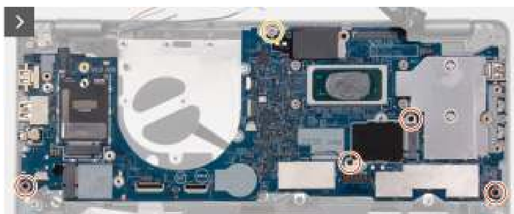
Afbeelding 46. De systeemkaart verwijderen
