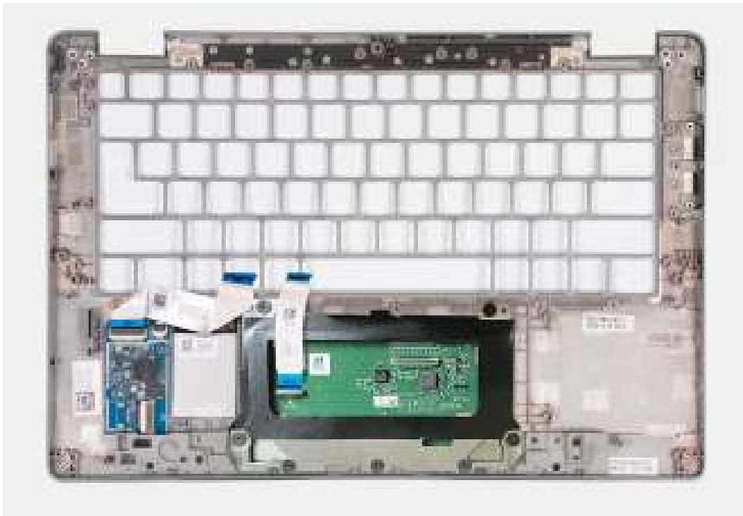
Afbeelding 93. De palmsteun plaatsen
