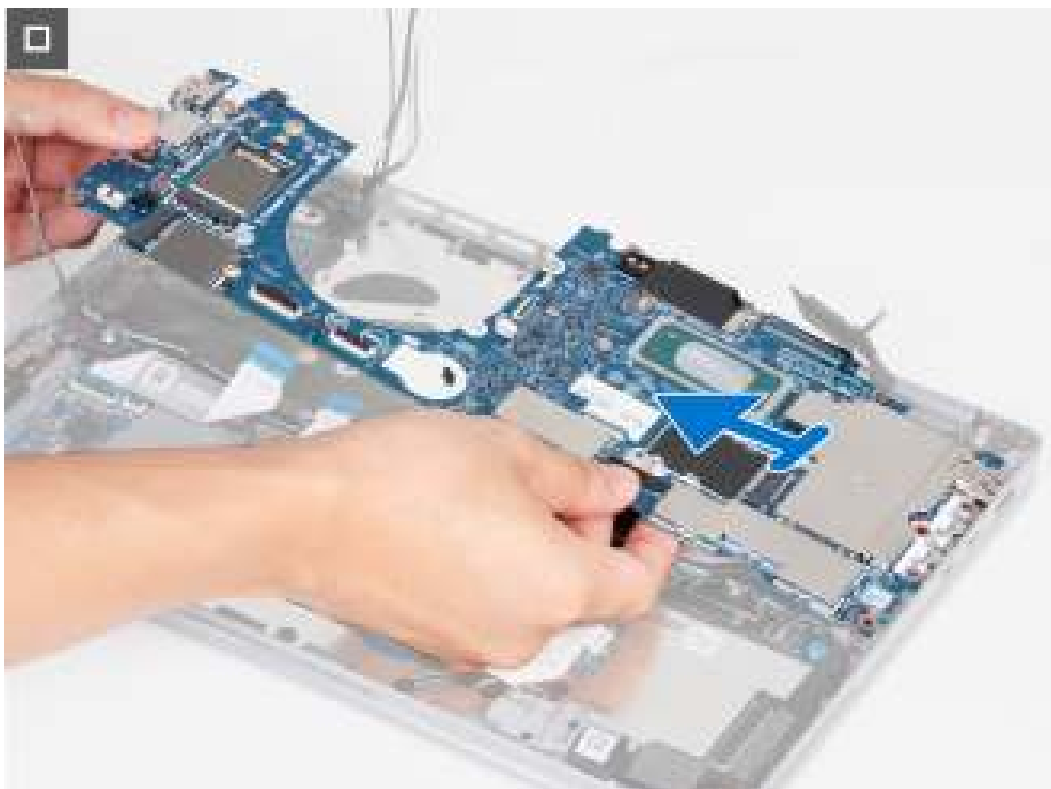
Afbeelding 47. De systeemkaart verwijderen
