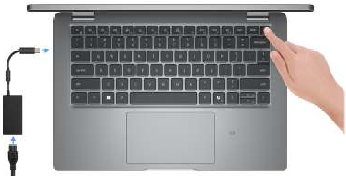
Afbeelding 12. Sluit de netadapter aan en druk op de aan-uitknop.
