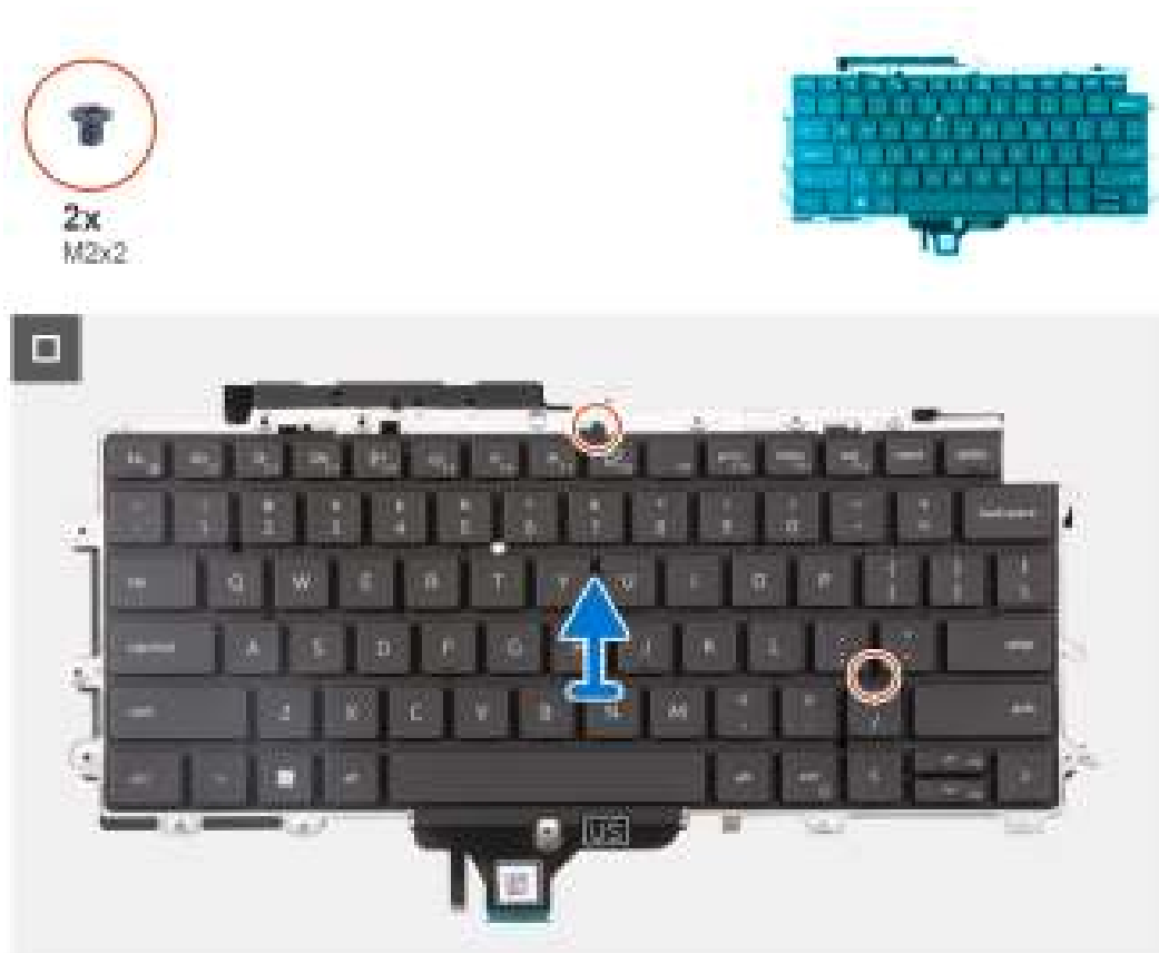
Afbeelding 60. De toetsenbordeenheid verwijderen
