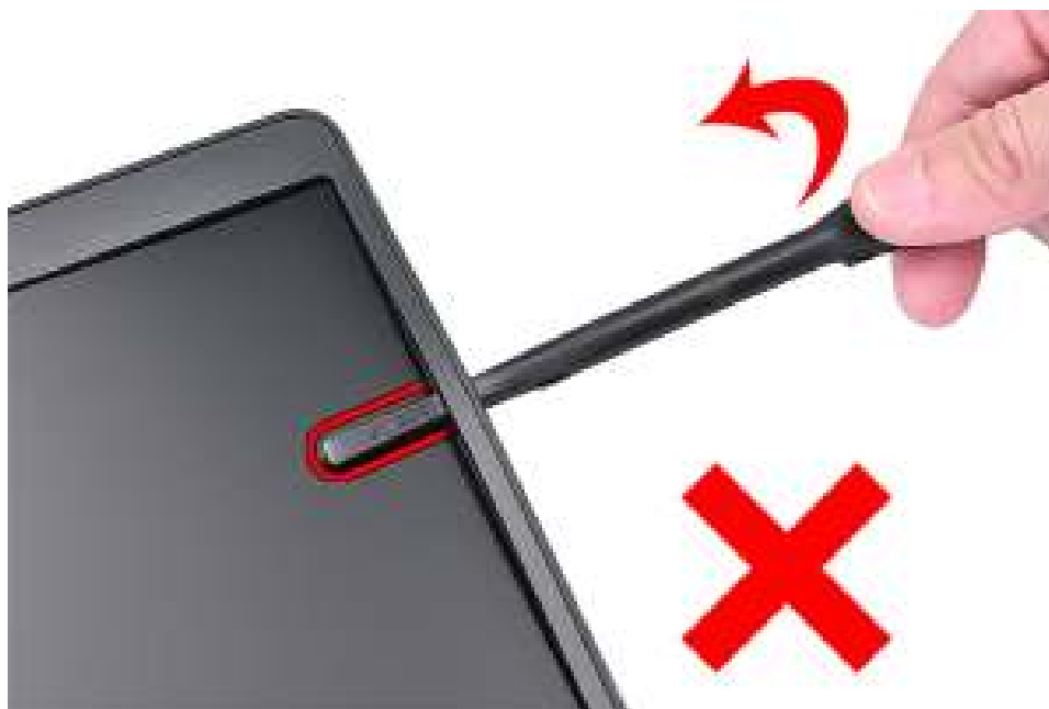
Afbeelding 68. De beeldschermbezel loswrikken (laptop)
