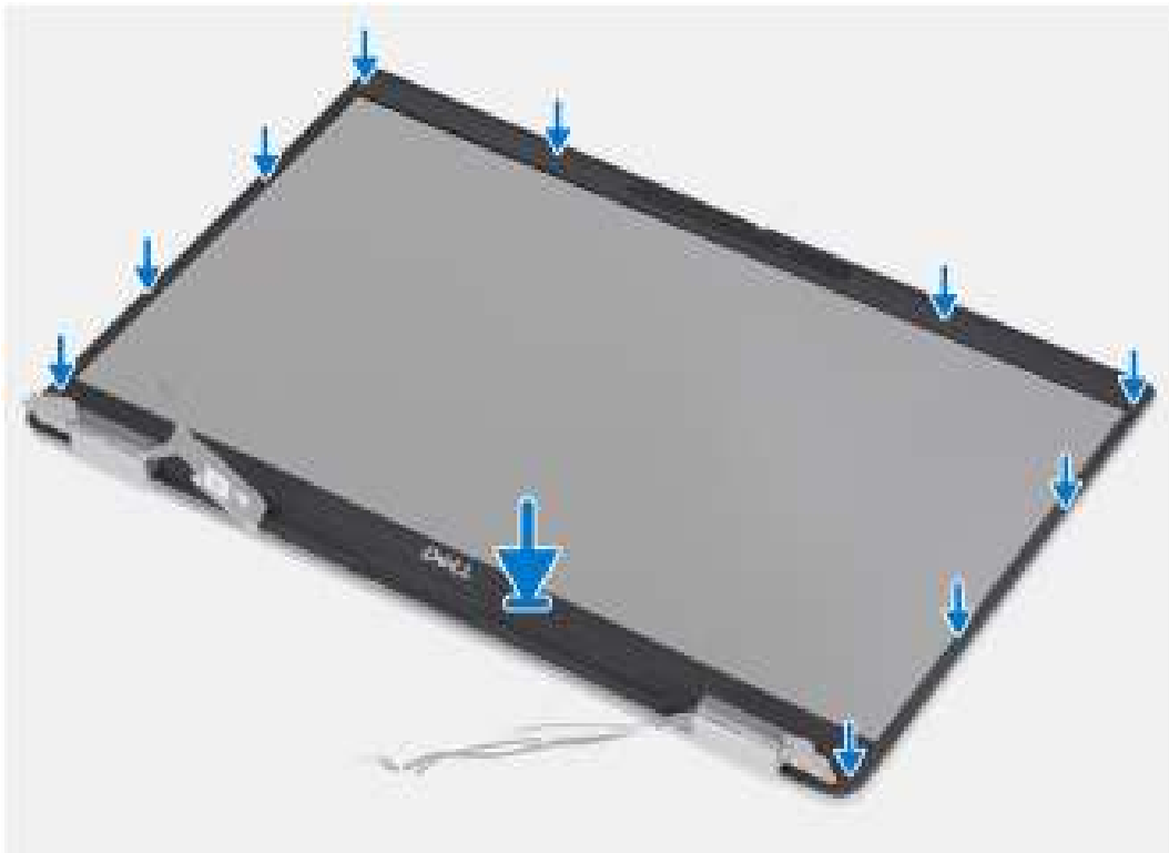
Afbeelding 69. De beeldschermbezel installeren (laptop)
