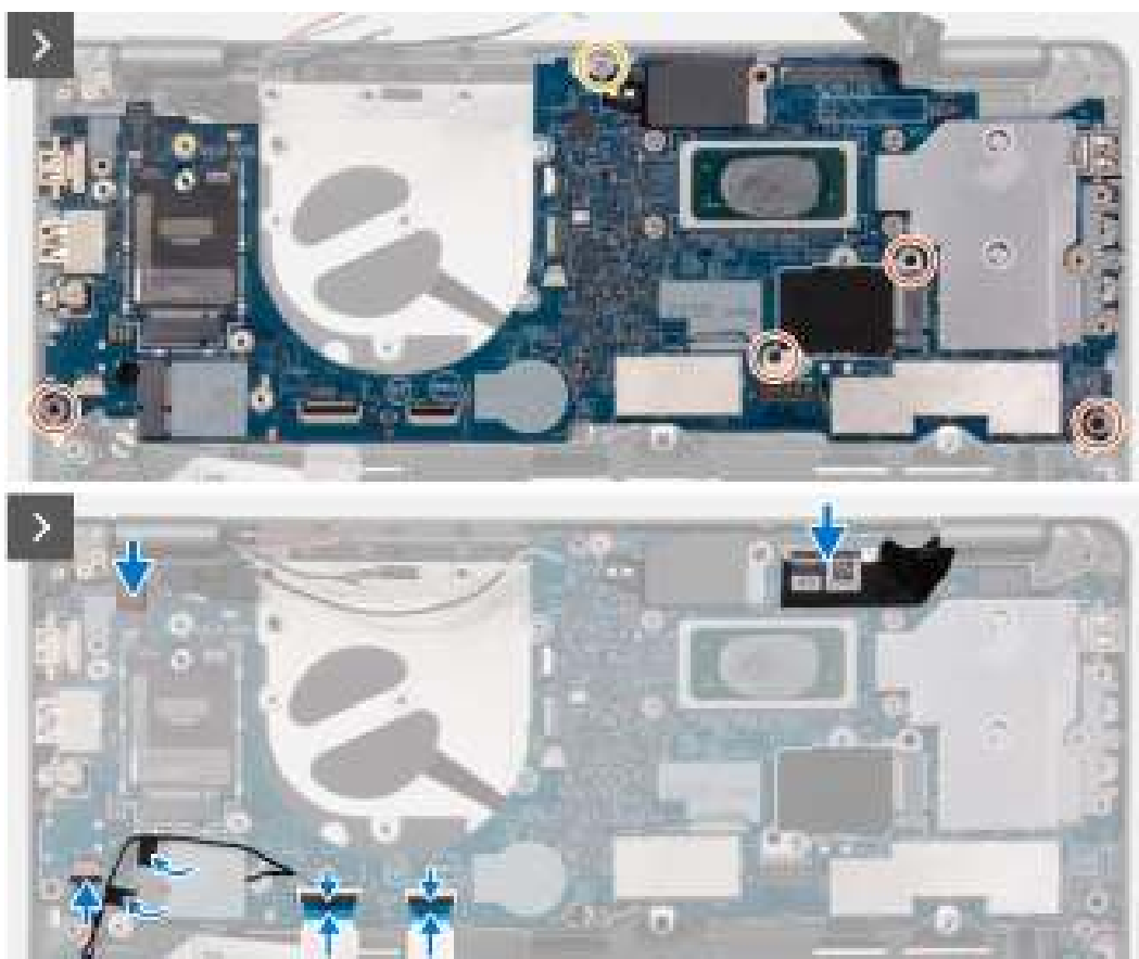
Afbeelding 50. De systeemkaart installeren
