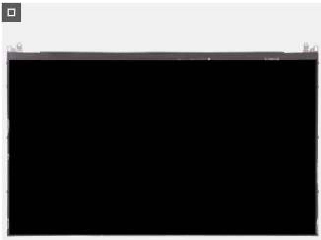
Afbeelding 76. Het beeldschermpaneel verwijderen (laptop)
