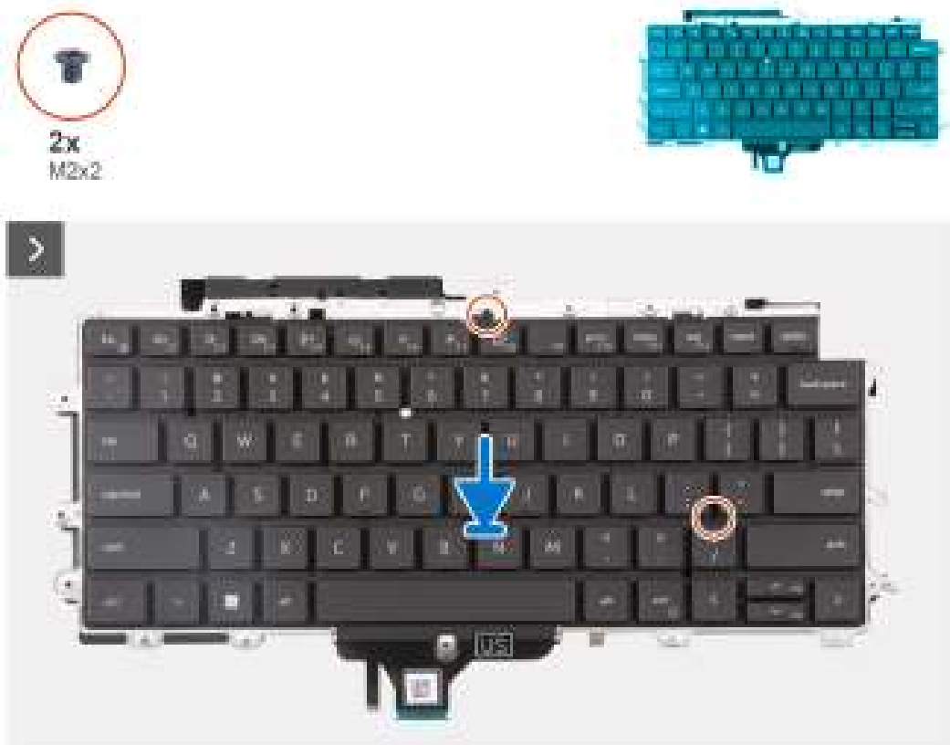
Afbeelding 61. De toetsenbordeenheid installeren
