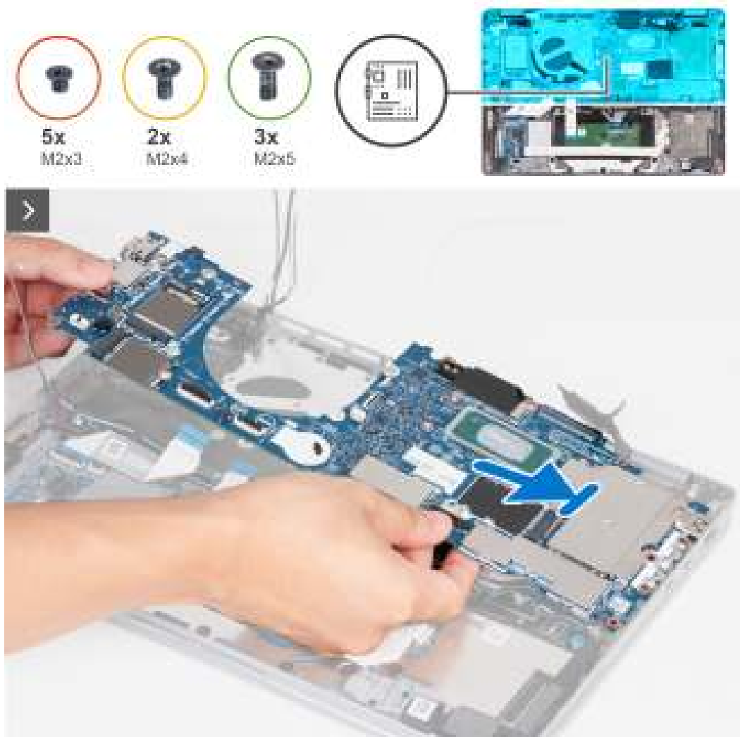
Afbeelding 49. De systeemkaart installeren
