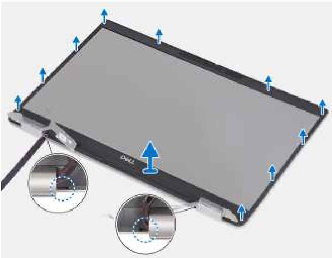
Afbeelding 67. De beeldschermbezel verwijderen (laptop)
