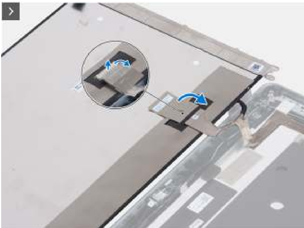
Afbeelding 75. Het beeldschermpaneel verwijderen (laptop)
