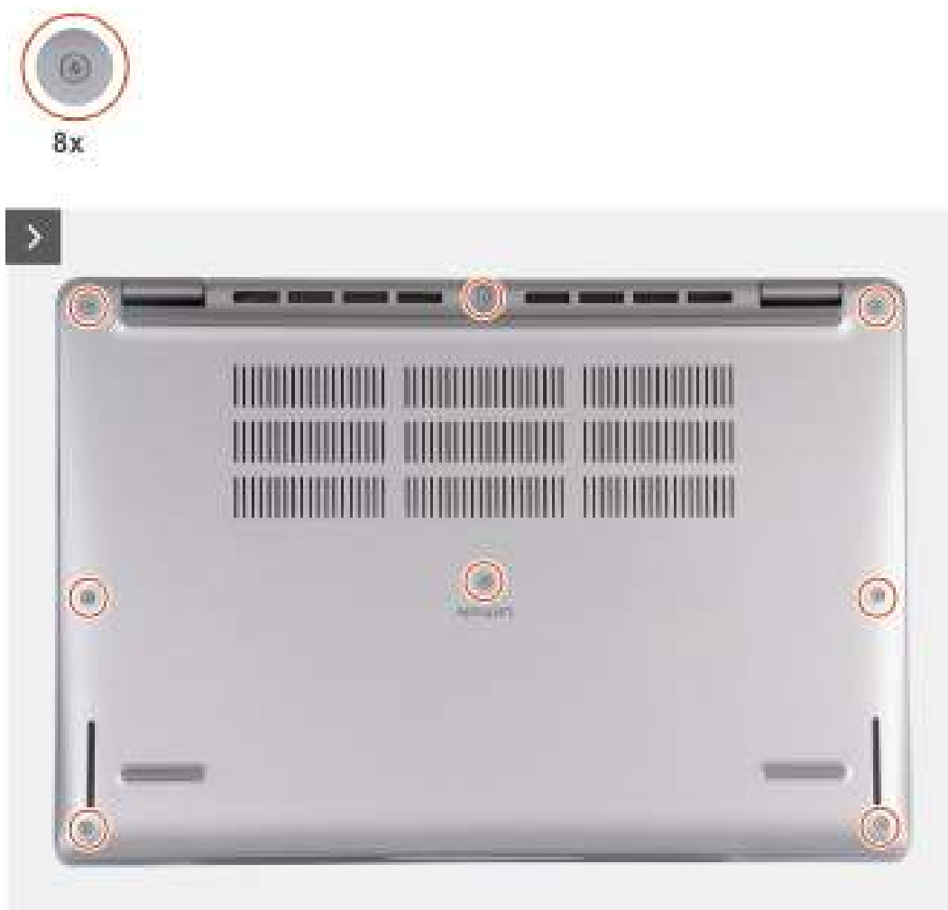
Afbeelding 17. Draai de acht geborgde schroeven los waarmee de onderplaat aan de palmsteuneenheid is bevestigd
