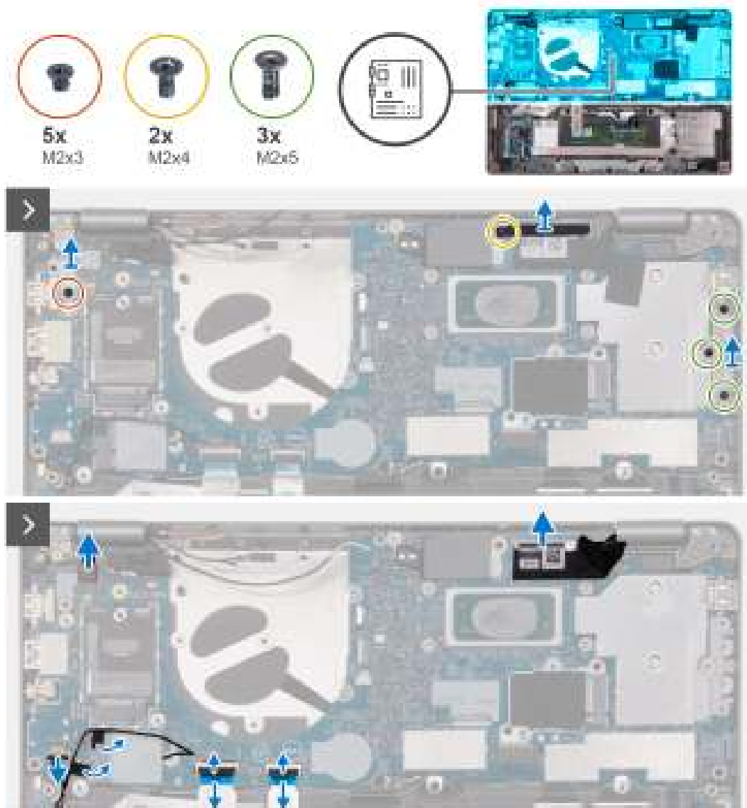
Afbeelding 45. De systeemkaart verwijderen
