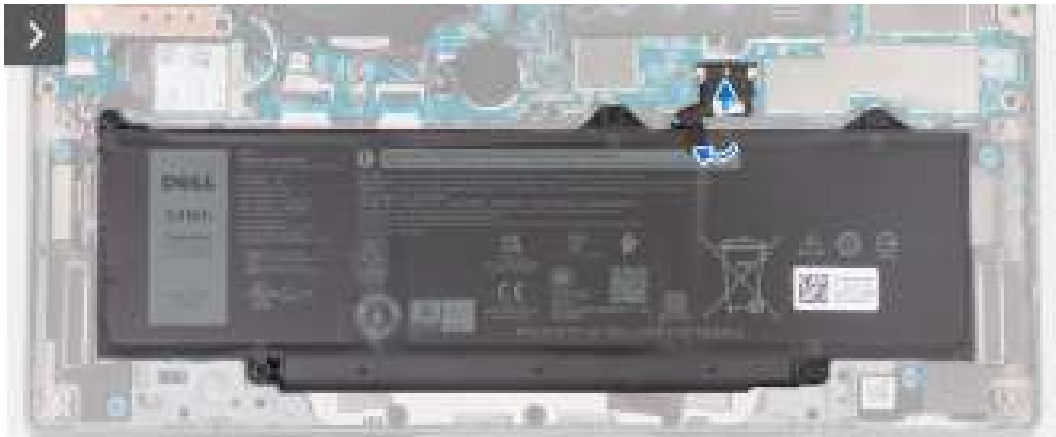
Afbeelding 20. De batterijkabel op de systeemkaart aansluiten
