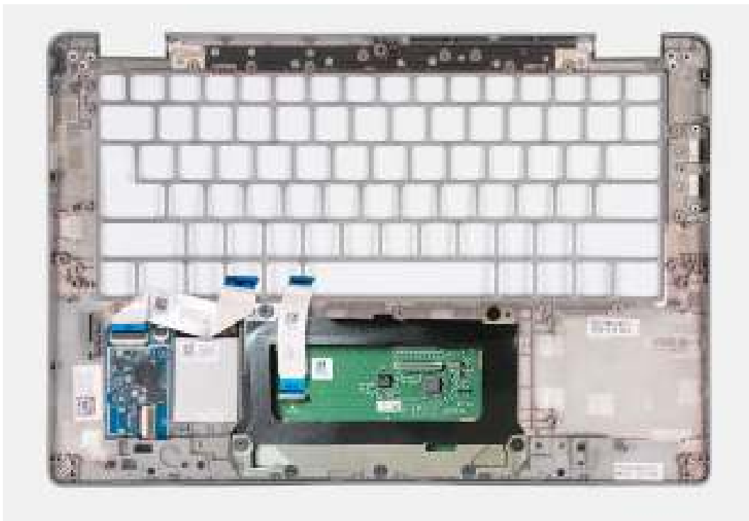
Afbeelding 92. De palmsteun verwijderen
