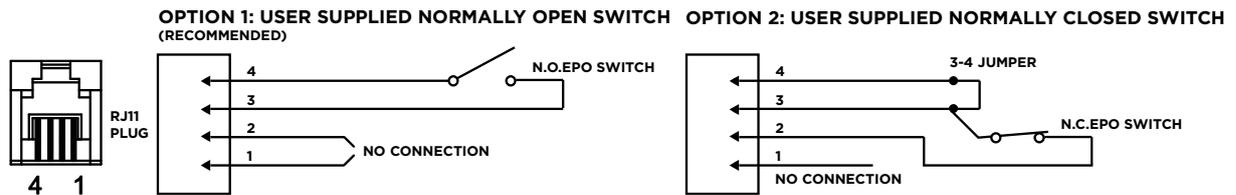
3. Stellen Sie nach der Verdrahtung sicher, dass der externe EPO / ROO-Schalter nicht aktiviert ist, um den USV-Ausgang zu aktivieren.
