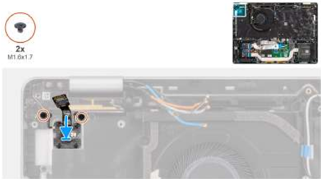
Figure 78. Installation du bouton d'alimentation avec lecteur d'empreintes digitales
