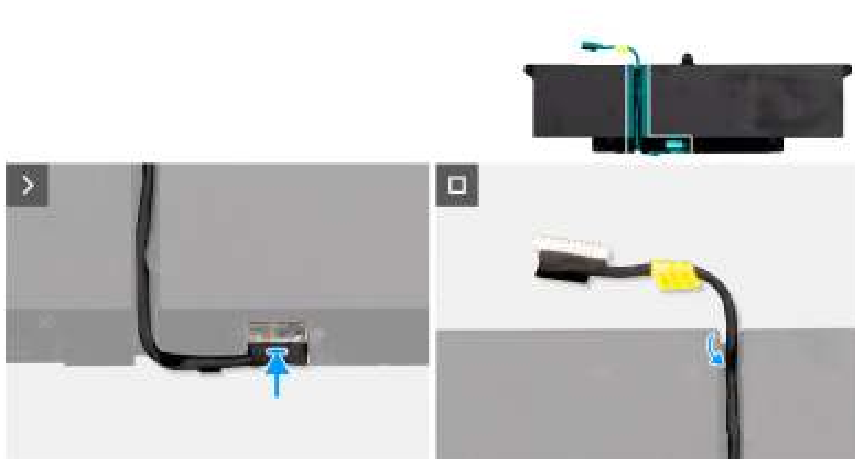
Figure 26. Remplacement du câble de la batterie
