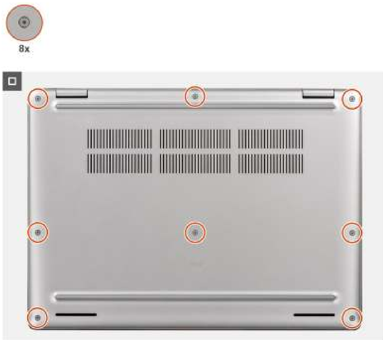
Figure 23. Installation du cache de fond
