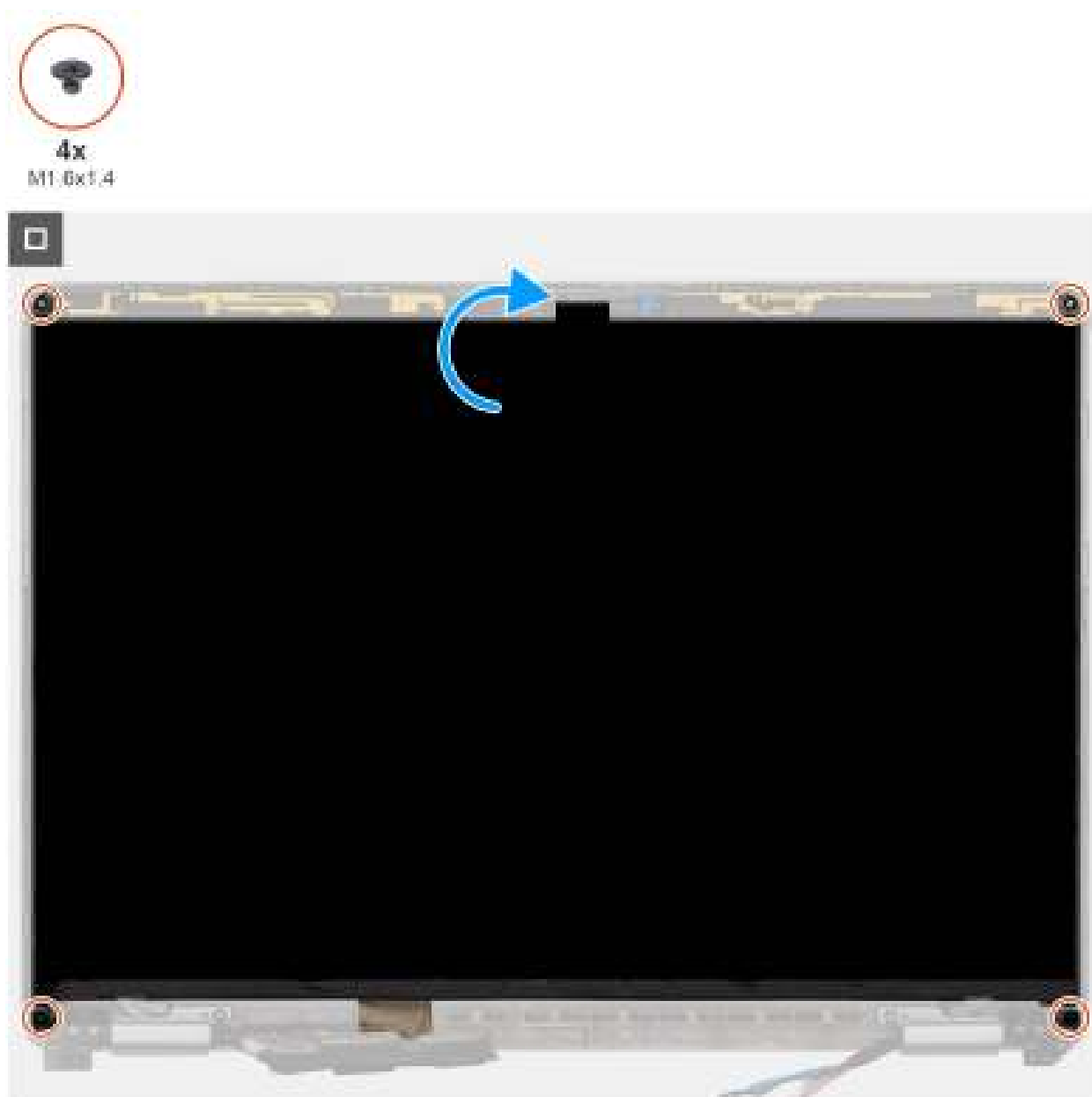
Figure 53. Installation du panneau d'écran
