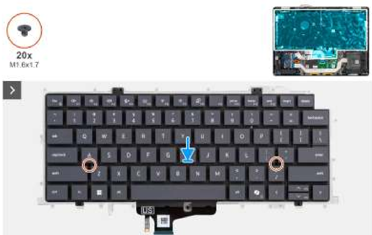
Figure 81. Installation du clavier
