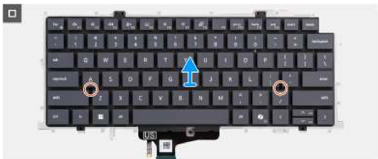
Figure 80. Retrait du clavier
