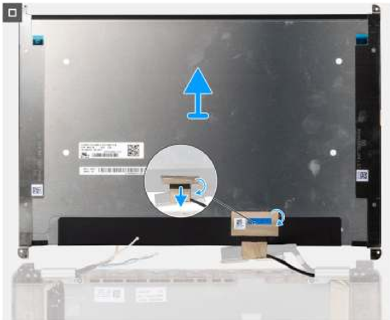
Figure 50. Retrait du câble d'écran du capot arrière
