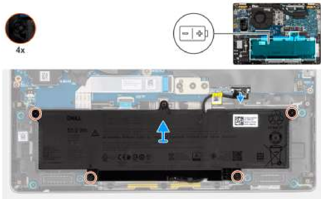
Figure 24. Retrait de la batterie
