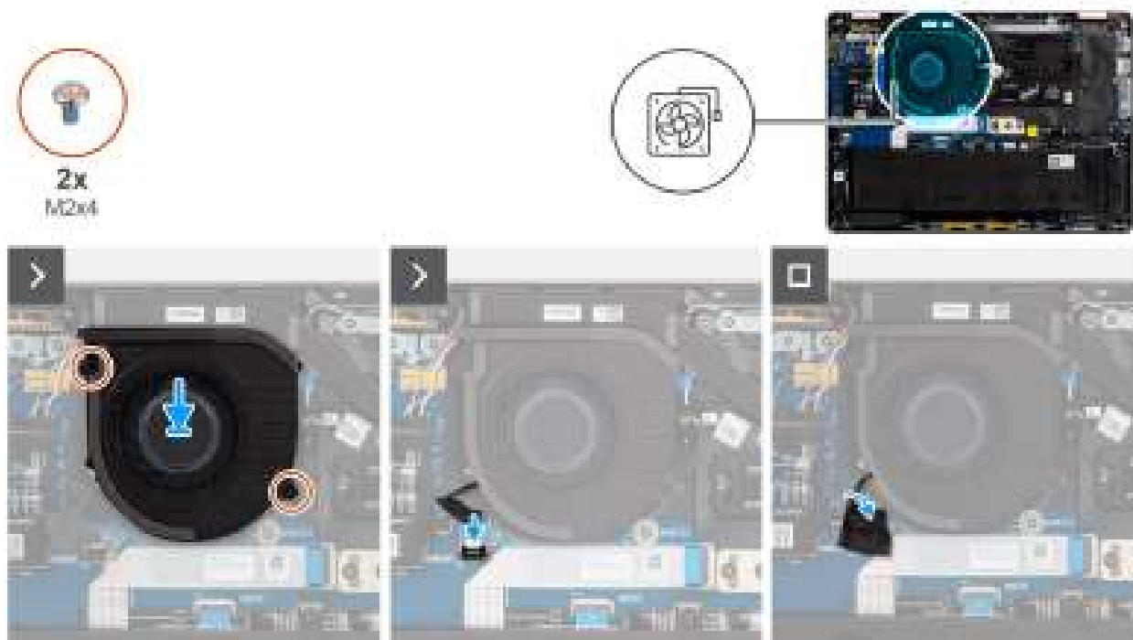
Figure 37. Installation du ventilateur
