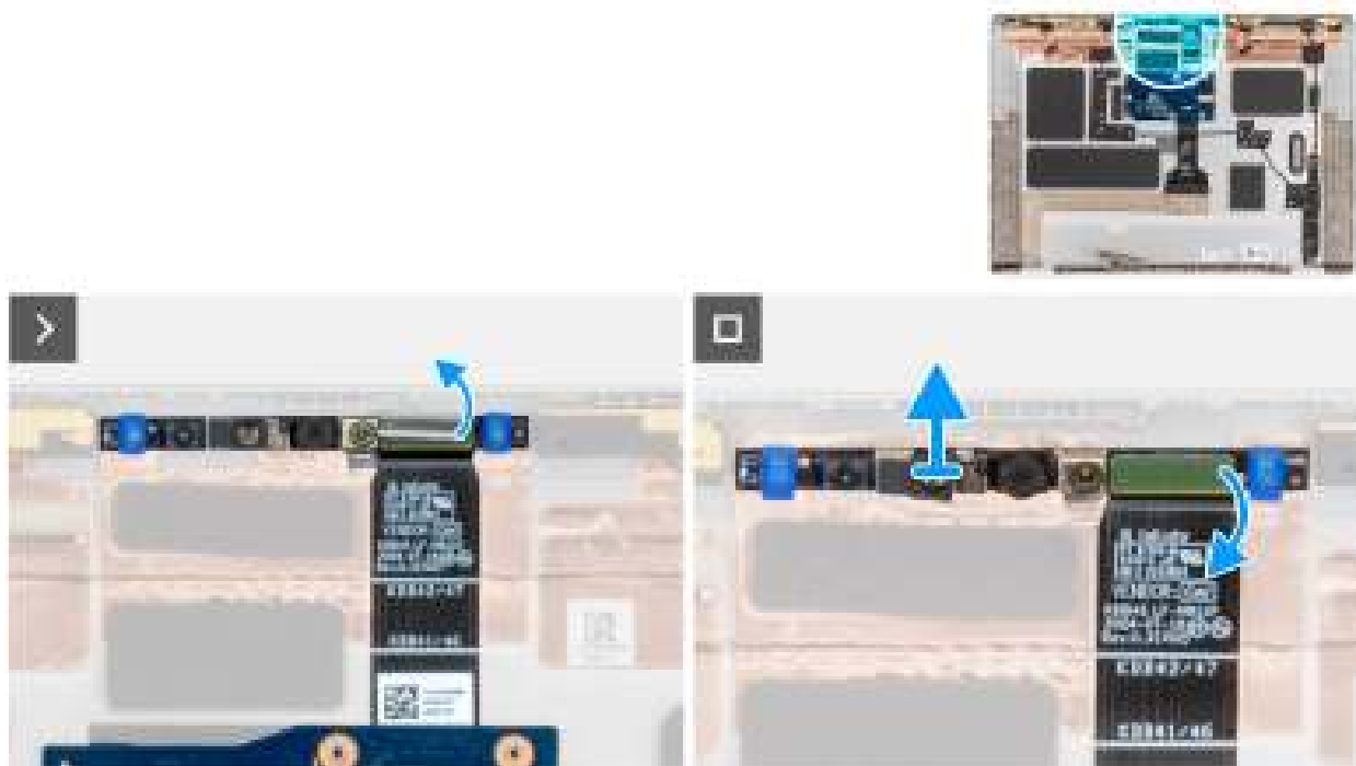
Figure 56. Retrait de la caméra MIPI
