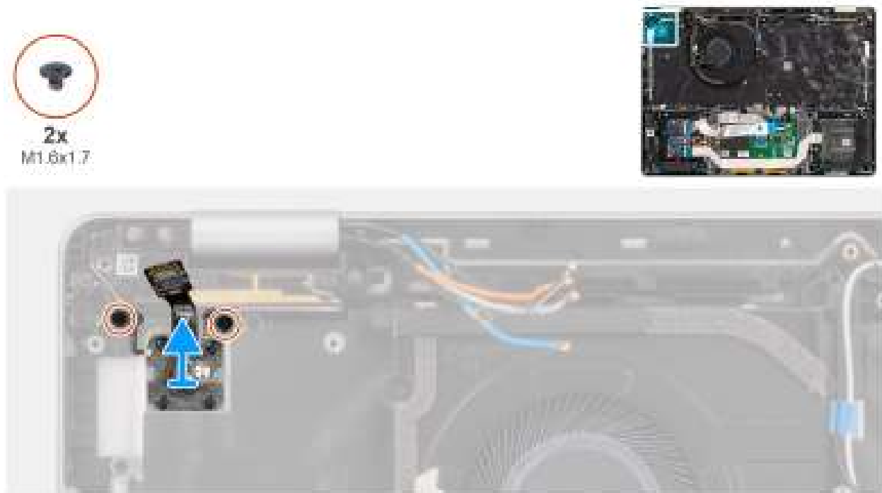
Figure 77. Retrait du bouton d'alimentation avec lecteur d'empreintes digitales
