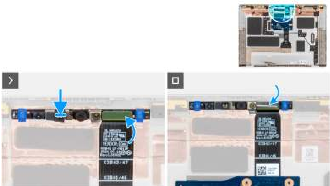
Figure 59. Installation de la caméra MIPI
