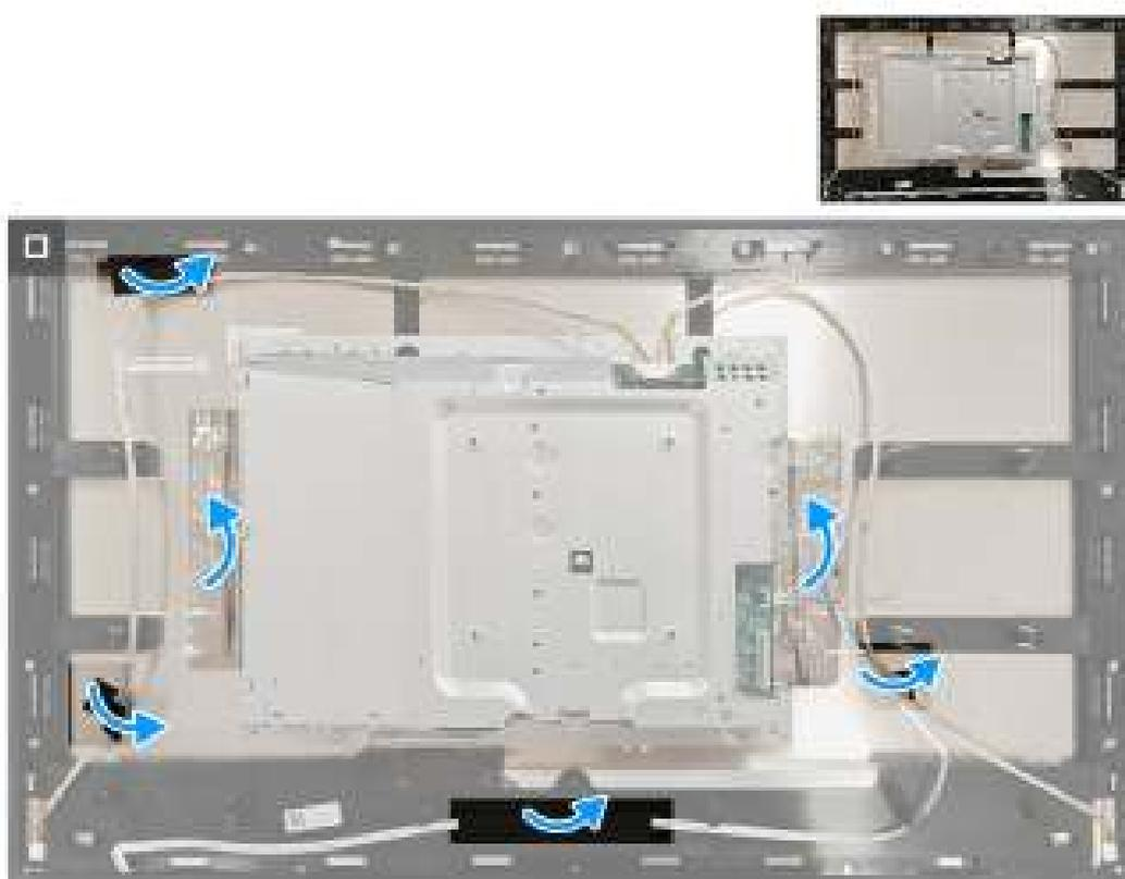
**Figure 19. Installer le blindage métallique**
