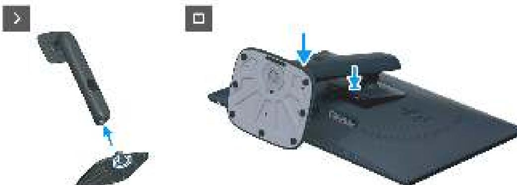
Figure 2. Installer le socle
