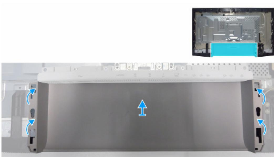
**Figure 4.** Enlever le couvercle arrière inférieur
