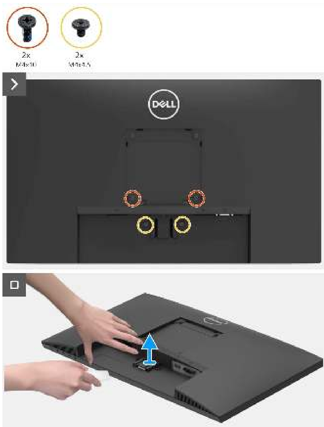
Figure 12. Retrait du couvercle arrière
