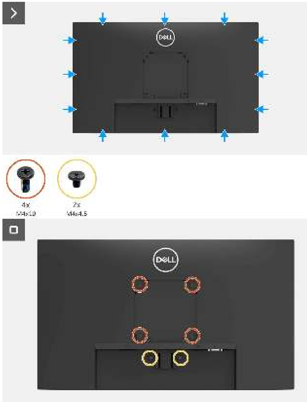
Figure 13. Installation du couvercle arrière
