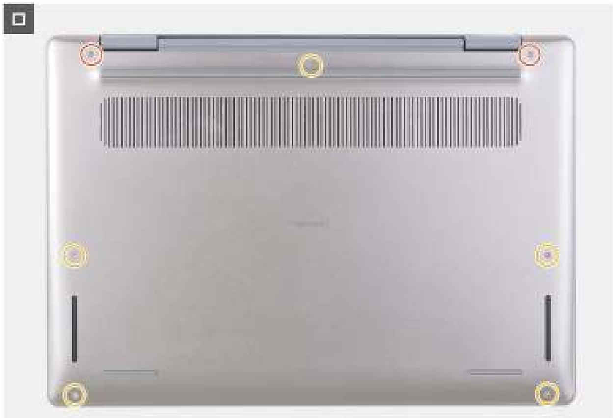
Figure 20. Serrage et remise en place des vis
