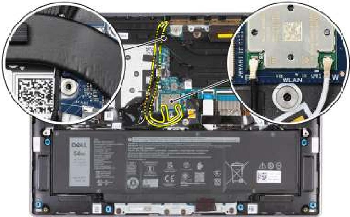
**Figure 71. Installation des câbles d'antenne WLAN**
