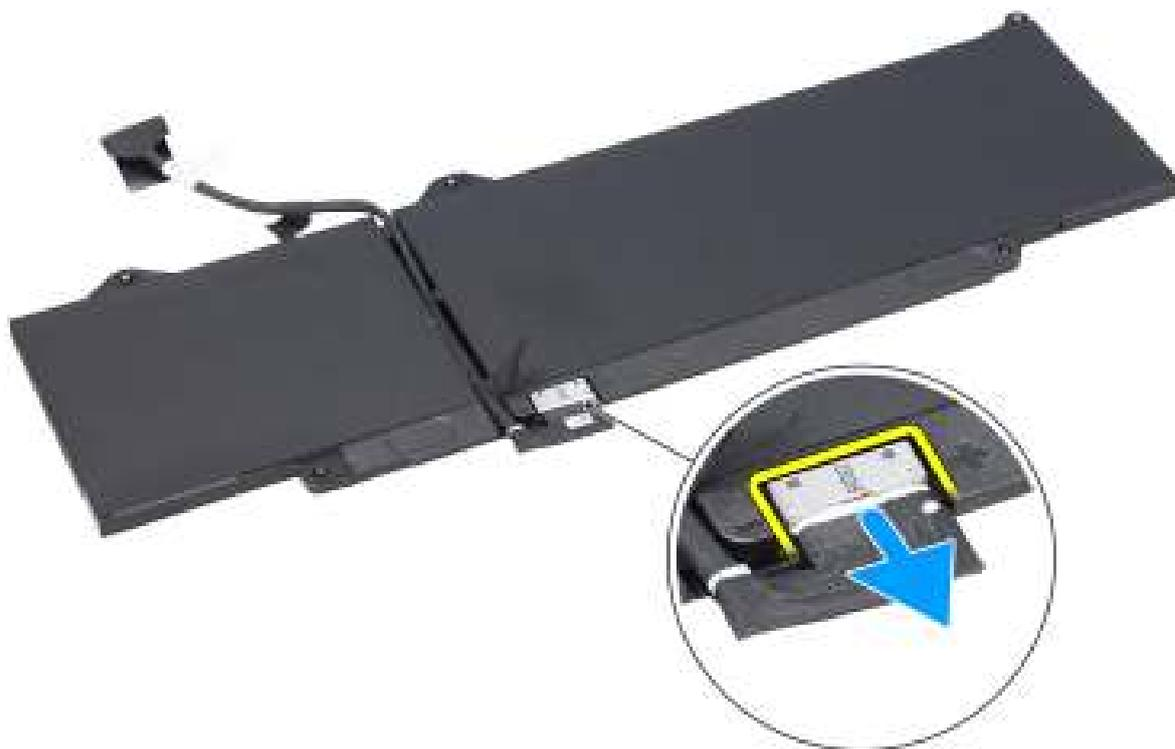
Figure 42. Déconnexion du câble de la batterie
