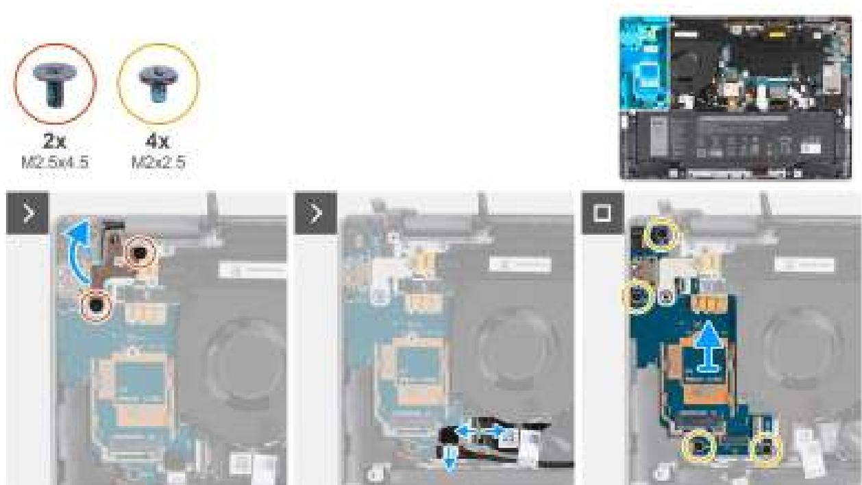
Figure 84. Retrait de la carte d'E/S (pour les ordinateurs expédiés avec une prise en charge WWAN)
