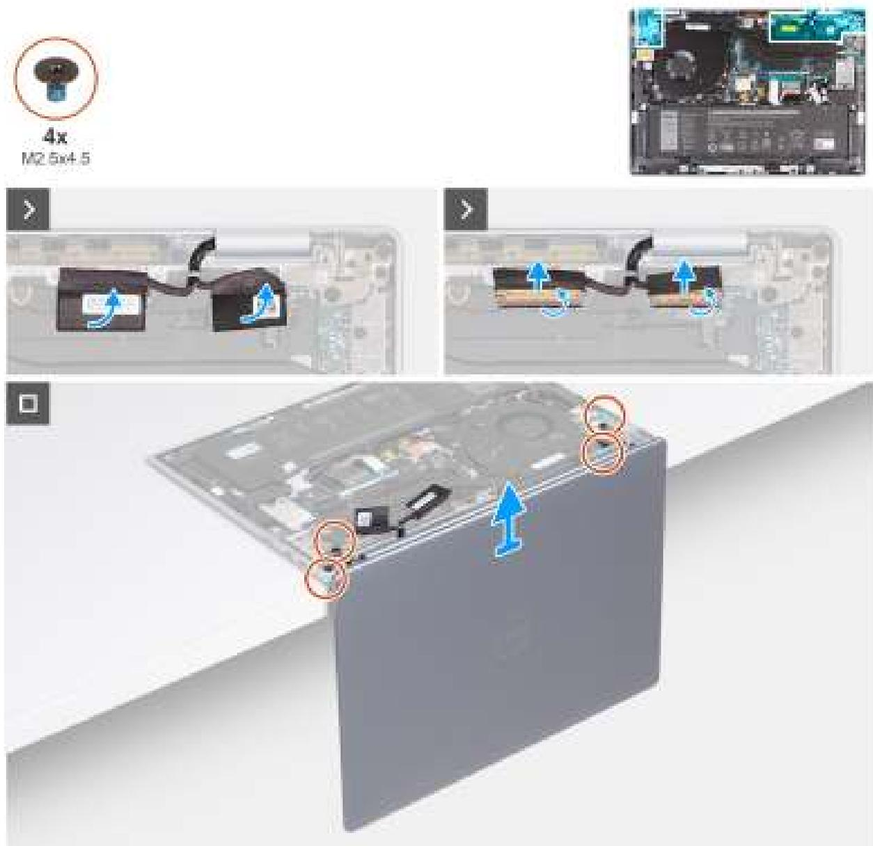
**Figure 74. Retrait de l'assemblage d'écran (pour les ordinateurs expédiés avec une prise en charge WLAN uniquement)**
