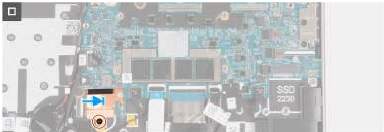
Figure 99. Installation de la carte système
