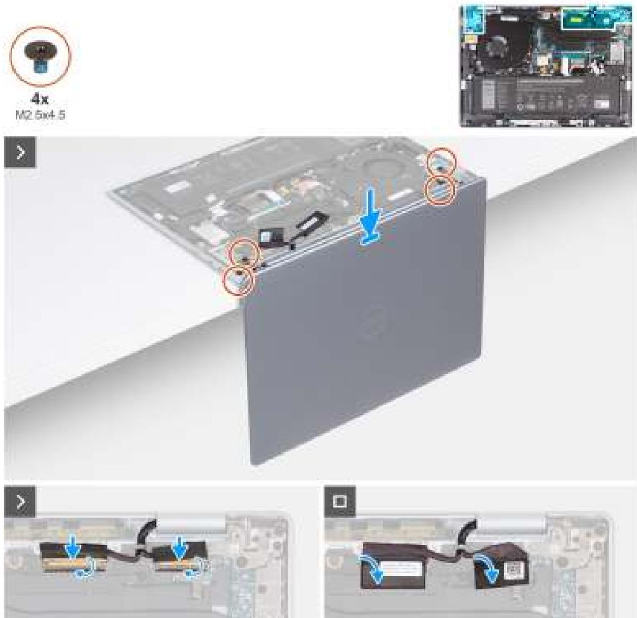
**Figure 76. Installation de l'assemblage d'écran (pour les ordinateurs expédiés avec une prise en charge WLAN uniquement)**
