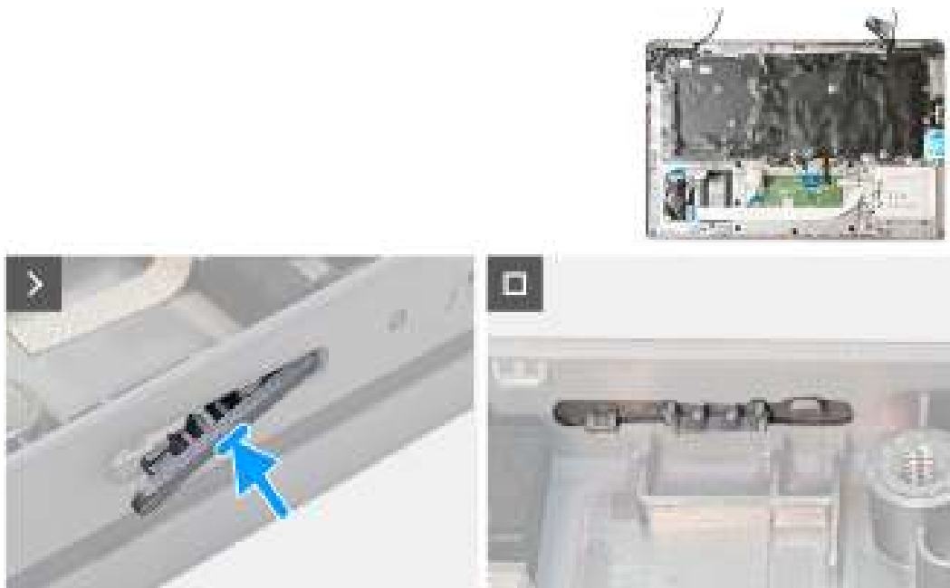
Figure 86. Installation de la plaque de recouvrement du logement de carte SIM factice
