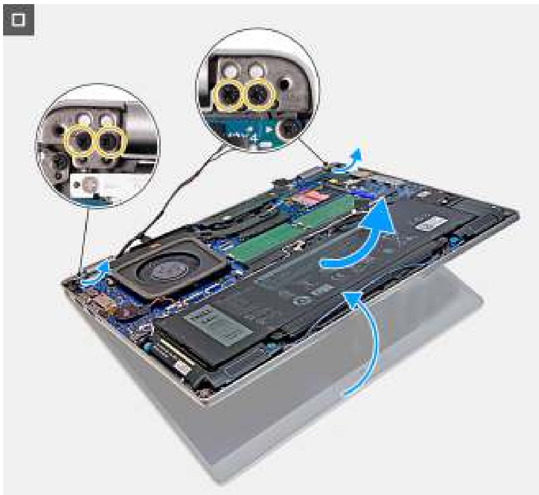
Figure 46. Retrait de l'assemblage d'écran (pour les ordinateurs expédiés avec une carte 5G)
