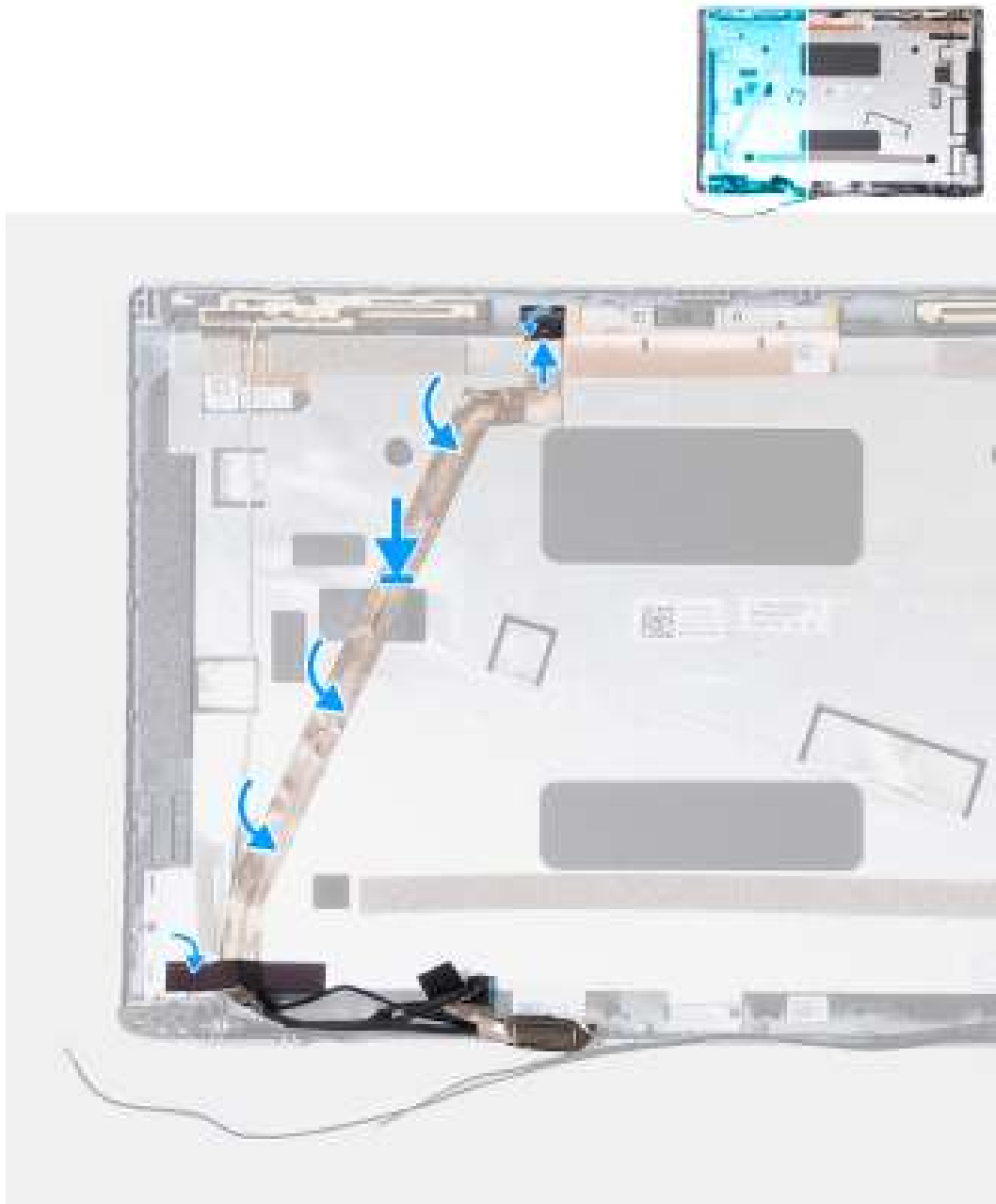
Figure 63. Installation du câble de l'écran
