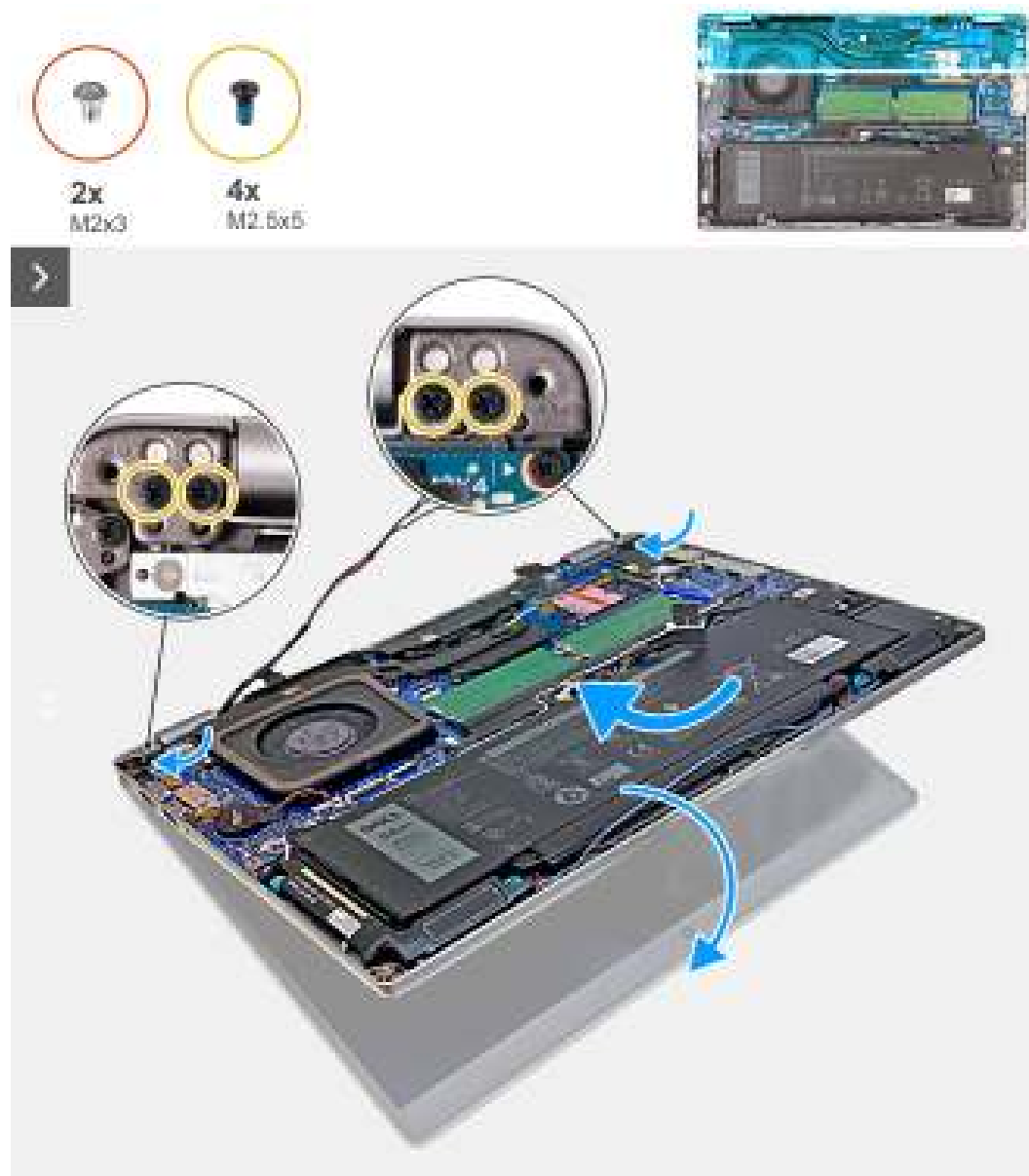
Figure 49. Installation de l'assemblage d'écran (pour les ordinateurs expédiés avec une carte 5G)
