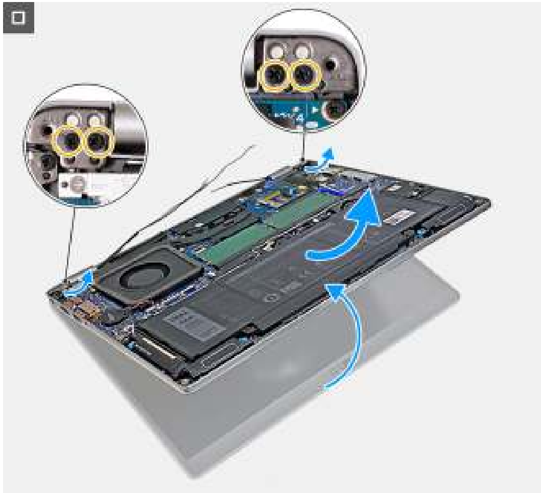
Figure 44. Retrait de l'assemblage d'écran (pour les ordinateurs expédiés avec une carte 4G)
