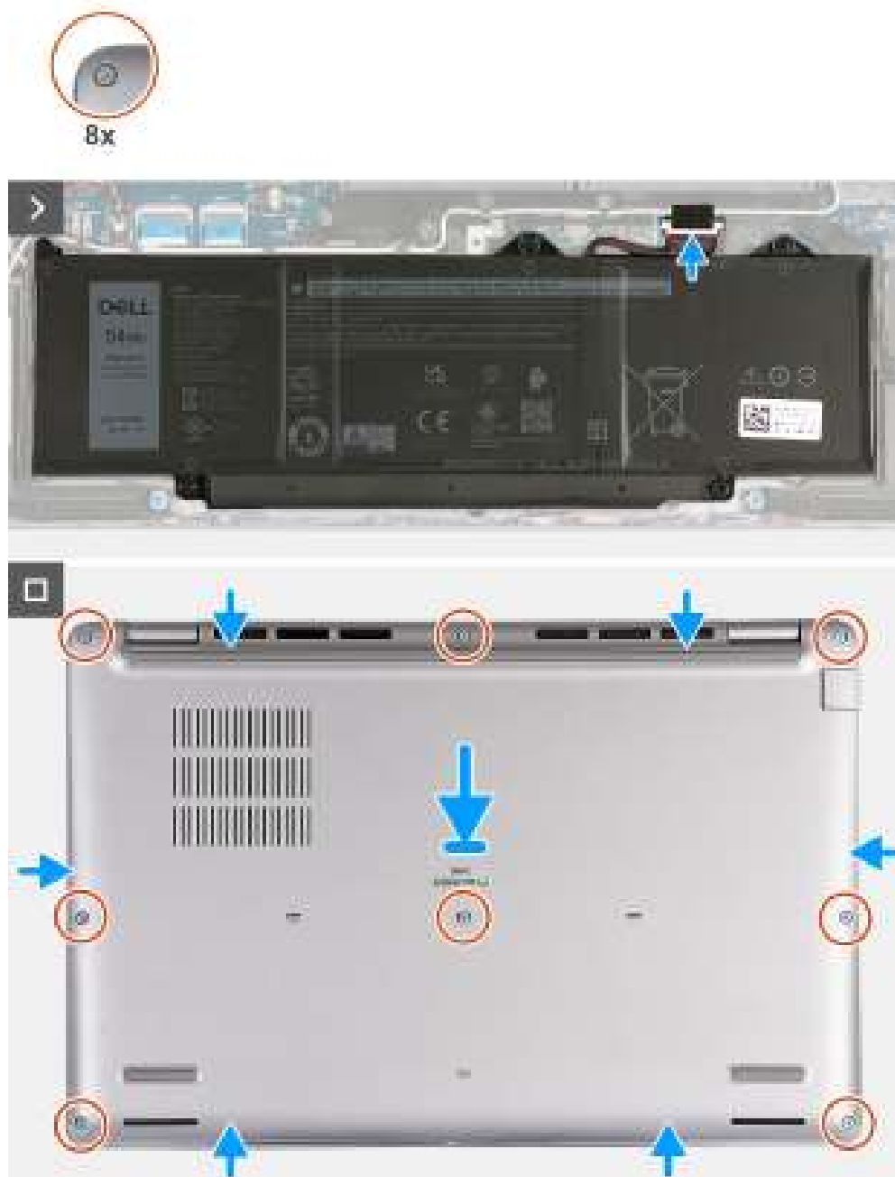
Figure 13. Installation du cache de fond
