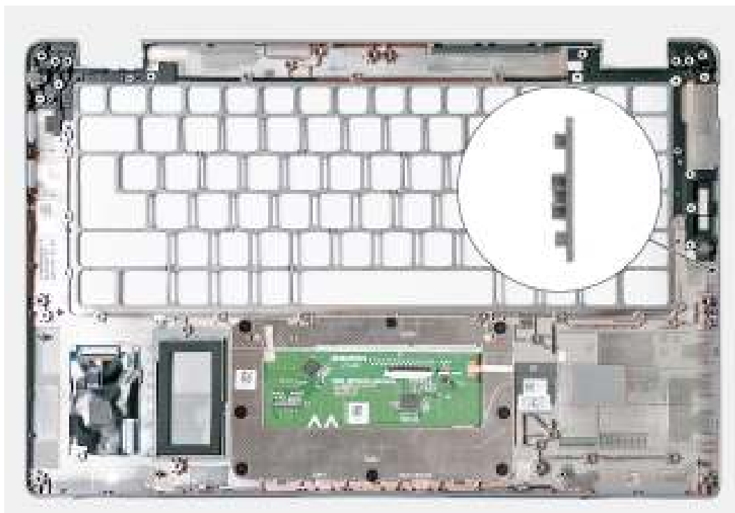
Figure 83. Retrait de l'assemblage du repose-poignets
