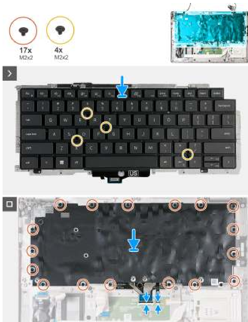
Figure 81. Installation du clavier
