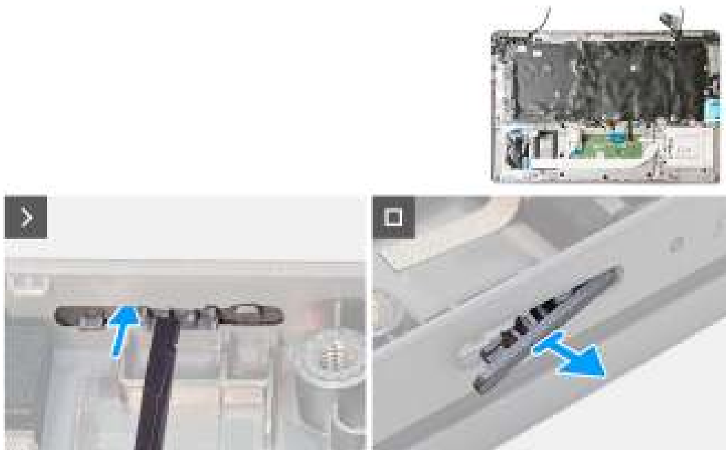
Figure 85. Retrait de la plaque de recouvrement du logement de carte SIM factice
