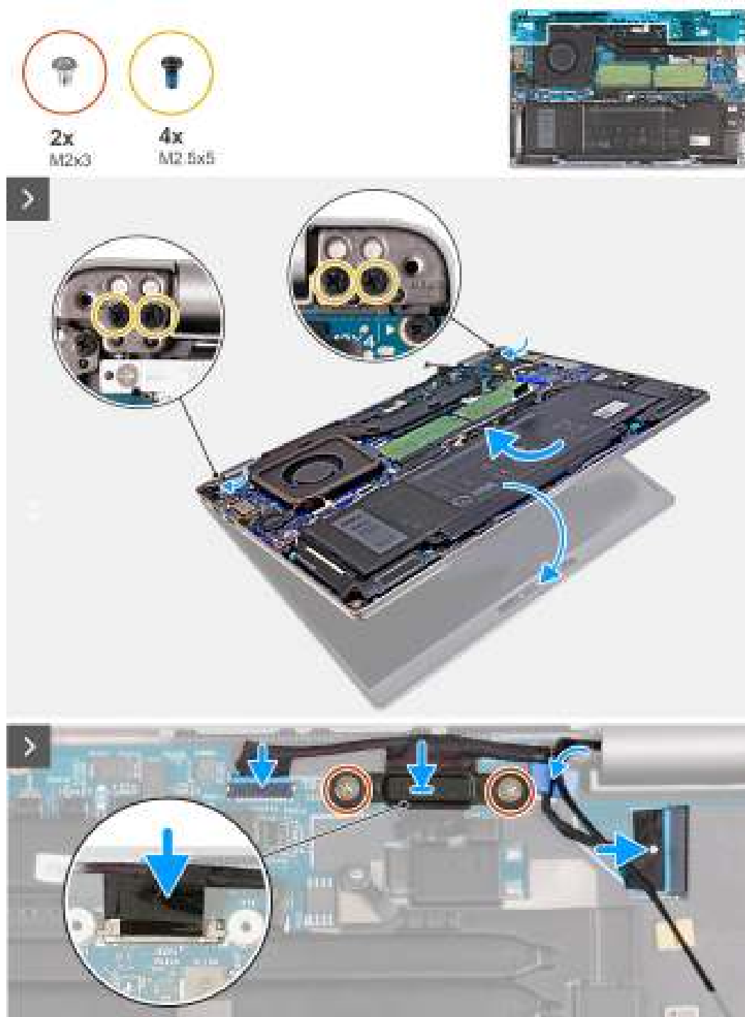
Figure 52. Installation de l'assemblage d'écran (pour les ordinateurs expédiés avec une carte graphique séparée)
