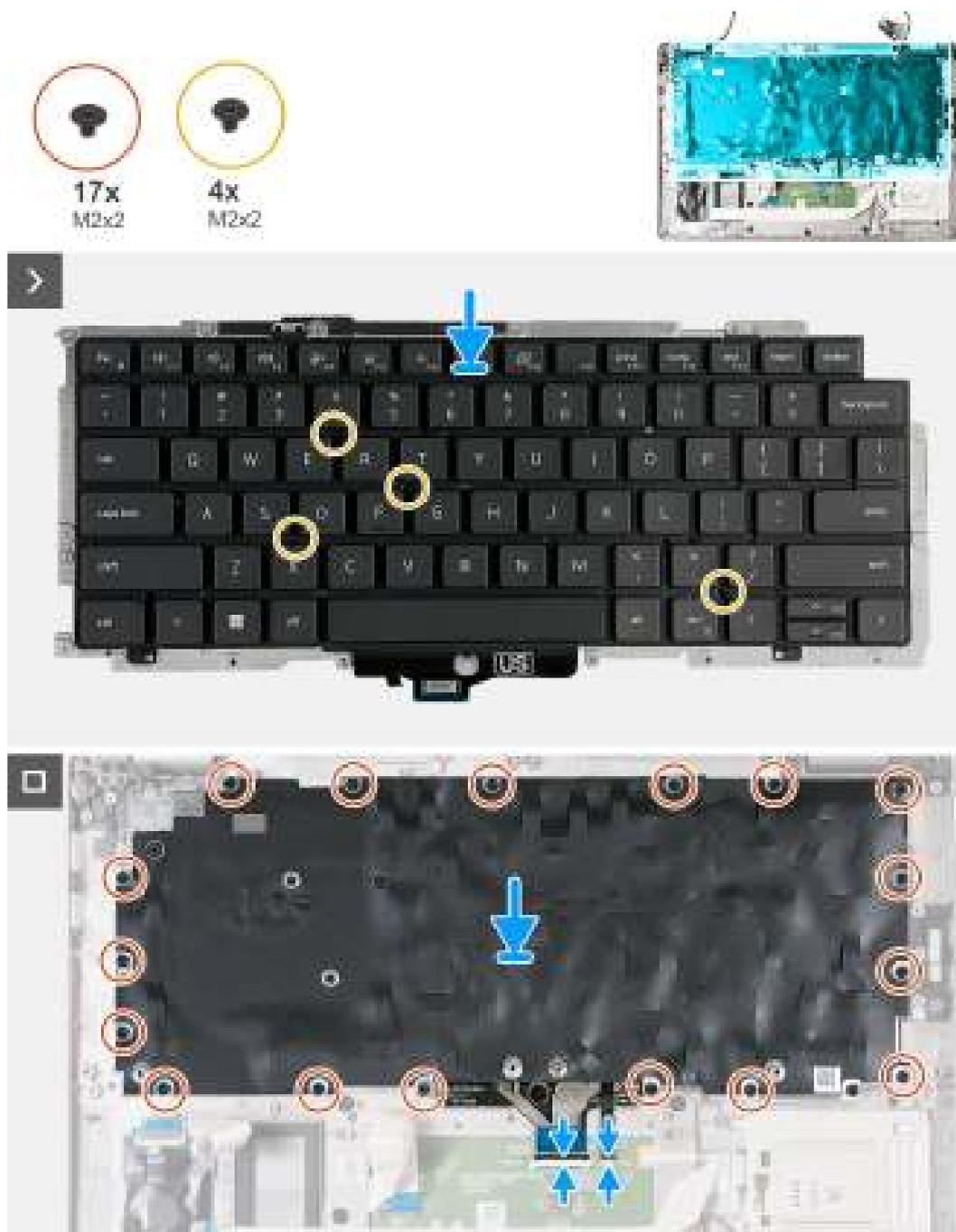
**Figure 81. Installation du clavier**
