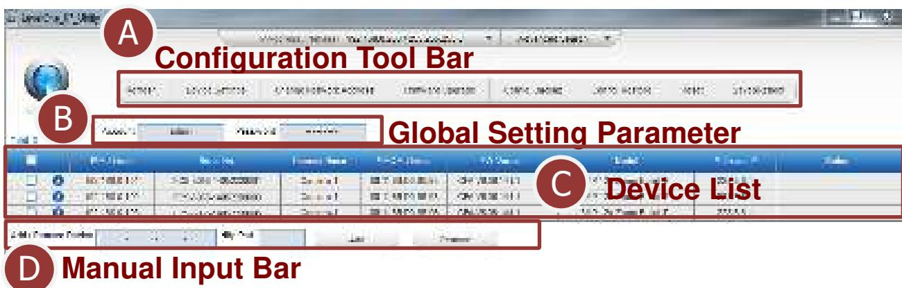
5. Для получения доступа к устройству щелкните мышью по IP-адресу в списке устройств. При этом Internet Explorer разрешает пользователю доступ к микропрограмме устройства.
