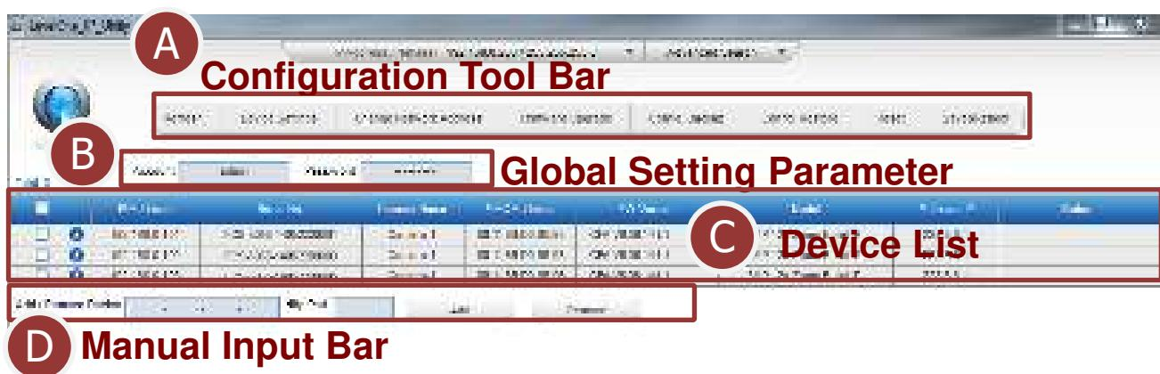
5. 要進入設備，只需用鼠標點擊設備列表上的 IP 地址。這將啟動 IE 瀏覽器，允許用戶進入設備的軀體
