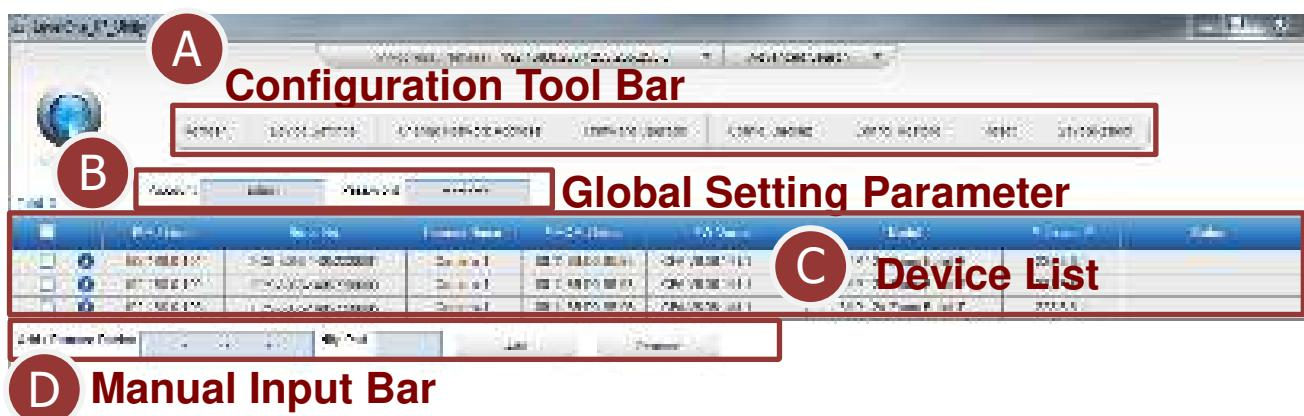
5. Pour accéder à l'appareil, utilisez simplement la souris pour cliquer sur l'adresse IP dans la liste d'appareils. Ceci lancera Internet Explorer pour permettre à l'utilisateur d'accéder au firmware de l'appareil.
