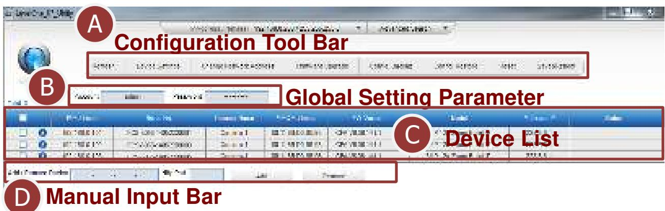
5. Om toegang te krijgen tot het apparaat, gebruikt u gewoon de muis om te klikken op het IP-adres in de apparaatlijst. Hiermee wordt Internet Explorer gestart zodat de gebruiker toegang krijgt tot de firmware van het apparaat.
