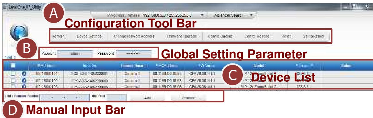
5. W celu dostępu do urządzenia, wystarczy kliknąć myszą adres IP na liście urządzeń. Zainicjuje to przeglądarkę Internet Explorer, aby zapewnić użytkownikowi dostęp do firmware urządzenia.
