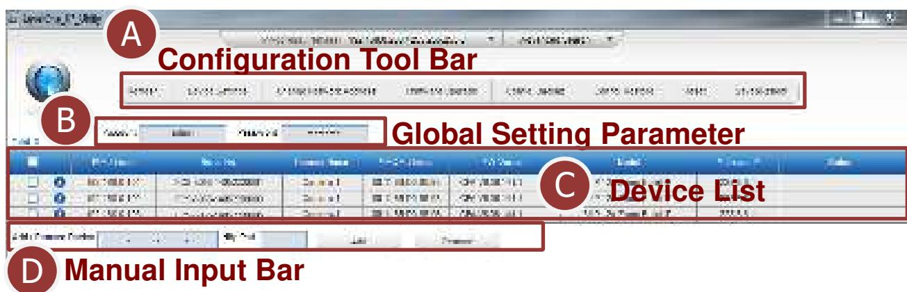
5. Para aceder ao dispositivo, utilize o rato para clicar no endereço IP na lista de dispositivos. Isso irá iniciar o Internet Explorer para permitir que o utilizar aceda ao firmware do dispositivo.
