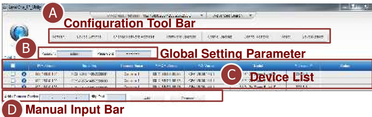
5. Para acceder al dispositivo, simplemente utilice el ratón para hacer clic en la dirección IP en la lista de dispositivos. Esta operación iniciará Internet Explorer, permitiendo al usuario acceder al firmware el dispositivo.
