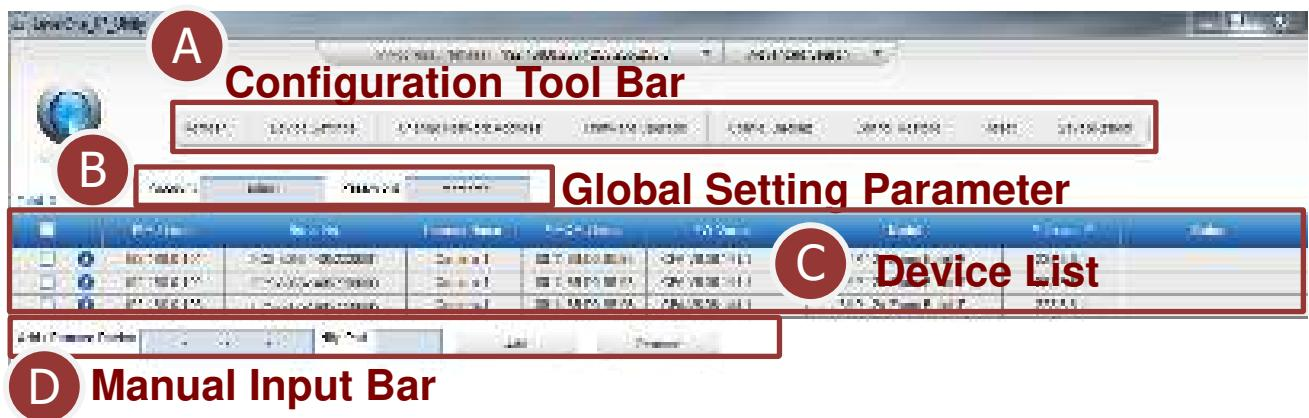
5. Klicken Sie zum Zugreifen auf das Gerät einfach mit der Maus auf die IP-Adresse in der Geräteliste. Dies startet den Internet Explorer, damit der Nutzer auf die Firmware des Gerätes zugreifen kann.
