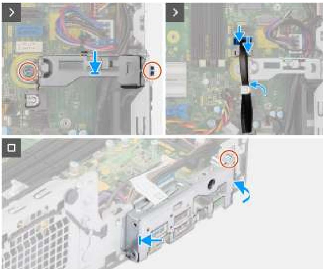
**Figure 73. Installation de la carte système**
