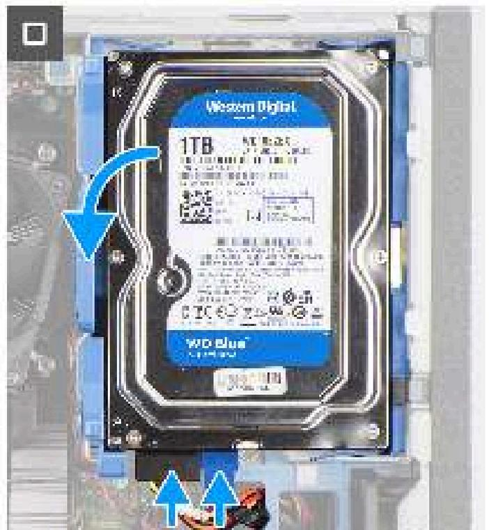
Figure 10. Installation du disque dur de 3,5 pouces
