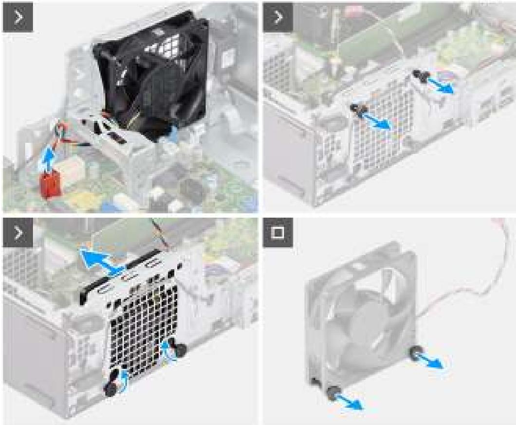
Figure 41. Retrait du ventilateur système
