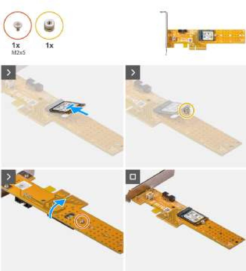
Figure 26. Installation du disque SSD M.2 2230 sur la carte Dell Ultra Speed Drive Gen 3
