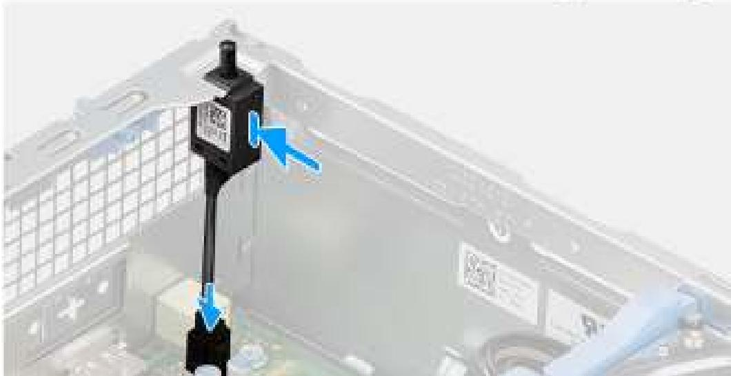
**Figure 38. Installation du commutateur d'intrusion**
