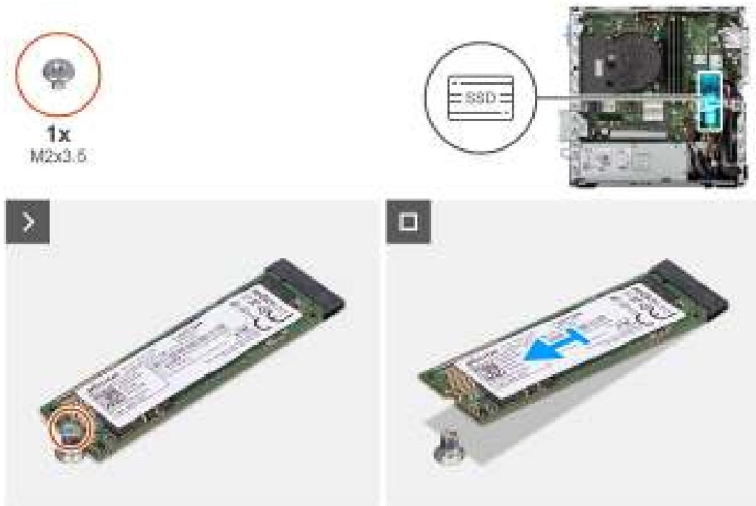
Figure 21. Retrait du disque SSD M.2 2280
