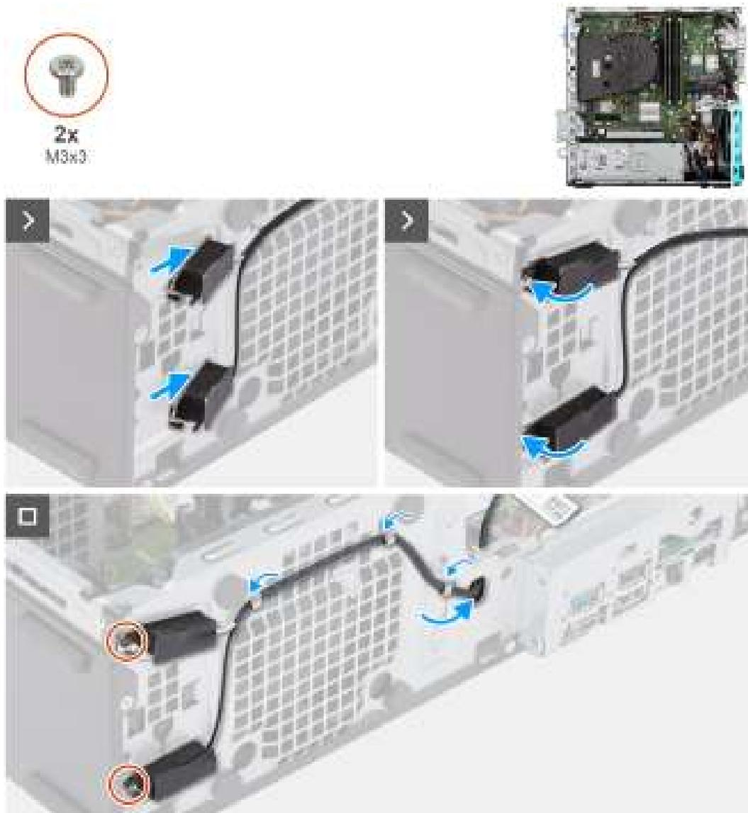
**Figure 45. Installation du module d'antenne interne**
