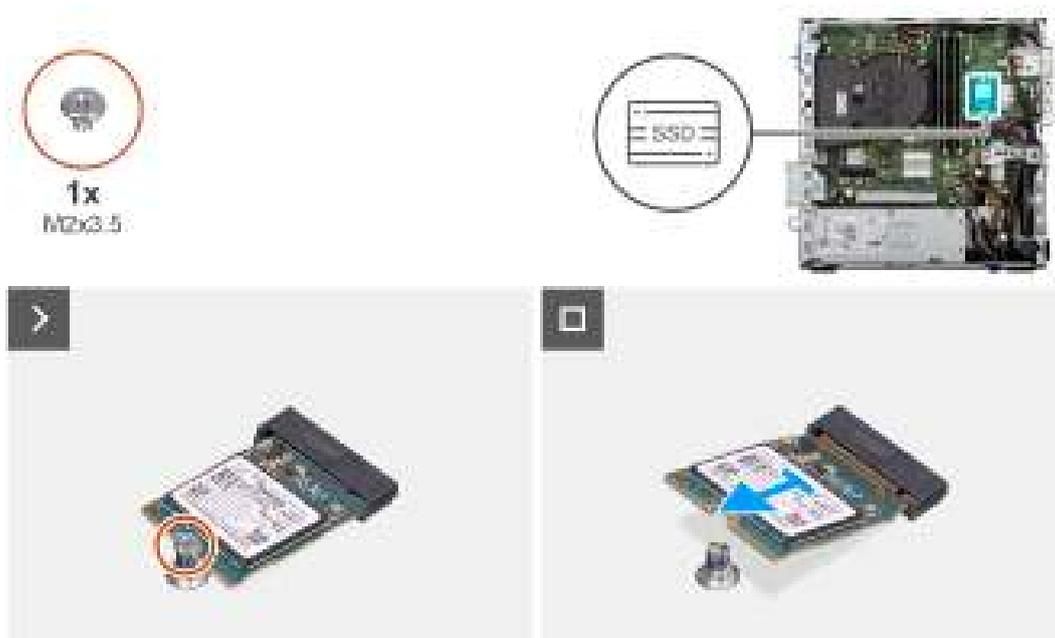
Figure 19. Retrait du disque SSD M.2 2230
