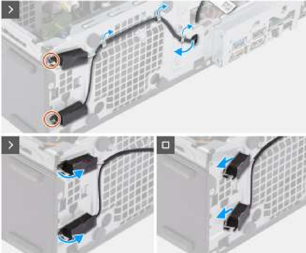
Figure 43. Retrait du module d'antenne interne
