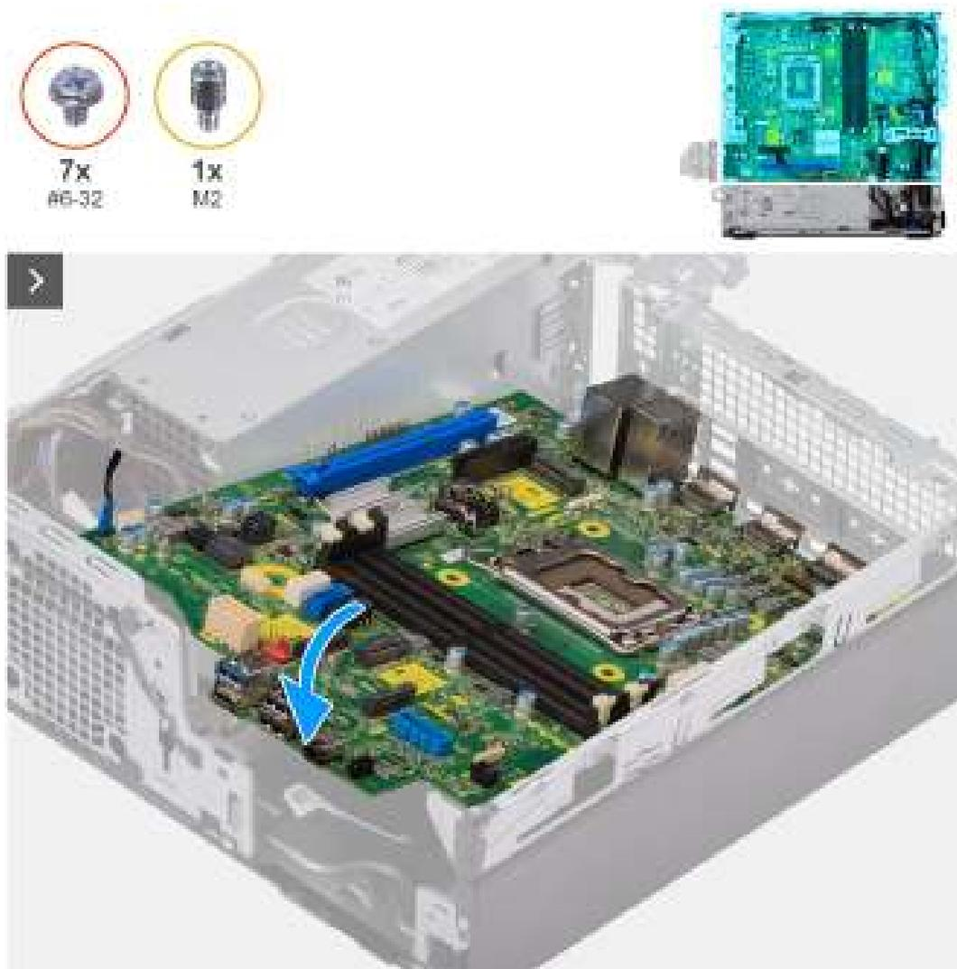
**Figure 70. Installation de la carte système**
