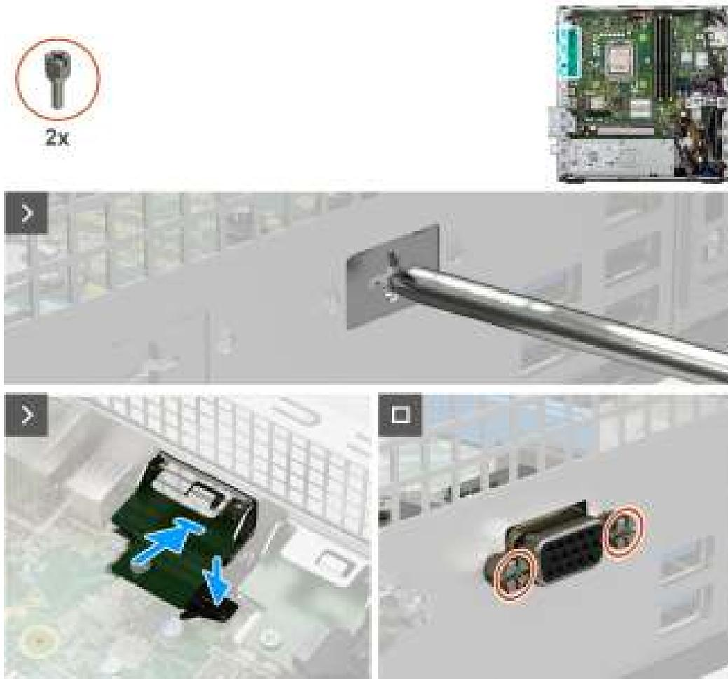
Figure 61. Installation du module VGA
