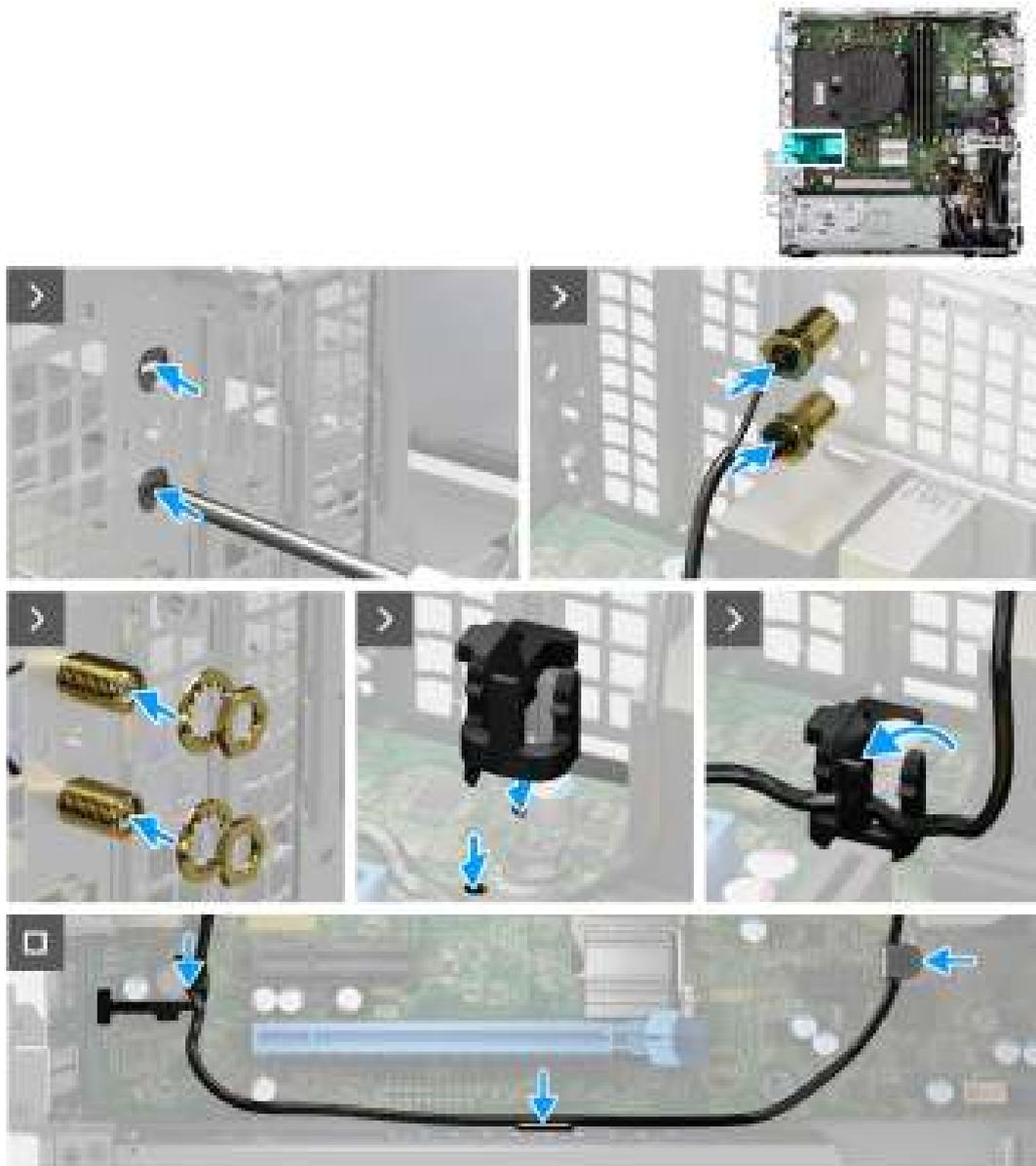
Figure 47. Installation du module d'antenne SMA externe
