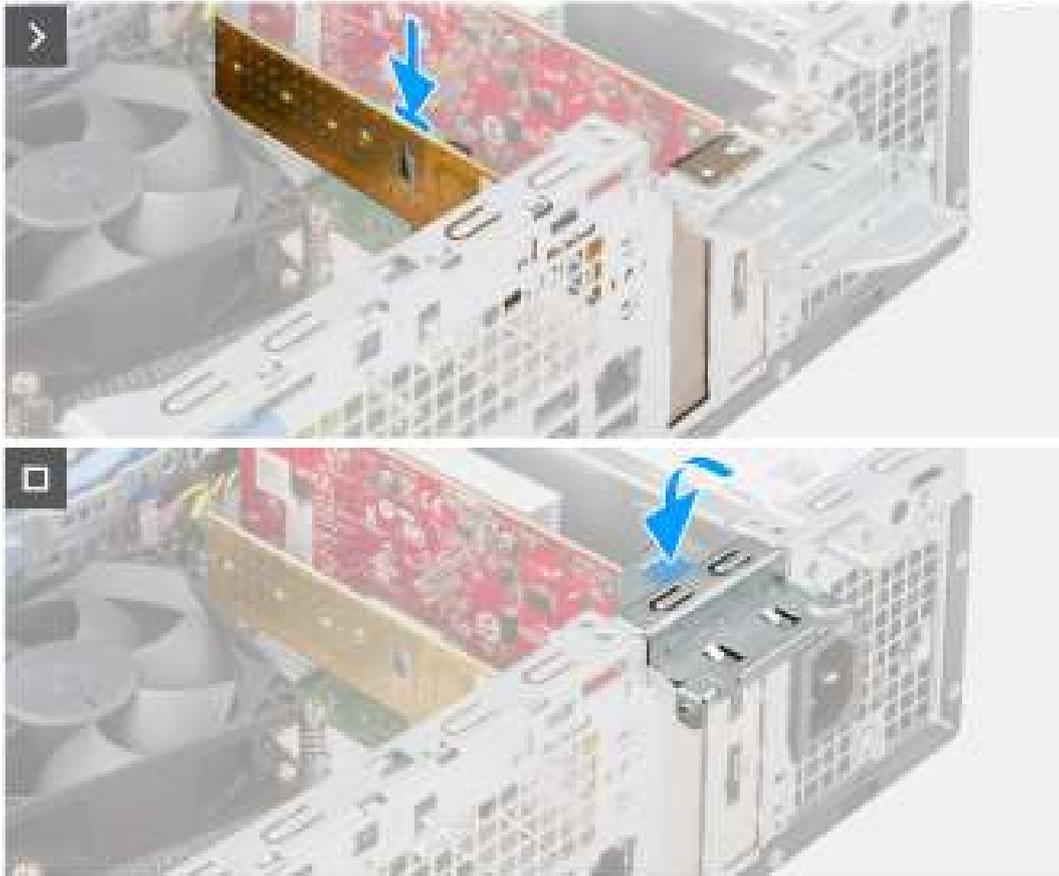
**Figure 28. Installation de la carte Dell Ultra Speed Drive Gen 3**
