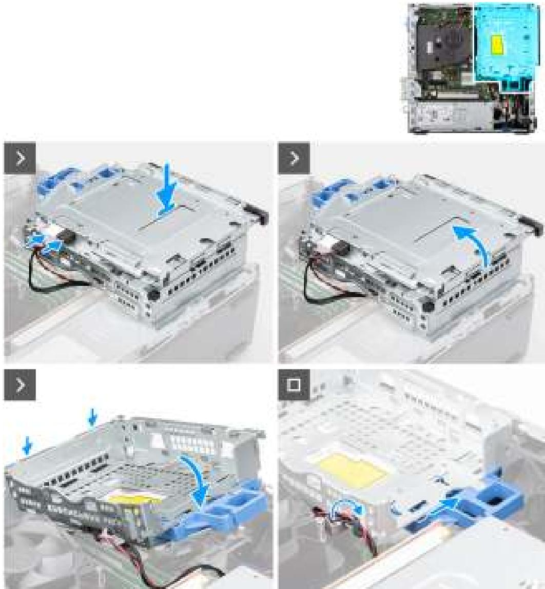
Figure 12. Installation du bâti du lecteur de disque
