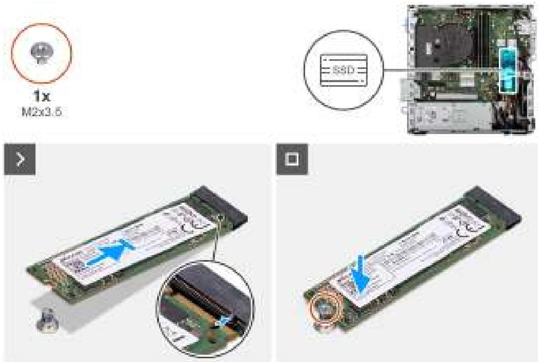
Figure 22. Installation du disque SSD M.2 2280
