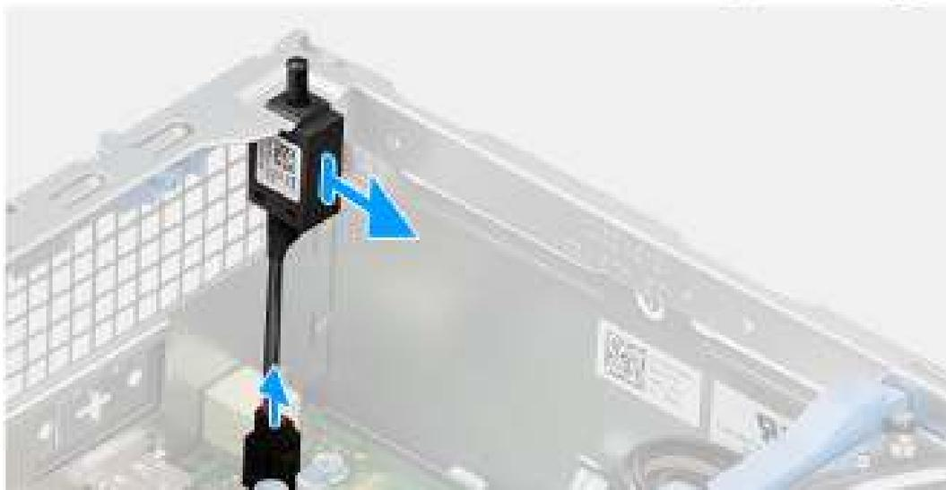
Figure 37. Retrait du commutateur d'intrusion
