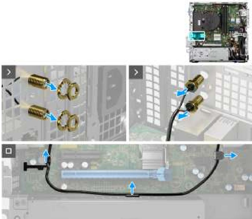
Figure 46. Retrait du module d'antenne SMA externe
