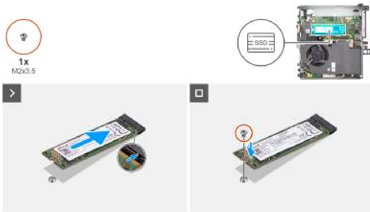
Figure 24. Installation du disque SSD M.2 2280 PCIe (logement 1)
