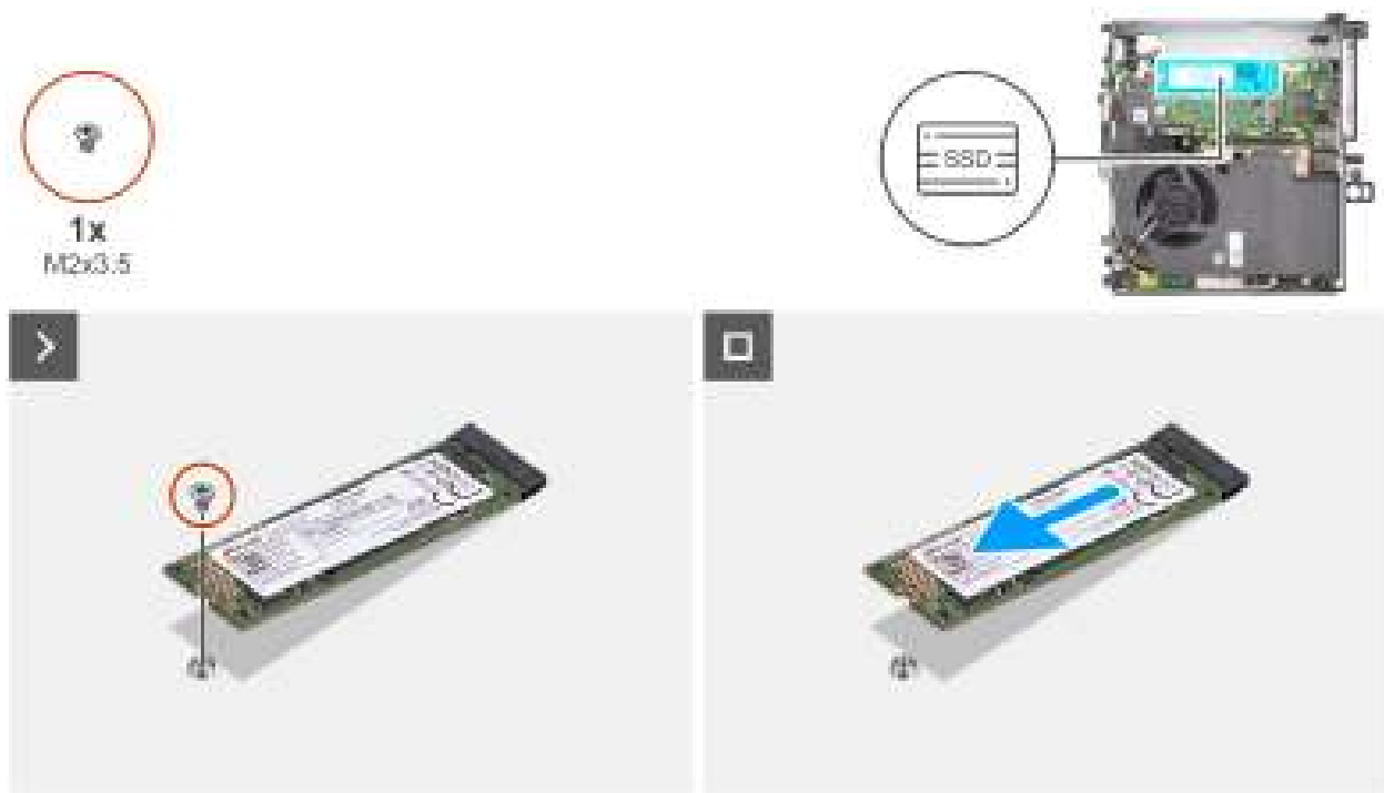
Figure 23. Retrait du disque SSD M.2 2280 PCIe (logement 2)
