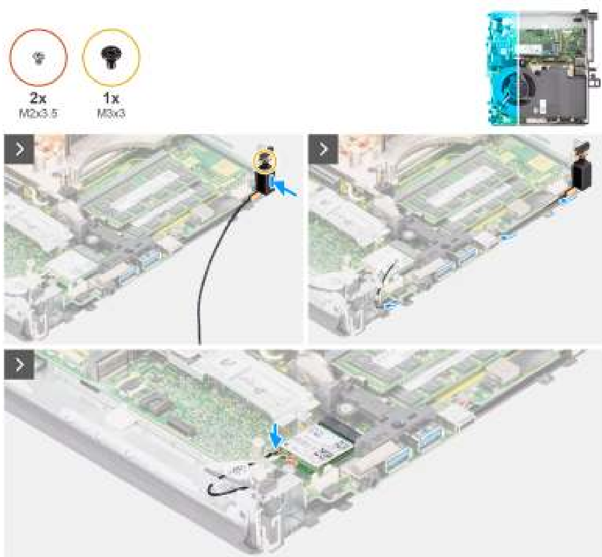
Figure 56. Installation de l'antenne interne (emplacement 2)
