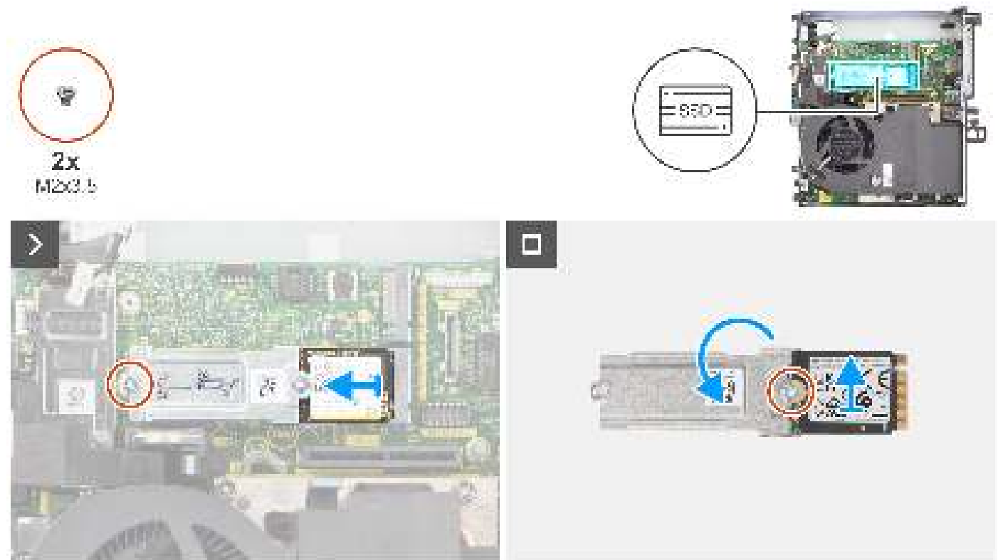
Figure 18. Retrait du disque SSD M.2 2230 (logement 1)
