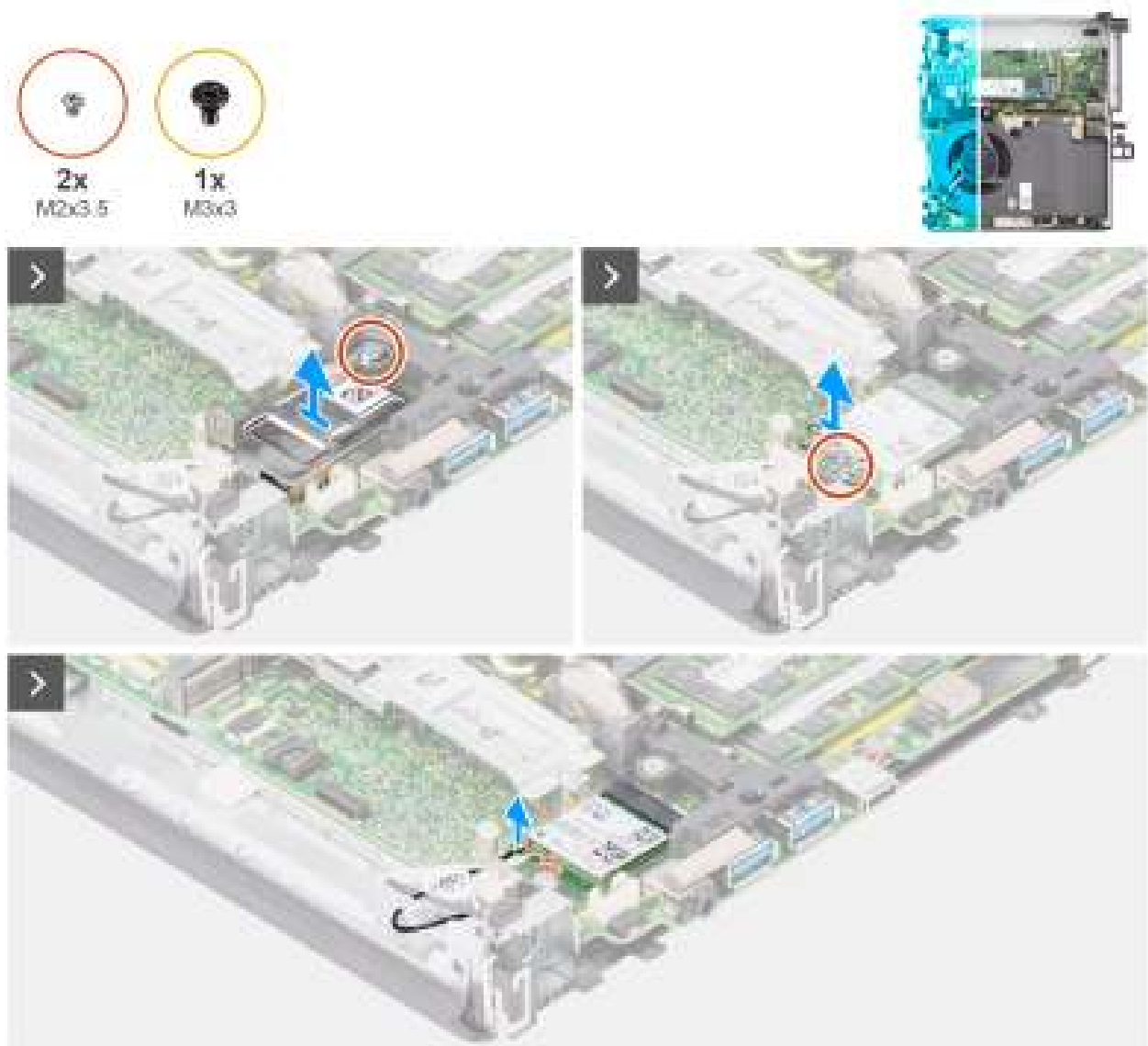
Figure 54. Retrait de l'antenne interne (emplacement 2)
