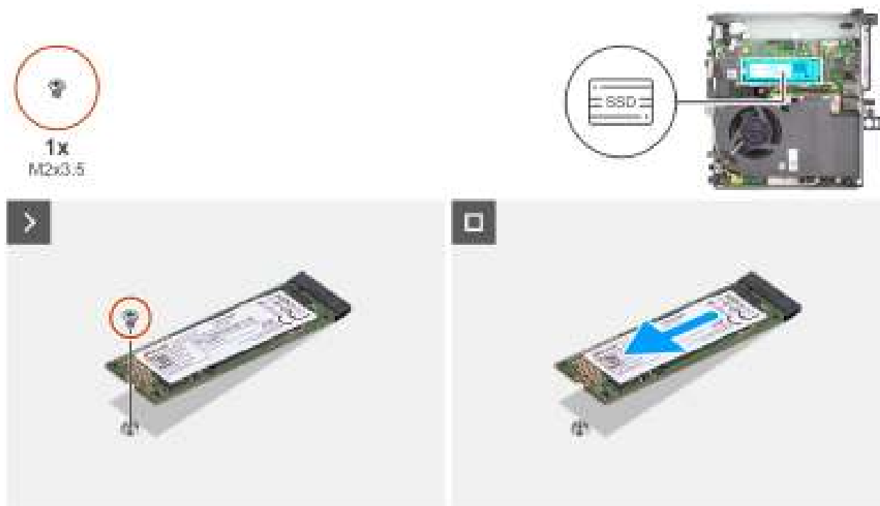
Figure 22. Retrait du disque SSD M.2 2280 PCIe (logement 1)
