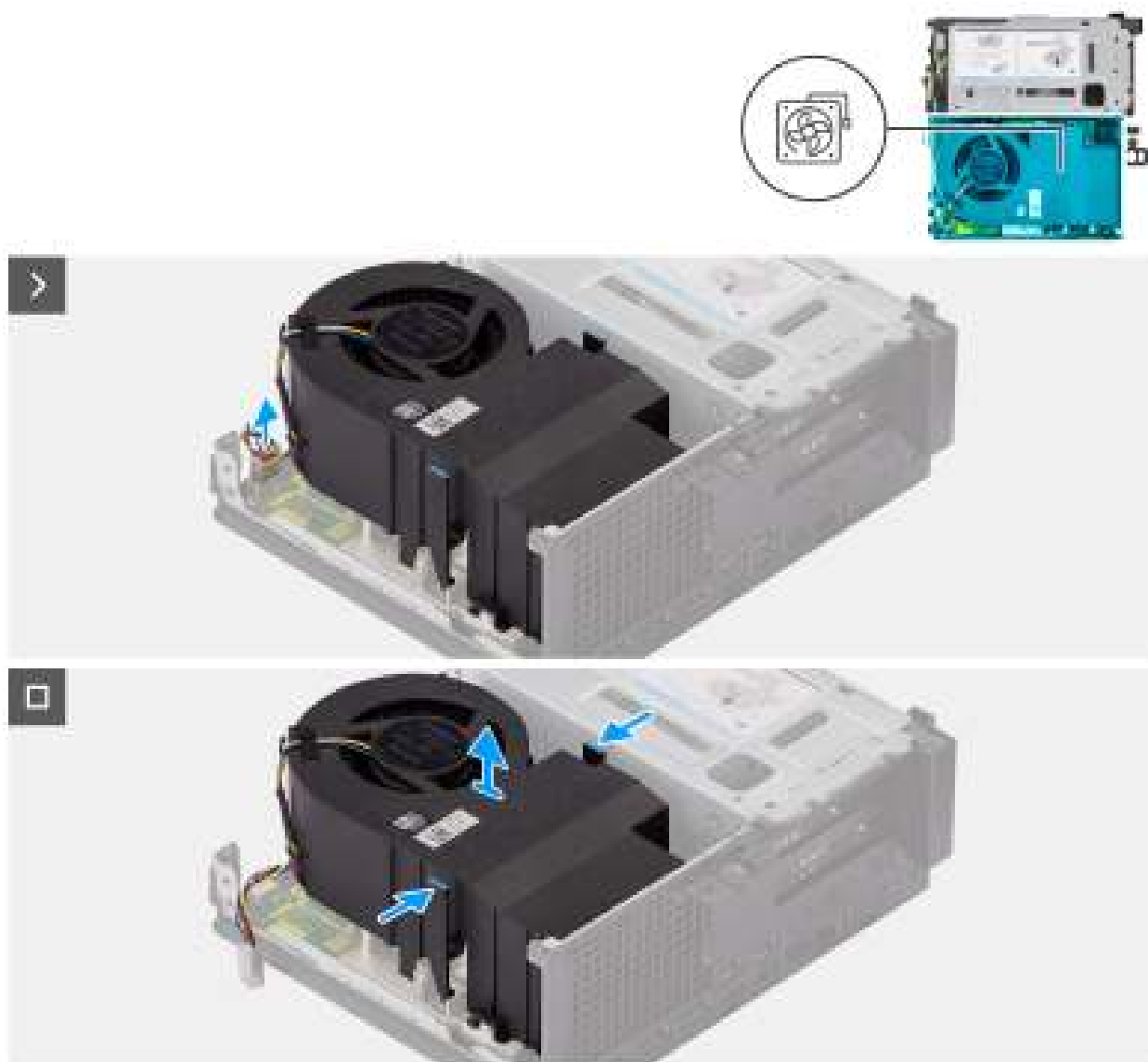
Figure 36. Retrait du ventilateur du processeur
