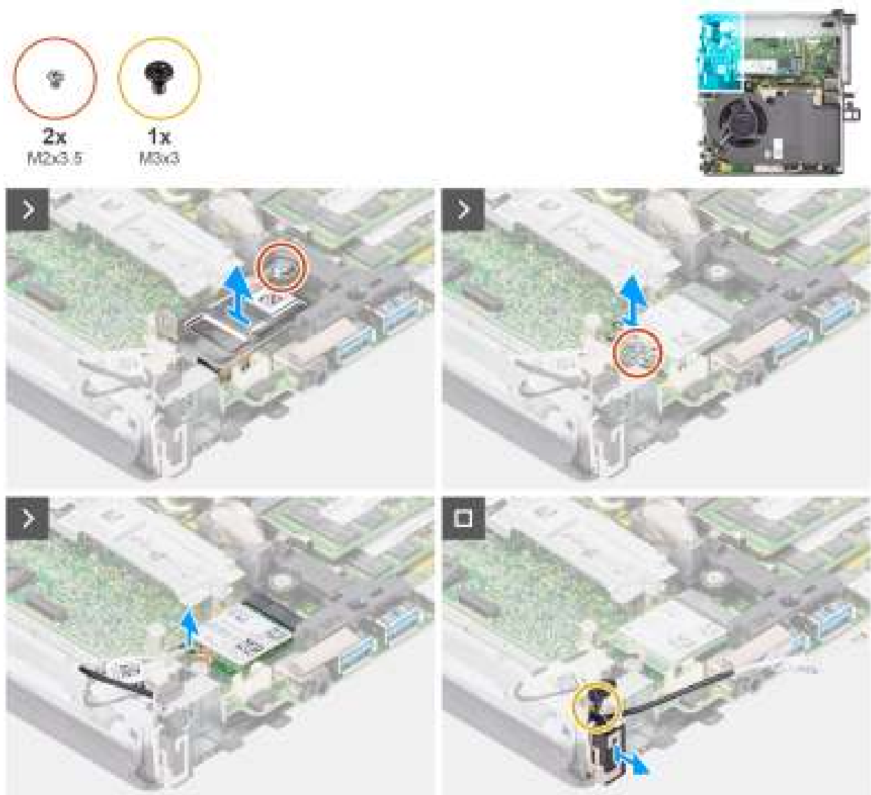
Figure 52. Retrait de l'antenne interne (emplacement 1)
