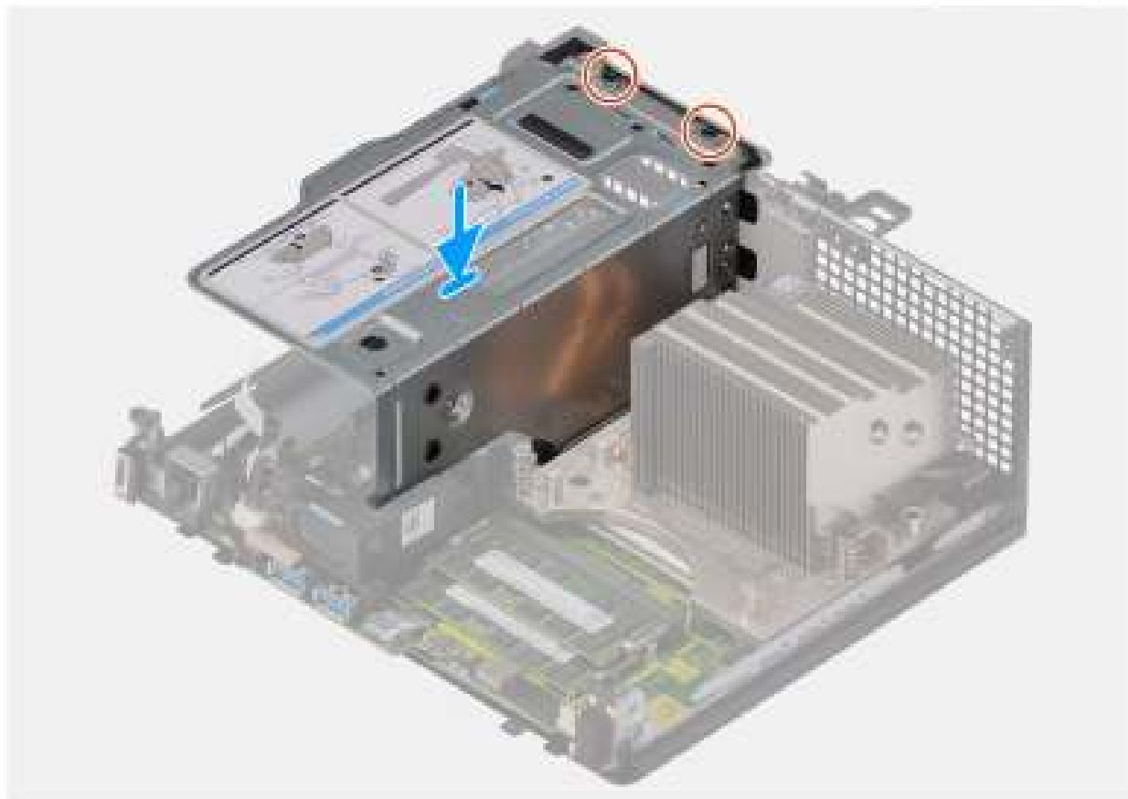
Figure 16. Retrait du module de la carte de montage
