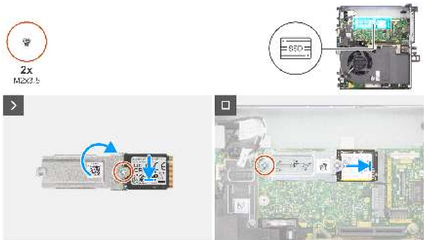
Figure 21. Installation du disque SSD M.2 2230 (logement 2)
