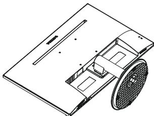
2. Appuyez sur les clips de verrouillage pour détacher le support de la colonne du socle
