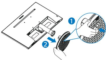
3. Appuyez sur le bouton de détachement pour détacher la colonne de base.
