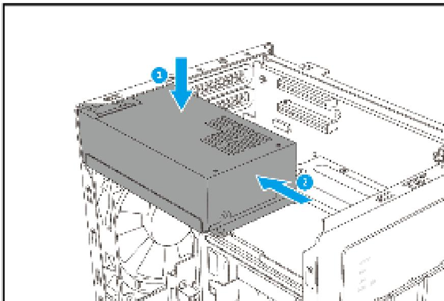
b. Fixez les vis qui sécurisent le bloc au châssis.
