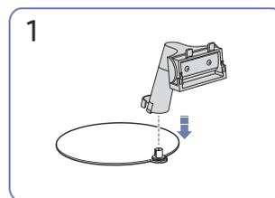
1 Insérez le connecteur du pied dans le pied, dans le sens indiqué sur l'illustration.
