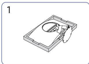
Placez la mousse de polystyrène de protection (coussin) incluse dans l'emballage sur le sol et posez le produit sur la mousse, face orientée vers le bas, comme indiqué sur l'image. En l'absence de mousse de polystyrène, utilisez un tapis épais.
