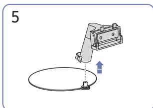
Retirez le col de socle du socle, dans le sens indiqué sur l'illustration.
