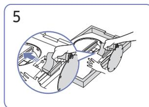
5 Soutenez le corps de l'appareil avec votre main comme le montre l'illustration. Poussez le pied monté dans le corps de l'appareil, dans le sens de la flèche, comme le montre l'illustration.
