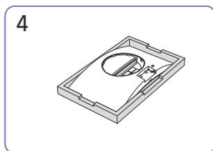
4 Placez la mousse de polystyrène de protection (coussin) incluse dans l'emballage sur le sol et posez le produit sur la mousse, face orientée vers le bas, comme indiqué sur l'image. En l'absence de mousse de polystyrène, utilisez un tapis épais.
