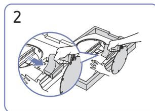
Appuyez sur la partie inférieure du moniteur avec une main et tirez le socle avec l'autre main dans le sens de la flèche comme indiqué sur l'illustration.
