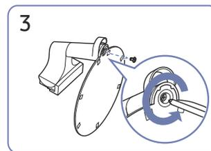
Retirez le connecteur de pied de la base du pied en tournant la vis dans le sens de la flèche, comme le montre l'illustration.
