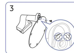
3 Alignez le socle avec le guide du col de socle, puis tournez la vis au bas du socle pour fixer le socle.
