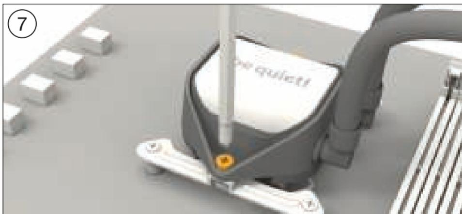
Placez le bloc CPU au centre des supports de montage Intel ou des supports de montage Intel LGA 1700, de sorte que ceux-ci permettent de bien visser le bloc CPU. Pour ce faire, vous pouvez utiliser un tournevis normal. Connectez ensuite la pompe et l'éclairage ARGB au hub PWM ARGB.
