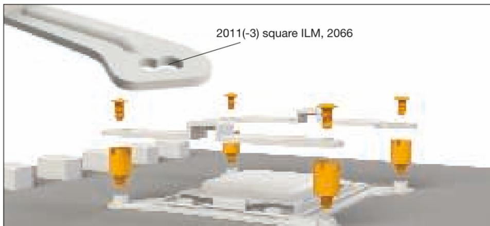
**Assemblage du cadre de montage du ventilateur**
