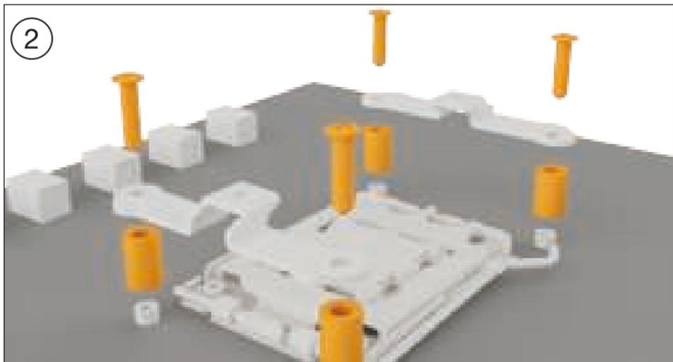
Placez les quatre boulons d'écartement AMD sur les filetages de la plaque arrière, sur la façade avant, et fixez les deux ponts de montage AMD à l'aide des vis de la plaque arrière AMD.
