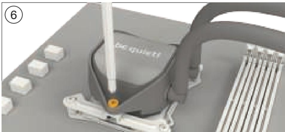
6 Placez le bloc CPU au centre des ponts de montage Intel (4) de manière à ce que ceux-ci permettent de visser le bloc CPU. Vous pouvez utiliser à cet effet un tournevis cruciforme ordinaire. Connectez ensuite la pompe et l'éclairage ARGB au hub PWM ARGB.
