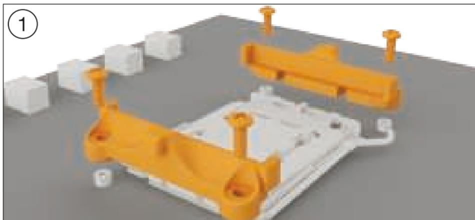
**Assemblage du cadre de montage du ventilateur**
