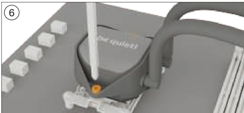
Placez le bloc CPU au centre des ponts de montage Intel de manière à ce que ceux-ci permettent de visser le bloc CPU. Vous pouvez utiliser à cet effet un tournevis cruciforme ordinaire. Connectez ensuite la pompe et l'éclairage ARGB au hub PWM ARGB.
