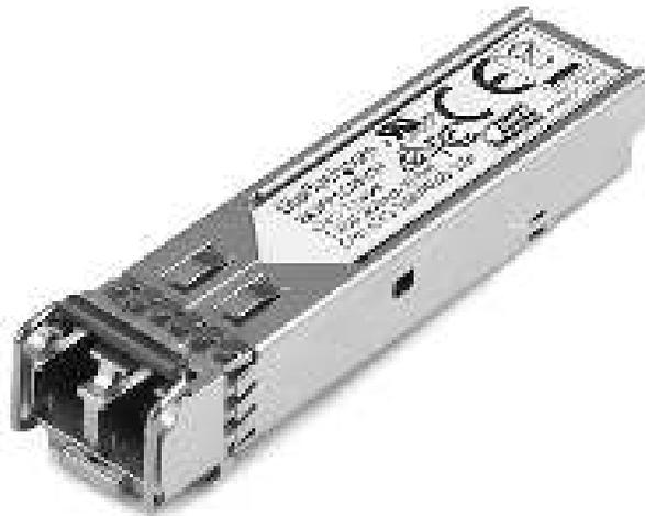
Le modèle EXSFP1GELXST est un module de transceiver à fibre optique compatible avec Juniper EX-SFP-1GE-LX, qui a été conçu, programmé et testé pour fonctionner avec les commutateurs et routeurs de la marque Juniper®. Il fournit une connectivité 1 GbE fiable sur câble à fibre optique pour les réseaux conformes aux spécifications 1000BASE-LX, avec une distance maximale de 10 km.
