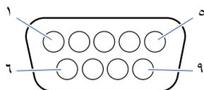
تستخدم الشاشة خطوط RXD و TXD و GND للتحكم عبر RS-232C.
