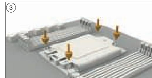
Schrauben Sie die AMD sTRX4 / TR4 Gewindebolzen (2) in den Sockel des Mainboards.
